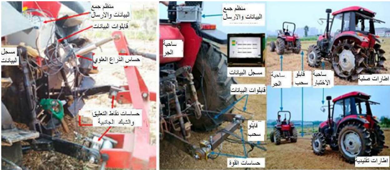
شكل (3-58) استعمال الحاسوب والحساسات في قياس قوى السحب
