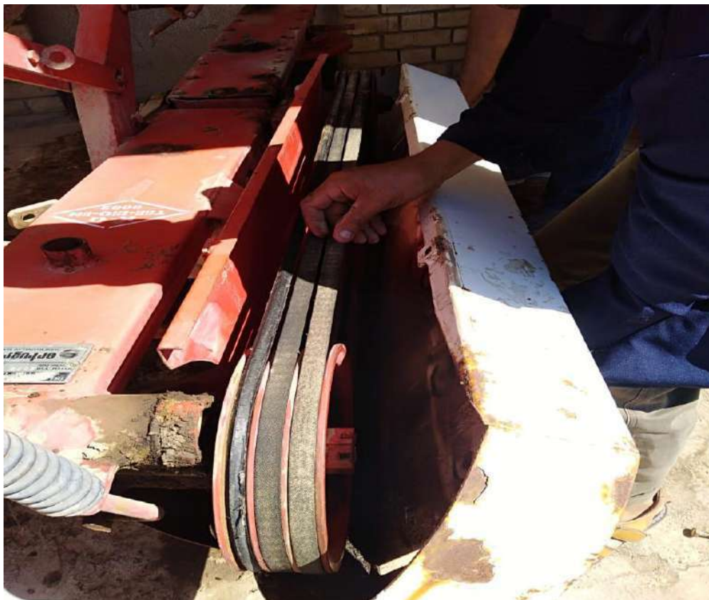
الشكل (4-38) طريقة فحص سيور نقل الحركة واستبدالها
