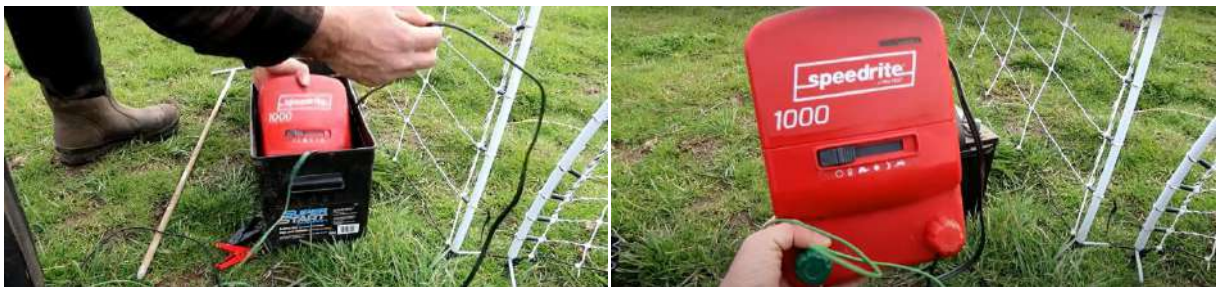
شكل (6-28) تهيئة مولد او منشط الجهد على الجهد والتردد او النبض المطلوب
