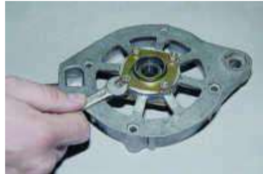
شكل(1-70) فتح براغي تثبيت كراسي المولد
