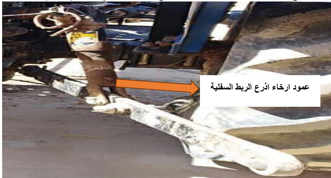
الشكل (4-31) طريقة ارخاء اذرع الربط السفلية لتسهيل عملية الربط
