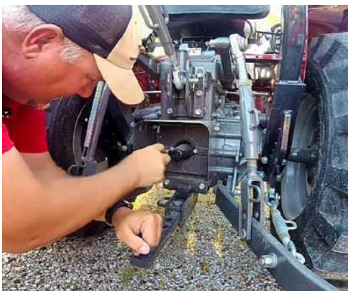
الشكل (2-40) تهيئة وتجهيز عمود P.T.O
