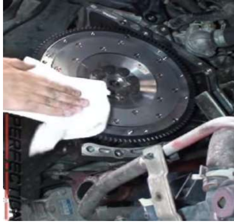
شكل (7-2) عدم وصول أي زيوت أو شحوم الى الفاصل
