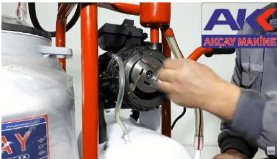
شكل(5-35) تحريك الجزء الدوار للتأكد من انزلاق الالواح
