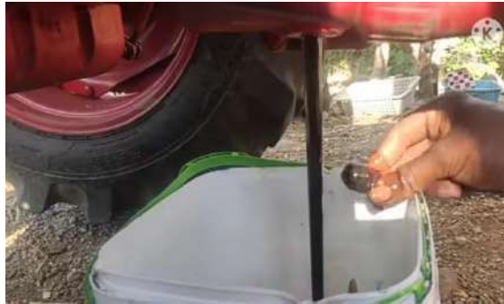
شكل (2-11) تفريغ الزيت من صندوق التروس
