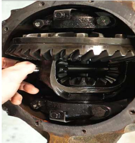
شكل(2-31) فتح الشفتات الجانبين واستخراجها يكون الصندوق التفاضلي
