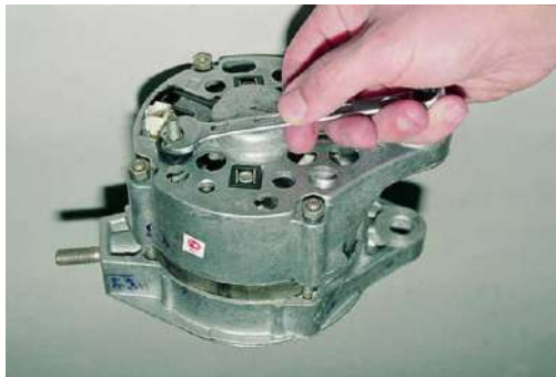
شكل(1-65) فتح صامولة تثبيت منظم الفولت
