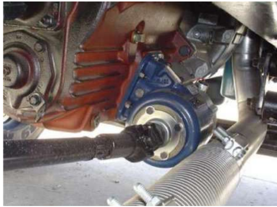
الشكل (2-38) عمود الإدارة الخلفي ( P.T. O ) بعد اتصاله بالوصلة المرنة
