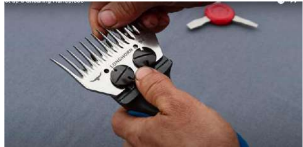
شكل(5-49) تثبيت المشط الخلفي بصوره افقيه مع ترك مسافه قليله عن القاعدة
