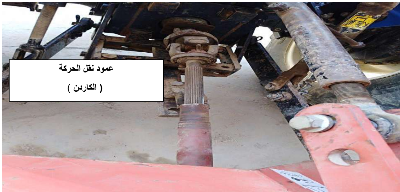
الشكل (37-4) طريقة ربط المحشة بالساحبة الزراعية عن طريق عمود نقل الحركة
