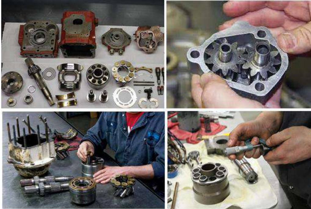
شكل (3-10) تفكيك انواع من المضخات واستبدال الاجزاء التالفة.
