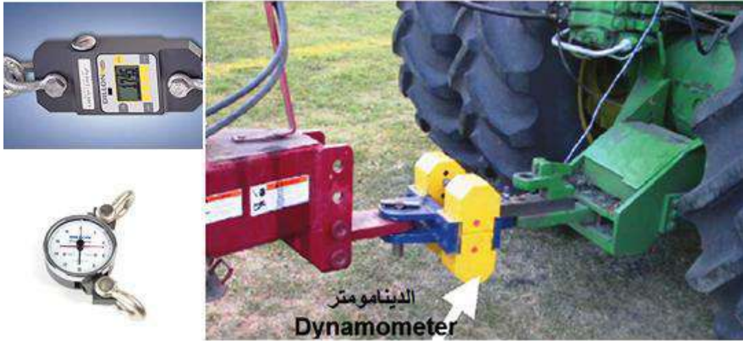
شكل (3-52) طريقة تركيب جهاز الدينامومتر مباشرة بين الساحبة والمحراث لقياس قوى السحب
