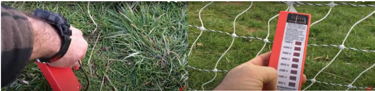
شكل (40-6) وضع أحد اقطاب جهاز قياس الجهد بالسياج
