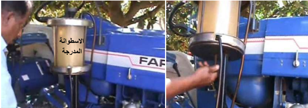
شكل (1-2) تثبيت الاسطوانة المدرجة على الساحة الزراعية
