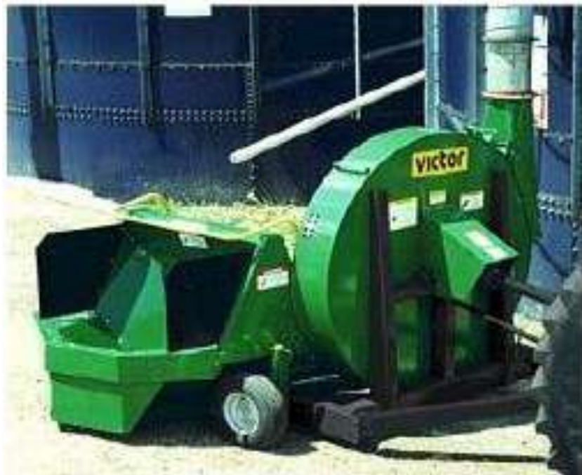
شكل (5-8) نافخة اعلاف مربوطة بجرار زراعي
