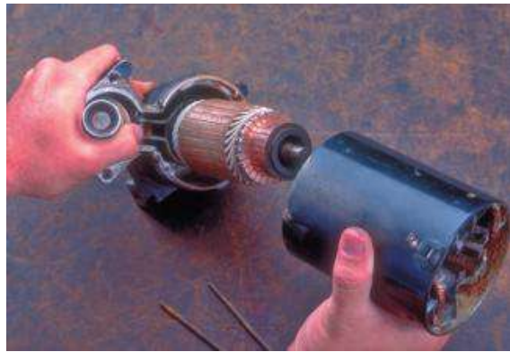
شكل (51-1) فك قاعدة الفرش الكربونية شكل (52-1) ارفع جسم الملف
