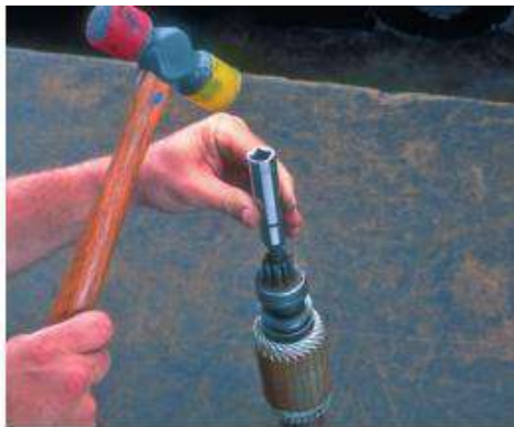
شكل (54-1) وضع عضو الإنتاج لإخراج الترس
