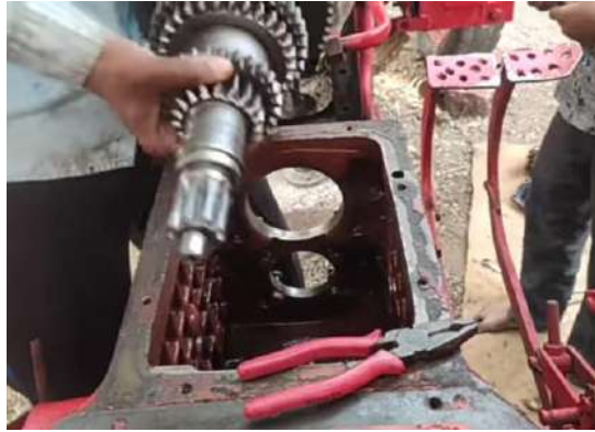
شكل (2- 16) يمثل خطوات استخراج الأعمدة
