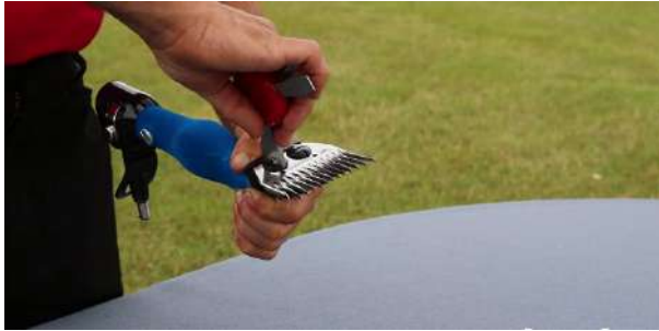
شكل (56-5) احكام غلق البراغي الماسكة للمشط الخلفي بواسطة المفك
