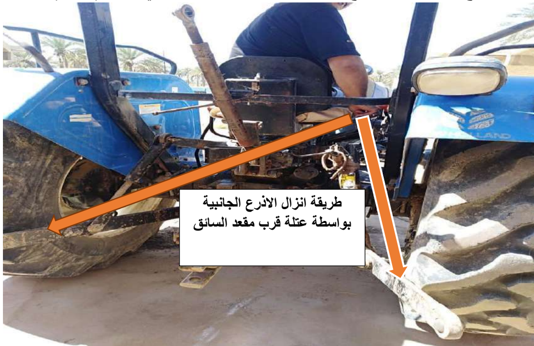
الشكل (4-32) طريقة انزال الازرع الجانبية حتى تصبح بمستوى نقاط ربط المحشة
