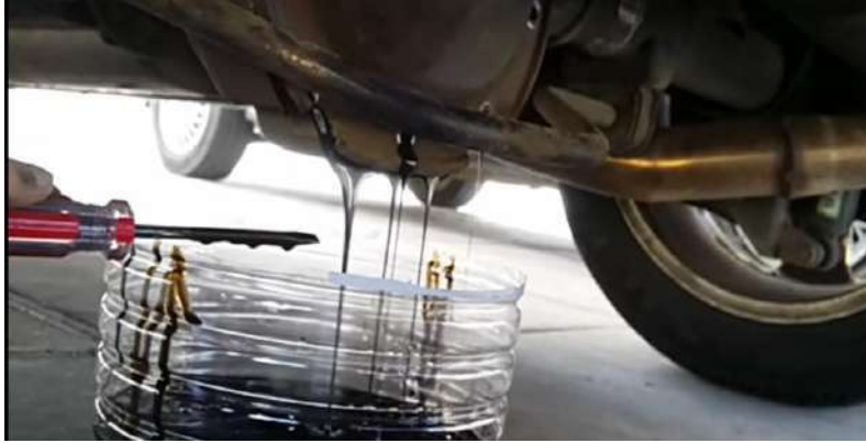
الشكل (2-30) تفريغ الزيت الموجود داخل جهاز الفرقي
