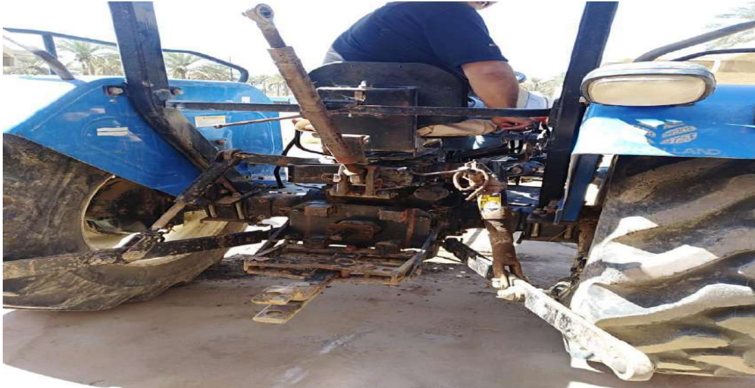
الشكل (4-30) طريقة ارجاع الساحبة لربط المحشّة
