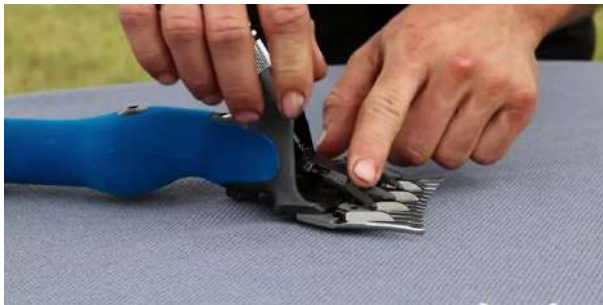
شكل(5-52) الضغط يدوياً على شوكة الحركة مع ضبط صامولة الضغط بصوره بسيطة
