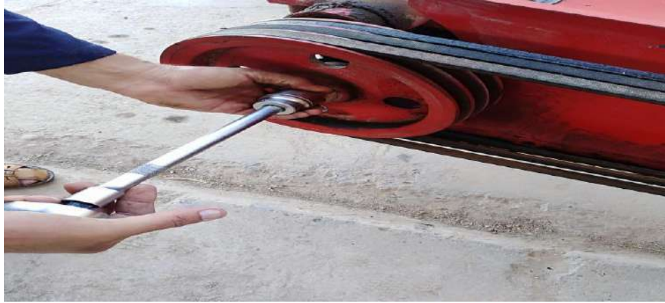
الشكل (4-39) طريقة فحص كراسي تحميل البكرات واستبدالها
