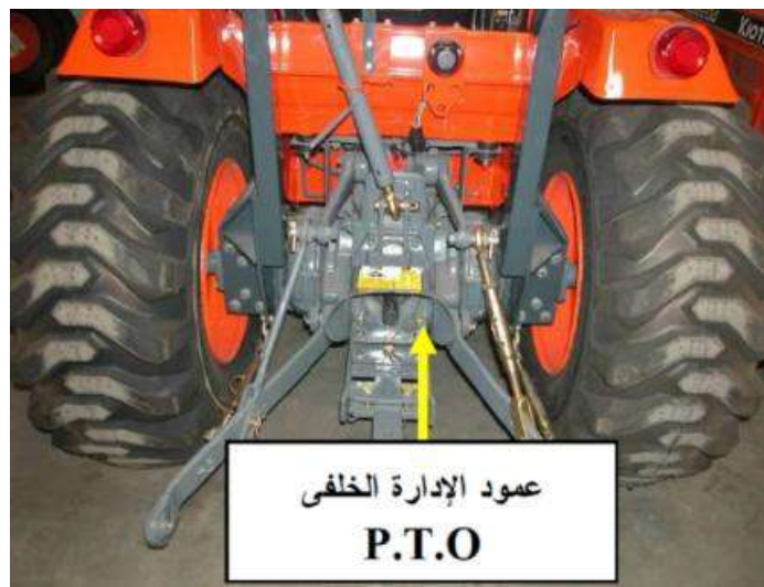
الشكل (2-36) عمود مأخذ القدرة (PTO)
