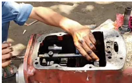
شكل (23-2) ارجاع المجموعة التي يتم من خلالها تبديل السرعة
