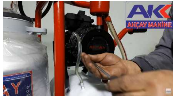
شكل (5-38) إعادة غلق غطاء المضخة
