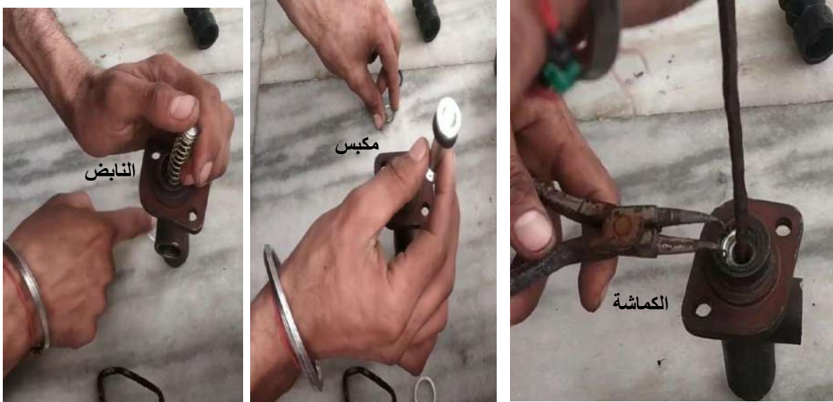
شكل (1-30) رفع حلقة حصر المكبس من جسم الاسطوانة الرئيسية للموقف
