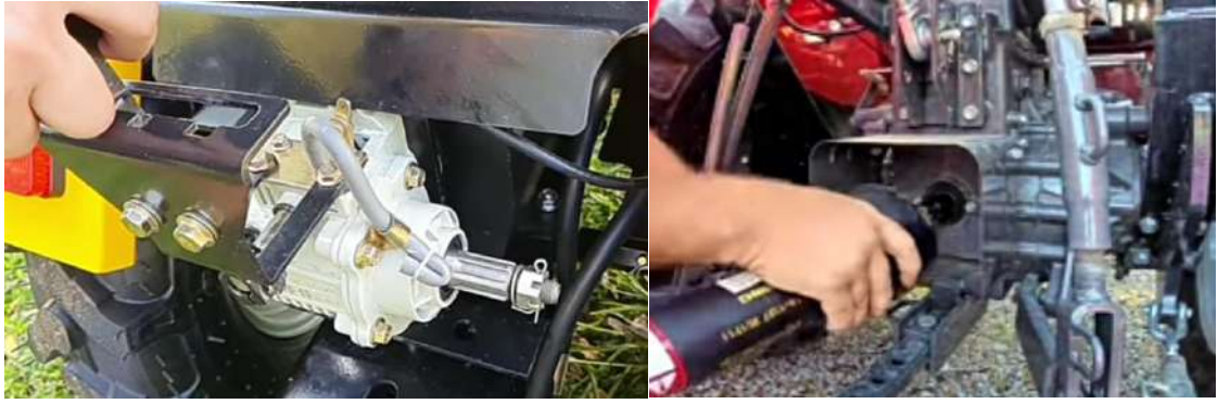
الشكل (2-43) اختبار بعد ربطه مع عمود الإدارة الخلفي
