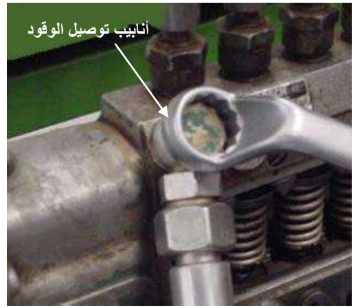
شكل (12-1) ربط أنابيب توصيل الوقود
