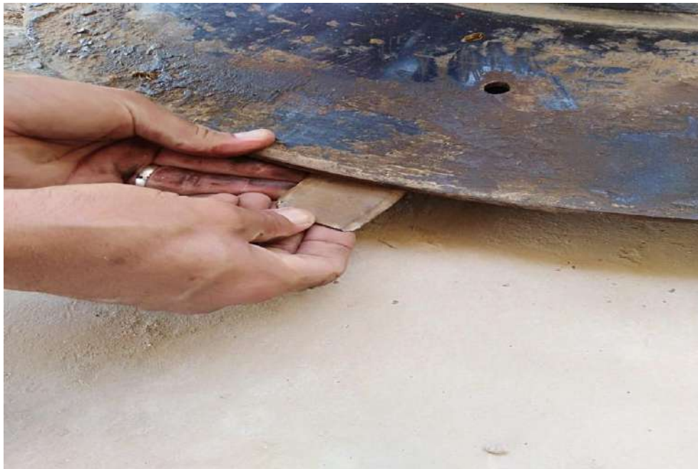
الشكل (4-40) طريقة فحص الشفرات واستبدالها
