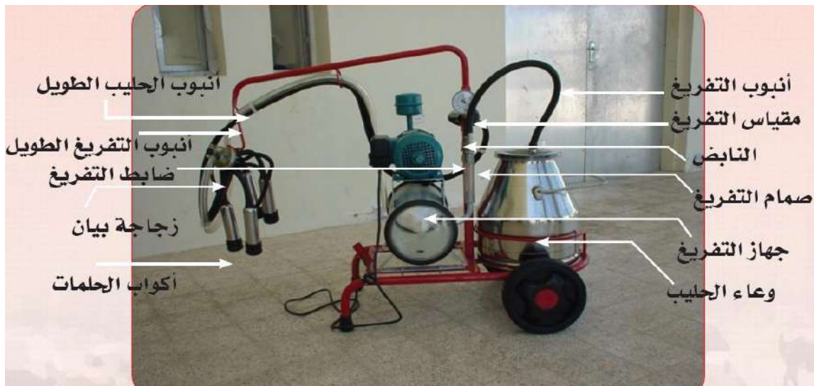
شكل(5-9) ماكينة الحلابة الفردية المتنقلة
