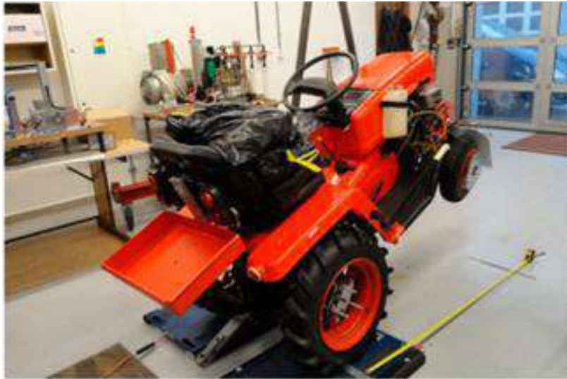
شكل (3-72) تعليق المحور الامامي بغرض تحديد ارتفاع مركز الثقل
