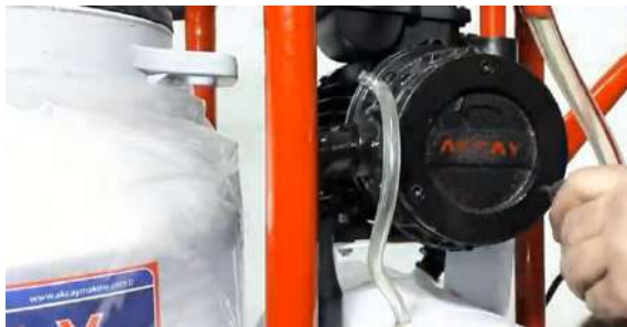
شكل (5-29) فتح براغي غطاء المضخة
