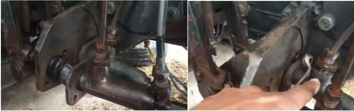
شكل (28-1) فتح صواميل تثبيت الاسطوانة الرئيسية للموقف من جسم الساحة
