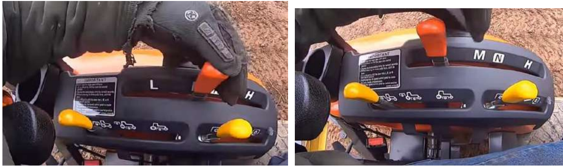
الشكل (2-44) تشغيل الجهاز الهيدروليكي
