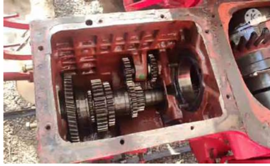
الشكل (21-2) ارجاع الأعمدة التي تحمل التروس
