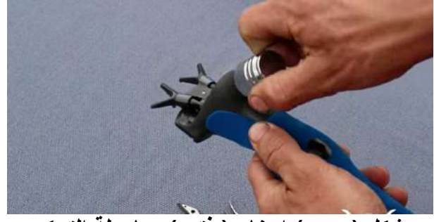
شكل (5-47) أرخاء ( فتح ) صامولة التحكم بضغط المشط الأمامي
