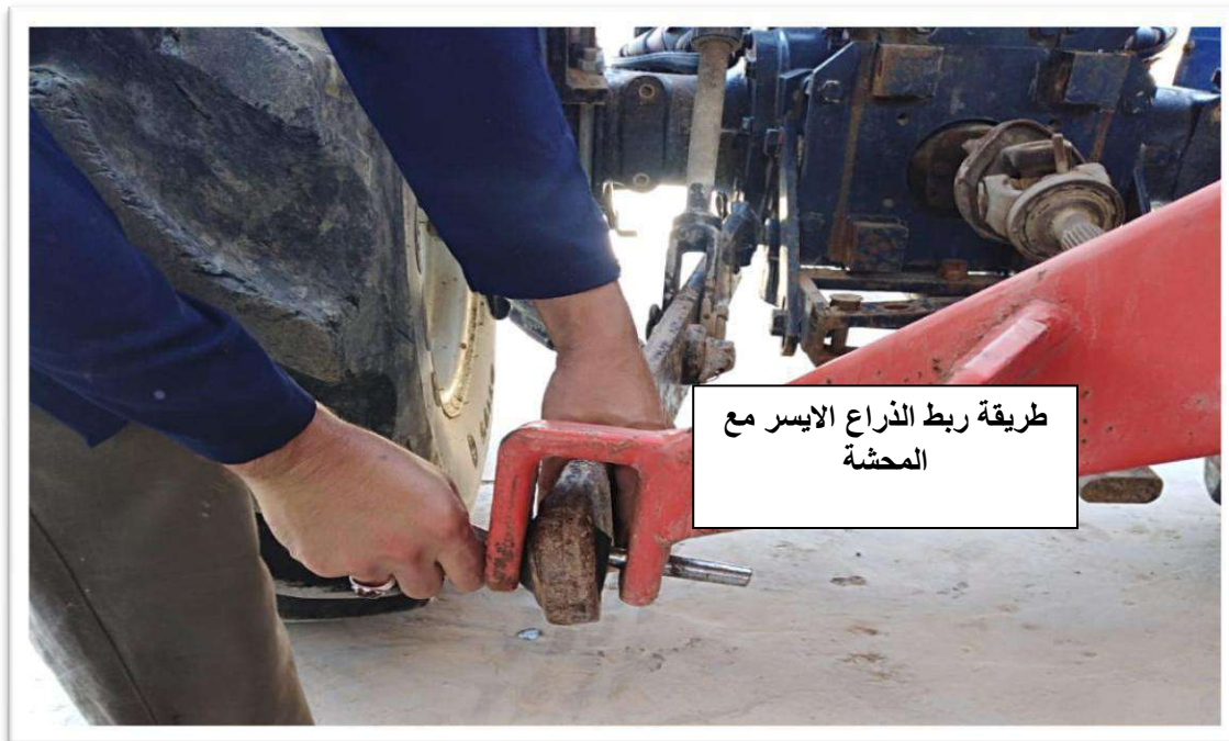
الشكل (4-33) طريقة ربط الذراع الايسر مع المحشة
