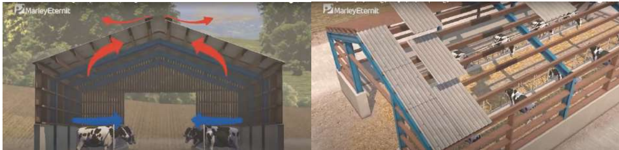
شكل (19-6) تثبيت الأعمدة الحديدية لتحديد أماكن البقر ومد أنابيب المياه
