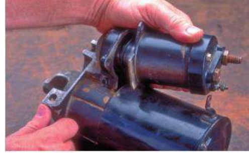
شكل (49-1) فتح براغي تثبيت للمفتاح المغناطيسي شكل (50-1) فتح الغطاء الخلفي
