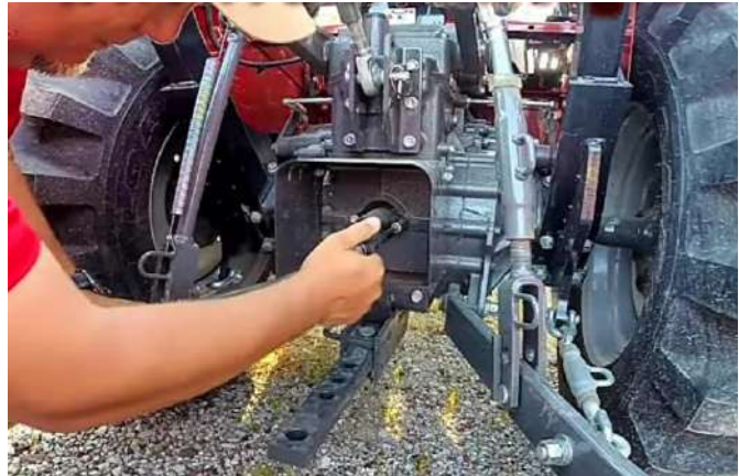
الشكل (2-40) تهيئة وتجهيز عمود P.T.O
