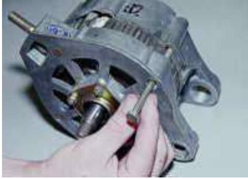
شكل(1-67) أخراج براغي التثبيت
