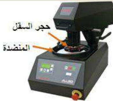
تصقل المشغولات التي سبق تجليخها في ماكينات التجليخ، بواسطة ماكينات الصقل والتنعيم لغرض تصحيح سطوحها وجعلها أكثر نعومة، إذ إن دقة التجليخ هذا النوع من الماكينات تصل الى (0.05mm-) (0.03mm)، في عمليات الصقل تكون سرعة القطع منخفضة، والضغط على المشغولة قليل، لهذا فإن الحرارة المتولدة عن الصقل تكون قليلة.
