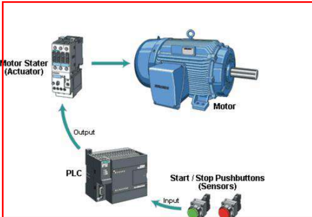
الشكل (3-48) الأجزاء المستعملة مع المتحكم لتشغيل المحرك
