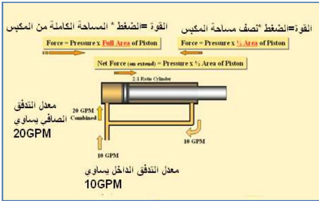
شكل (13-1) الأسطوانة التفاضلية
