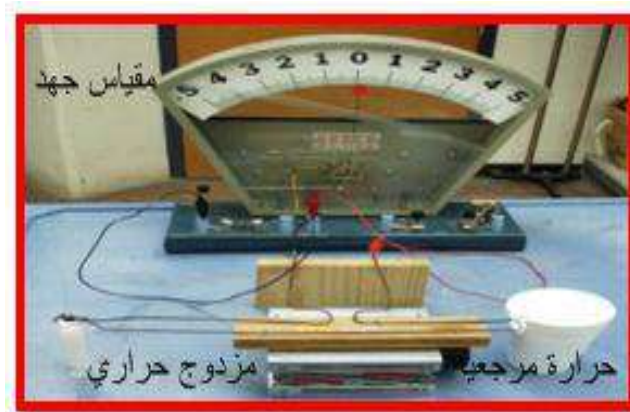
شكل رقم (9-1) دائرة تبين كيفية فحص محول المزدوج الحراري
