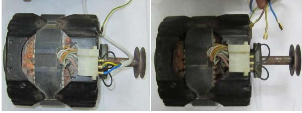
شكل (55-7) توصيل الأطراف الخارجية لمحرك (3 \phi ) حثي قفص سنجابي نجمي (ستار)
