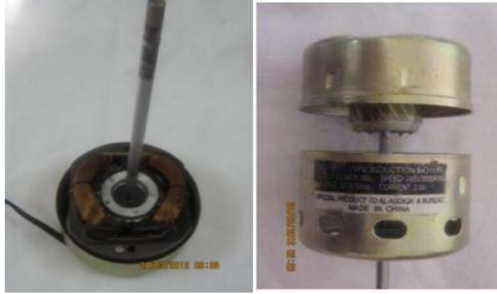
شكل (6 - 42) يوضح فحص صلاحية البوش بتدوير شفت المحرك في البوشه يدويا
