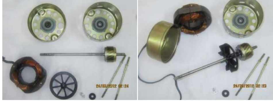
شكل (6 - 40) طريقة تفكيك محرك الأقطاب المظللة (مضخة الماء للمبردة )
