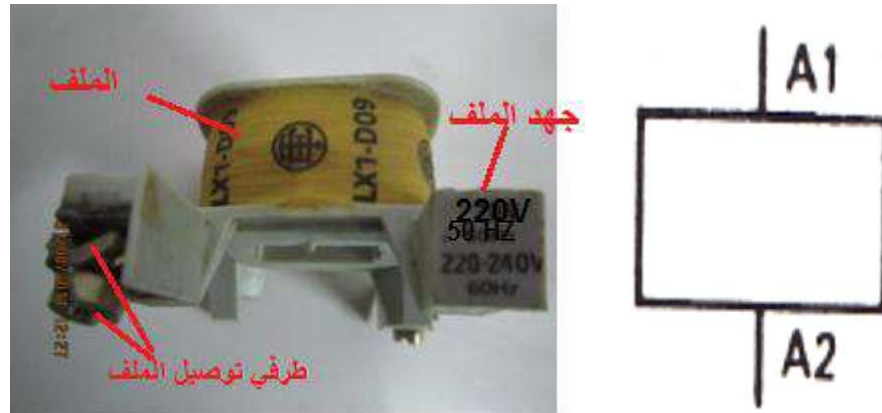
شكل (7-11) يوضح شكل ملف الكونتكتر ورمزه
