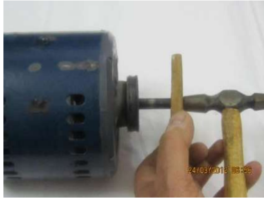
شكل (6-29) يوضح الطرق على شفت المحرك بفاصل خشبي بعناية لفصل الأغطية
