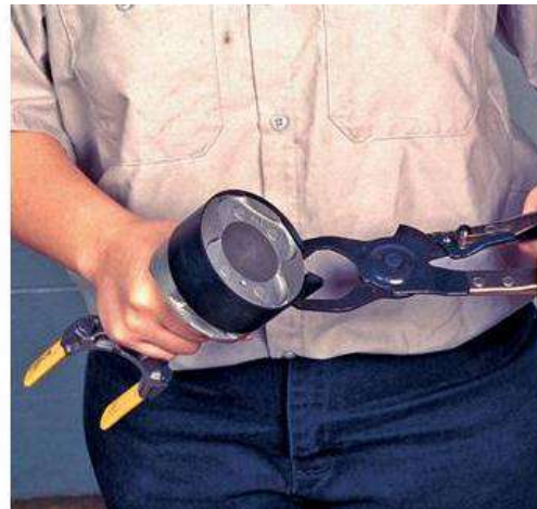
شكل (3-19) يوضح استعمال الزيت على الحلقات وضغطها (بقفص الرنكات)
