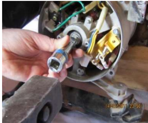
شكل (8 - 48) الطرق على اللولب الماسك لرأس التوليد بعد فتحه
