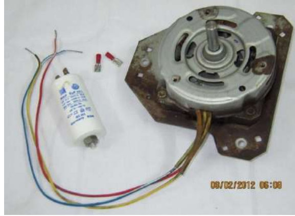
شكل (7-52) يوضح (أ) محرك غسالة حثي قفص سنجابي ( \phi 1 ) يعمل بمتسعة بدء دوران وملفات مساعدة
