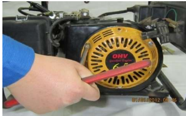
شكل (8- 62) يوضح فتح غطاء عتلة بدء تدوير المحرك
