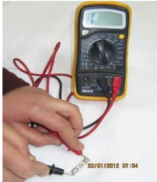
شكل (8-73) طريقة فحص الفاصم (الفاصم تالف)
