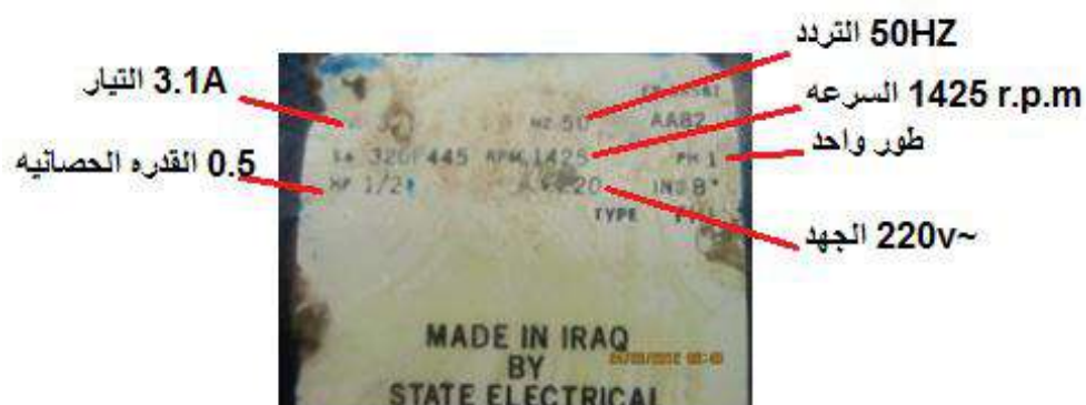
شكل (6-27) يوضح لوحة التسمية لمحرك حثي أحادي الطور (محرك مبردة الهواء)
