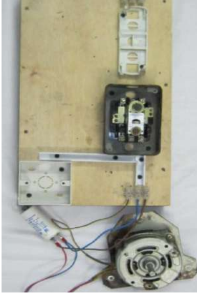
شكل (57-7) تثبيت صناديق والقنوات البلاستيكية على اللوحة الخشبية
