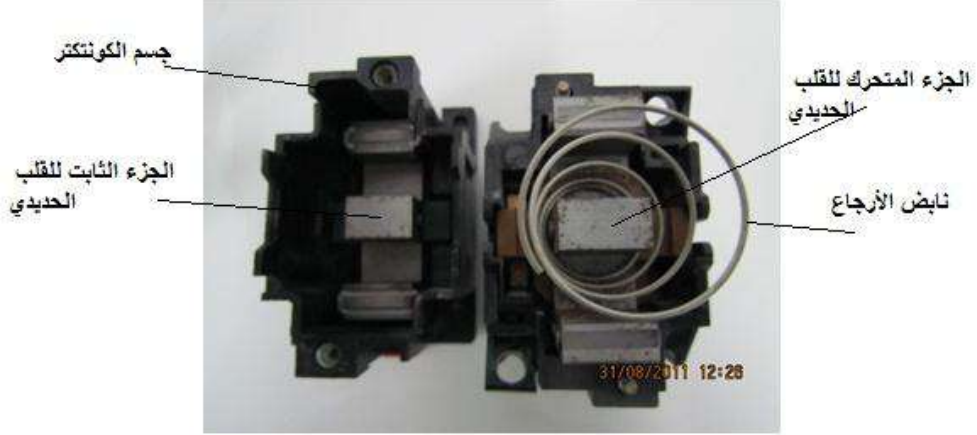
شكل ( 7-12) أجزاء القلب المغناطيسي للكونتكتور
