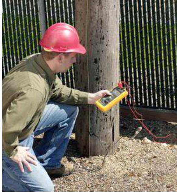
شكل (4-9) يبين كيفية قياس مقاومة الأرضي
