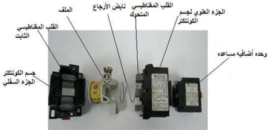
شكل (7-17) يوضح كونتكتر مفكك ويبين أجزائه الداخلية ومنها جسمه
