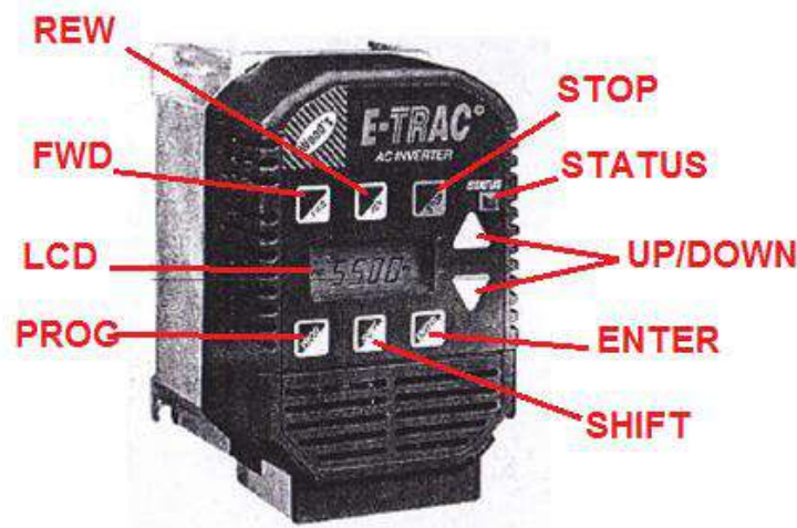
شكل (8-13) يوضح جهاز العاكس مع مفاتيح لوحة التحكم الرقمية له
