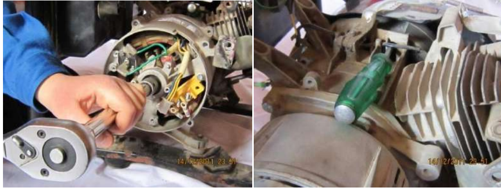
شكل (8- 47) وضع المفك في الفتحة لمنع المحرك من الدوران مع فك برغي التثبيت لرأس التوليد
