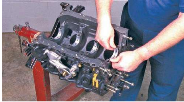
شكل (3-16) يوضح تثبيت قطع المساند (البيرنك)
