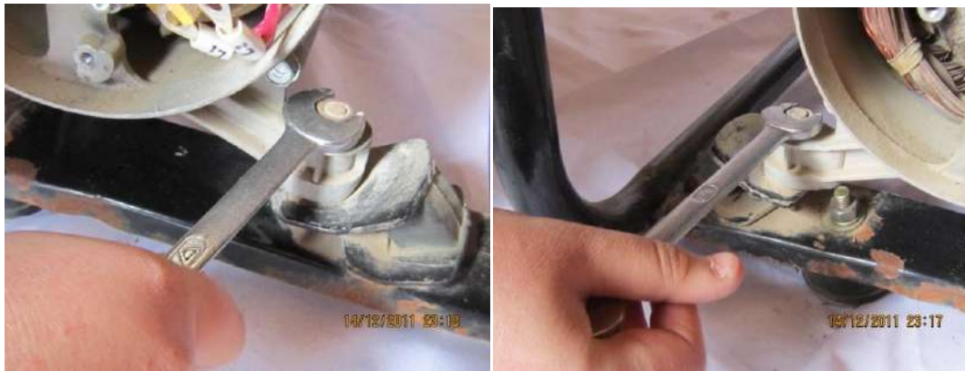
شكل (8-43) يوضح فك صواميل تثبيت دكتي رأس التوليد بهيكل المولد
