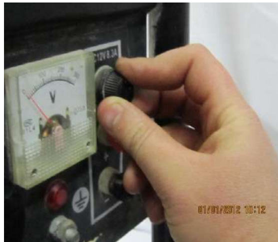
شكل (8-71) يوضح فتح الغلاف البلاستيكي للفاصم
