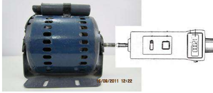
شكل (7-37) يوضح طريقة قياس سرعة المحرك باستخدام مقياس السرعة الرقمي الميكانيكي
