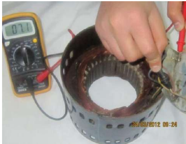
شكل (6-32) يوضح قياس قيمة مقاومة الملفات الرئيسية التي تساوي (7.1) أوم
