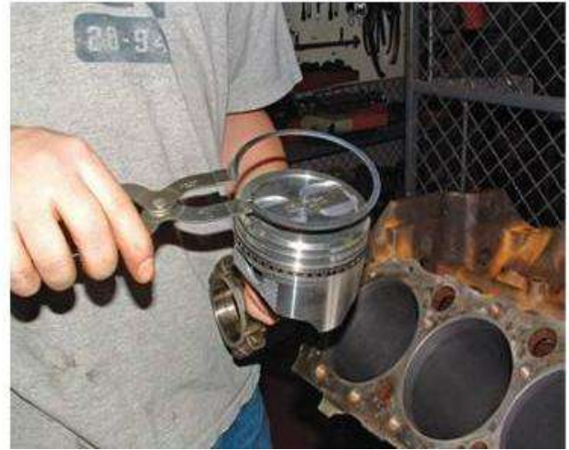
شكل (3-18) يوضح التأكد من الخلوص في حلقة المكبس وتركيبها في مكانها
