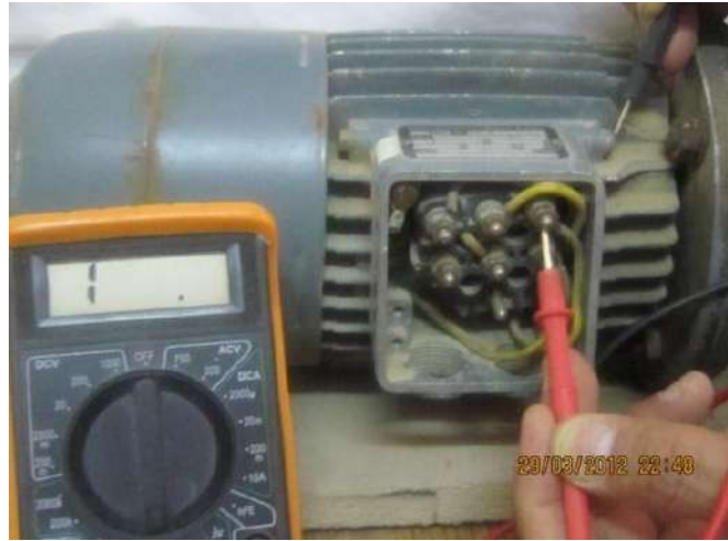
قراءة جهاز الأوميتر تساوي مالاتهايه بين الملف والشاصي (W 1 -W 2 )
