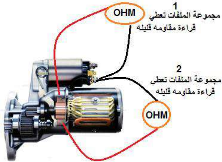
شكل (6 - 22) يوضح فحص صلاحية ملفات الجزء الثابت بواسطة الأوميتر
