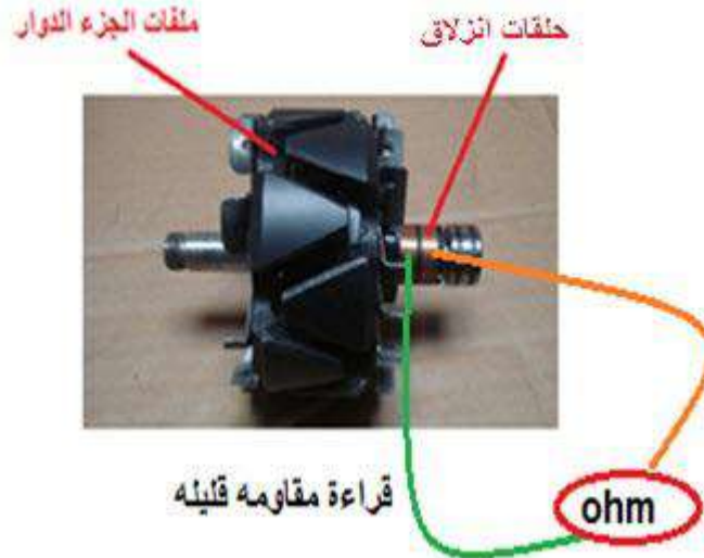
شكل (6- 12) يوضح فحص صلاحية مفلات المنتج
