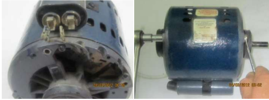
شكل (6-28) يوضح طريقة فتح براغي الأغطية الجانبية وفصل أطراف متسعة البدء
