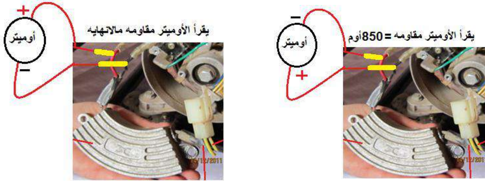
فحص المقاومة الأومية بين أطراف التوصيل الى الفحمت و (AVR)
