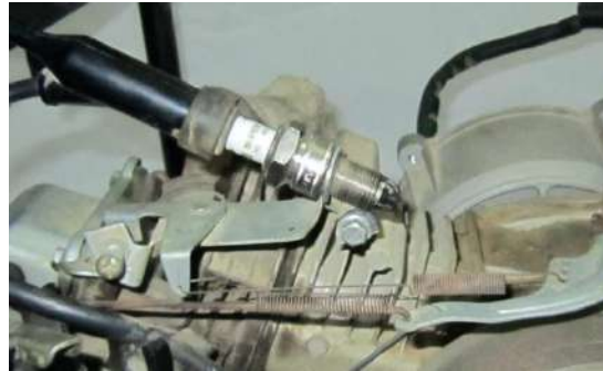
شكل (8 - 68) يوضح شمعة القدح ملاصقة للجسم المعدني للمحرك
