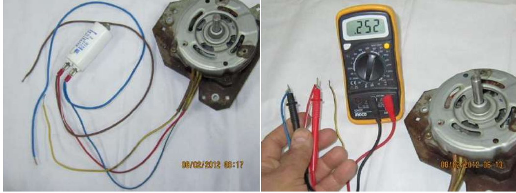
شكل (د) طريقة قياس قيمة المقاومة الكلية لملفات محرك غسالة تقريبا وتساوي (252) أوم شكل (7-53) توصيل المتسعة مع ملفات محرك الغسالة
