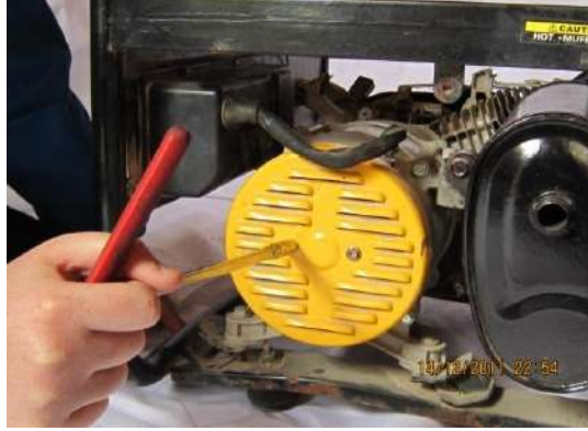
شكل (8-30) يوضح فتح لوالب غطاء رأس التوليد بمفك رقم (8mm)
