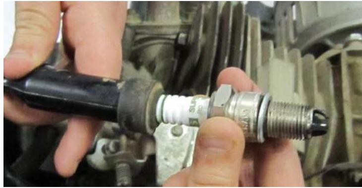
شكل (8-67) يوضح أرجاع شمعة القدح داخل غلاف التوصيل
