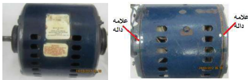
شكل (6-26) محرك حثي أحادي الطور قفص سنجابي مع لوحة التسمية والعلامات
