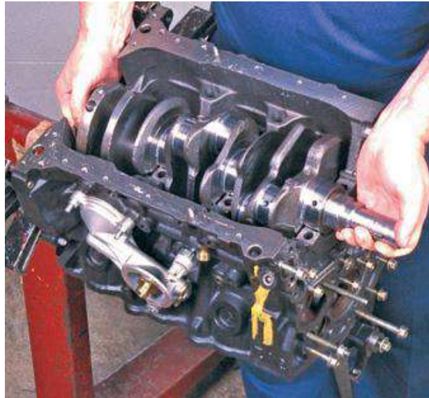
شكل (3-10) يوضح فتح وإخراج العمود المرفق
