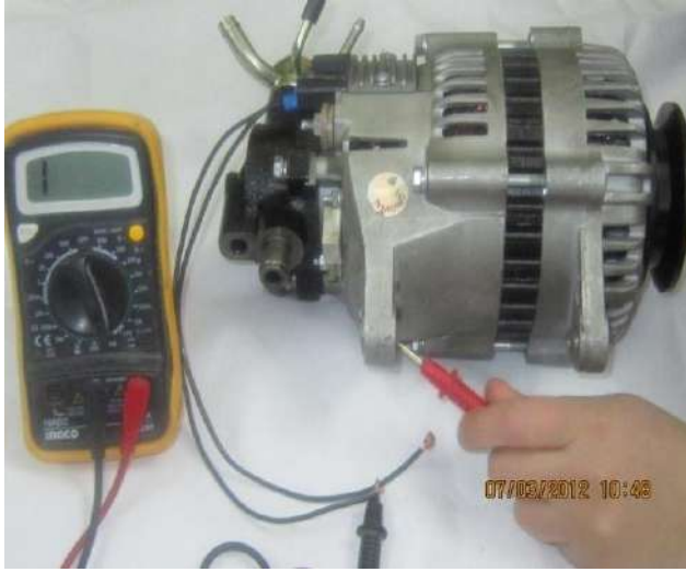
شكل (6- 13) يوضح طريقة فحص منظم الشحن الداخلي للداينمو
