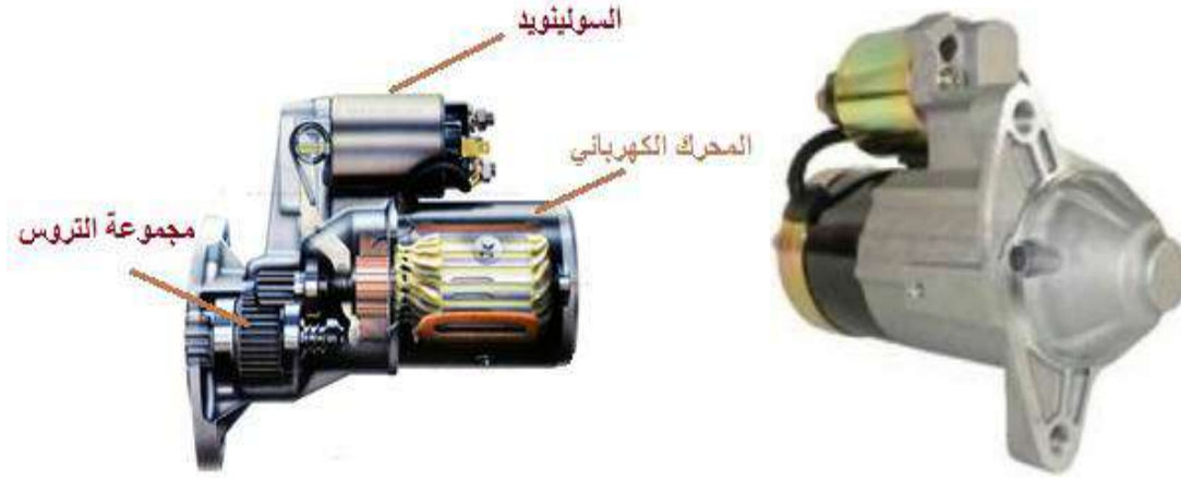
شكل (6-15) يوضح شكل بادئ تشغيل محرك السيارة (السلف)
