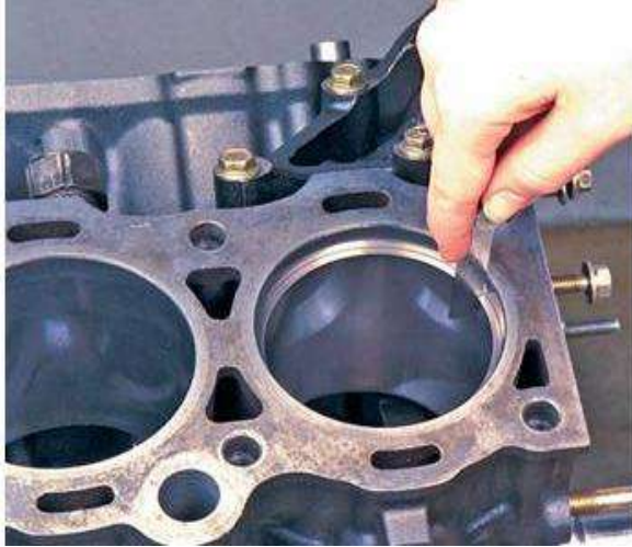
شكل (3-18) يوضح التأكد من الخلوص في حلقة المكبس وتركيبها في مكانها
