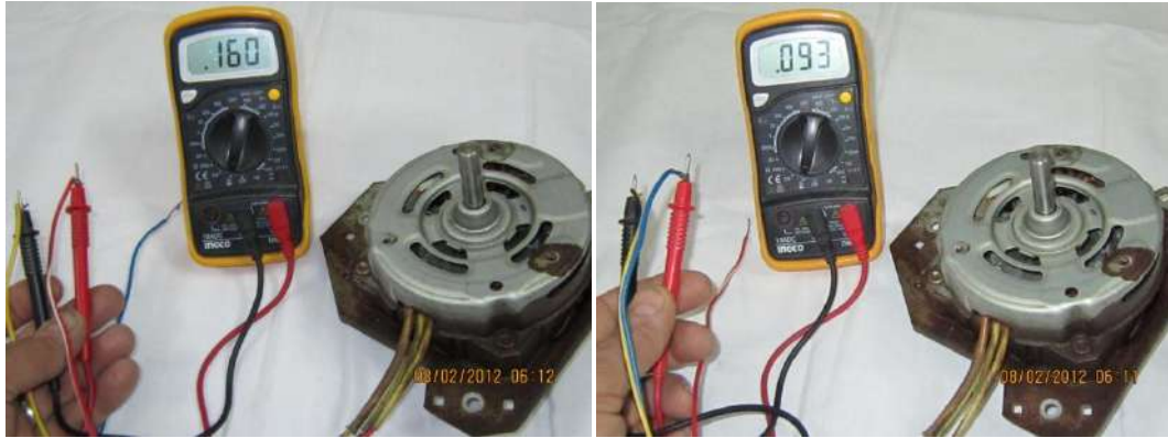
شكل (ب) طريقة قياس مقاومة الملفات الرئيسية شكل (ج) طريقة قياس قيمة الملفات المساعدة
