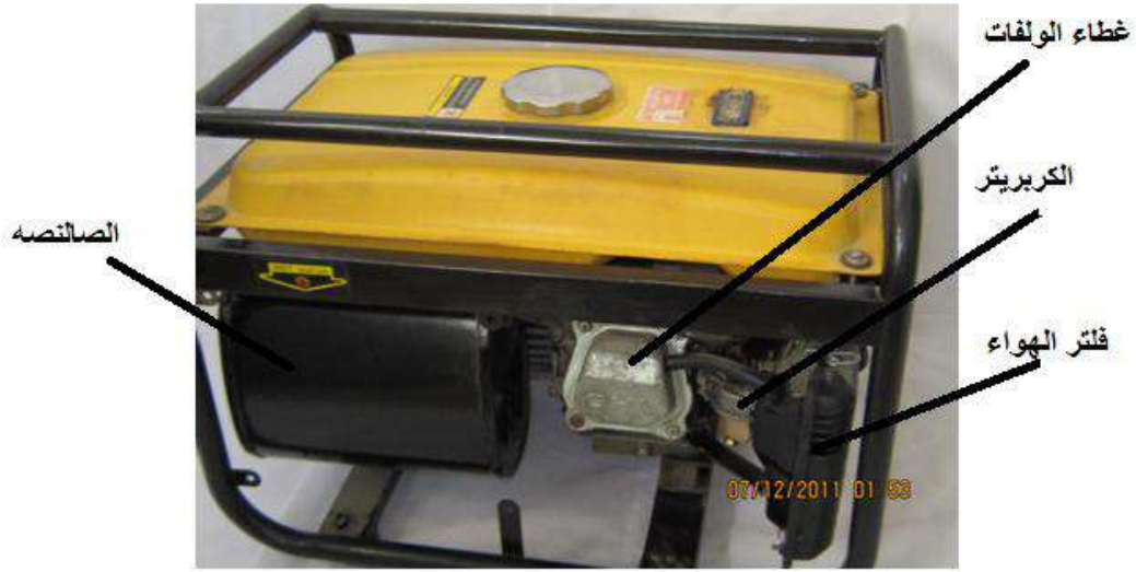
شكل (8-19) يوضح الأجزاء والمنظر الأمامي والخلفي لمولد (2.5 KVA)
