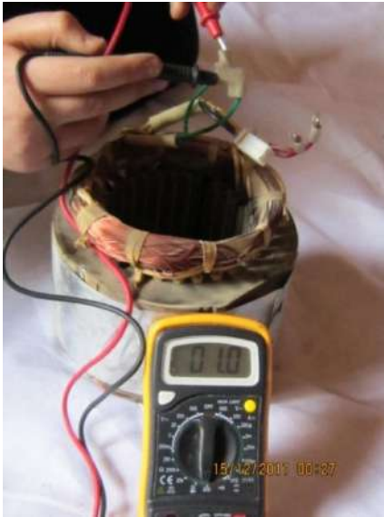
شكل (8-52) فحص مقاومة ملفات التوليد شكل (8-53) فحص مقاومة ملفات الشحن الرئيسية ( 3.4\Omega ) بواسطة جهاز الافوميتر الثانوية ( 1\Omega ) بواسطة جهاز الافوميتر
