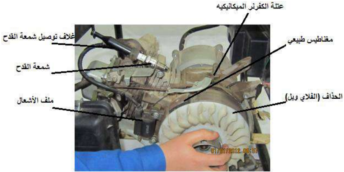
شكل (8 - 69) يوضح تدوير حذاف المحرك الميكانيكي لفحص دائرة الاشغال
