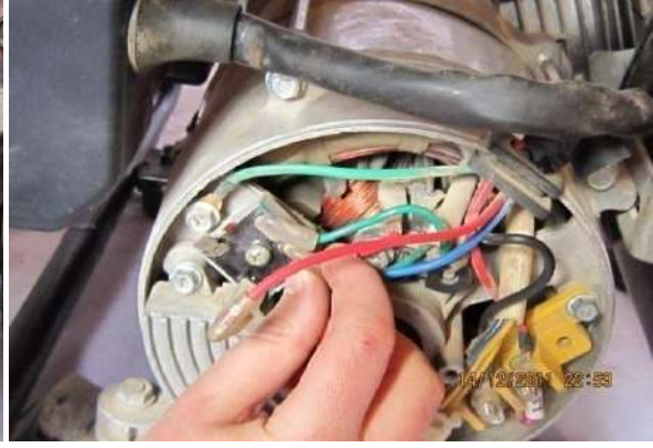
شكل (8-32) أبعاد أسلاك القنطرة الجسرية شكل (8-33) فك مرابط ملف التوليد (220V)
