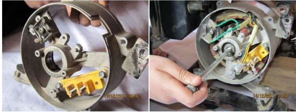
شكل ( 8-50 ) يوضح أبعاد الغطاء الخلفي الحامل لبولبرن الجزء الدوار لرأس التوليد
