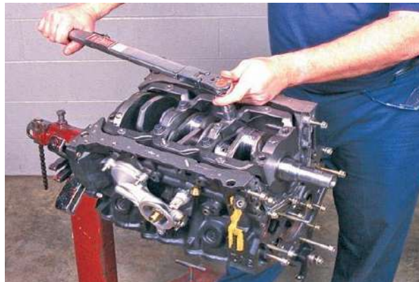
شكل (3-17) يوضح شد عمود المرفق
