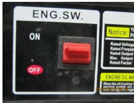
شكل (8 - 65) يوضح مفتاح التشغيل بوضع (ON)
