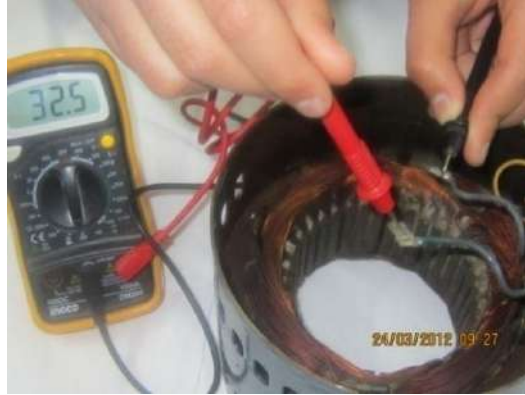
شكل (6- 34) يوضح قياس قيمة المقاومة الكلية للملفات الرئيسية والمساعدة وتساوي (32.5) أوم
