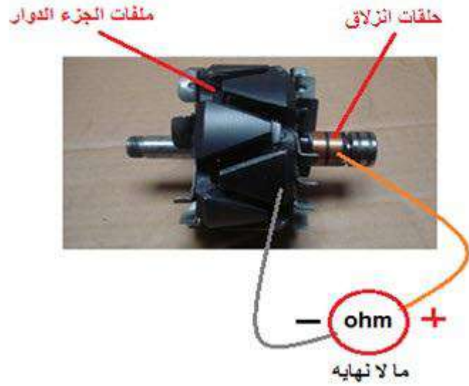
شكل (6- 11) يوضح طريقة فحص عدم وجود تسريب في المنتج
