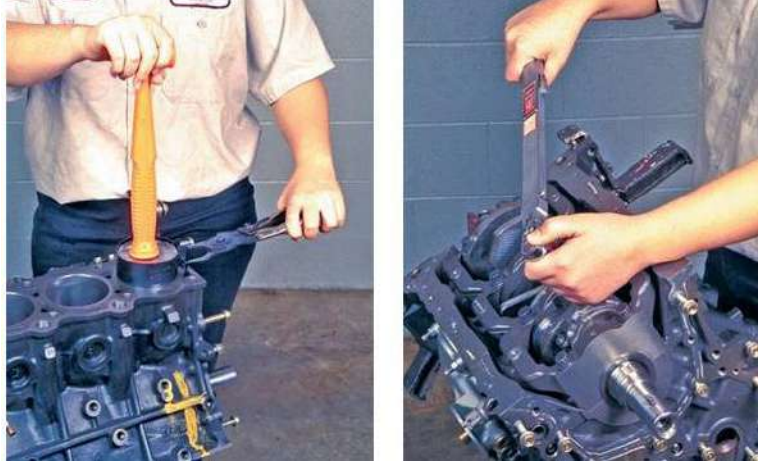
شكل (3- 20) يوضح أنزال المكبس من الأعلى بالطرق الخفيف ، ثم يقلب المحرك ويربط الذراع في عمود المرفق باستعمال ذراع راجز عزم بحسب تعليمات الشركة المصنعة
