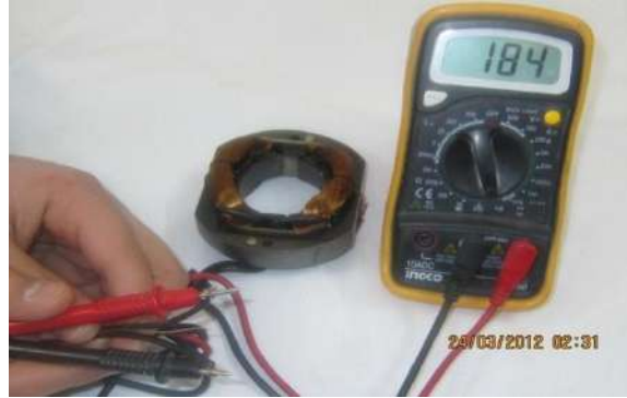
شكل (6 - 41) فحص قيمة مقاومة الملفات تساوي تقريبا (184) أوم
