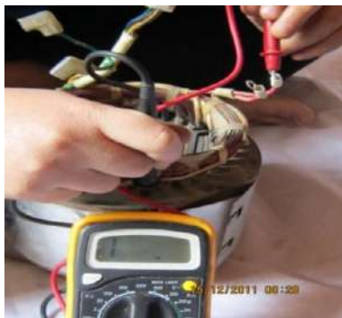
شكل (8-54) فحص مقاومة ملفات الإثارة شكل (8-55) فحص عازلية الملفات عن هيكل الذاتية رأس التوليد
