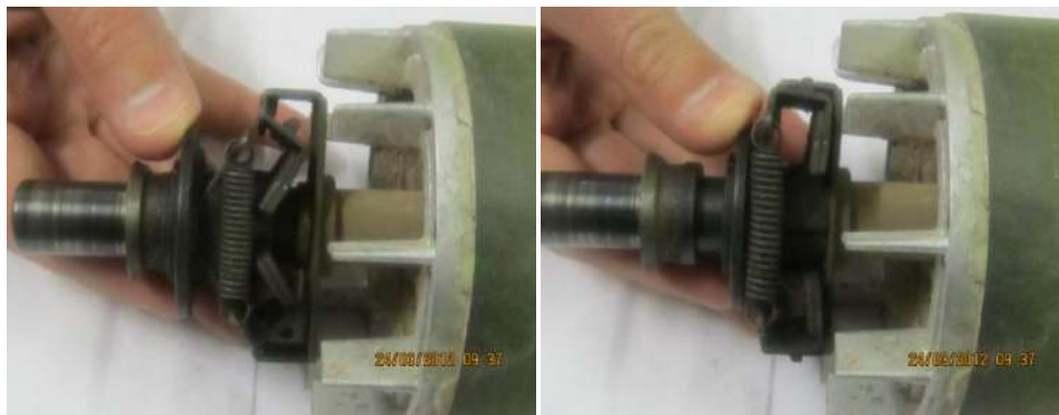
شكل (6 - 35) يوضح طريقة فحص نوابض مفتاح الطرد المركزي
