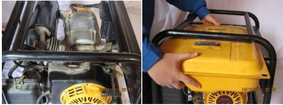
شكل (8-29) أبعاد خزان الوقود من المولد المنزلي لأجراء خطوات فك رأس التوليد
