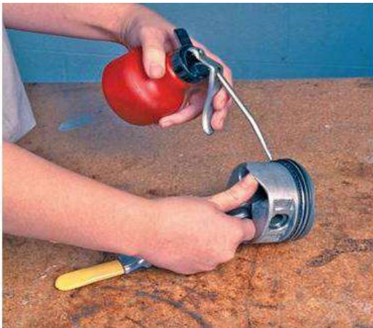
شكل (3-19) يوضح استعمال الزيت على الحلقات وضغطها (بقفص الرنكات)
