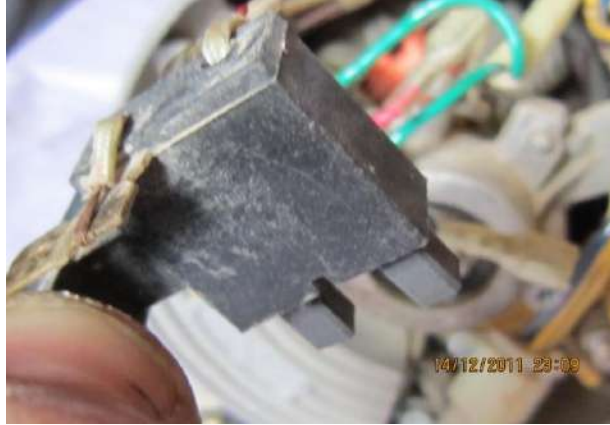
شكل (8- 38) أبعاد ماسك مجموعة الفحمت من رأس التوليد
