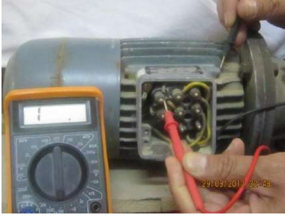
قراءة جهاز الأوميتر تساوي مالاتهايه بين الملف والشاصي (V 1 -V 2 )
