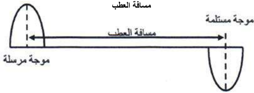
شكل (5-8) الموجة المستلمة والظاهرة على شاشة جهاز الأوسيلوسكوب لتحديد مكان عطب القابلو
