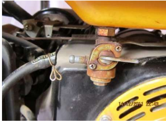
شكل (8-27) يوضح أبعاد أنبوبة الوقود من صمام الوقود بعد غلقه
