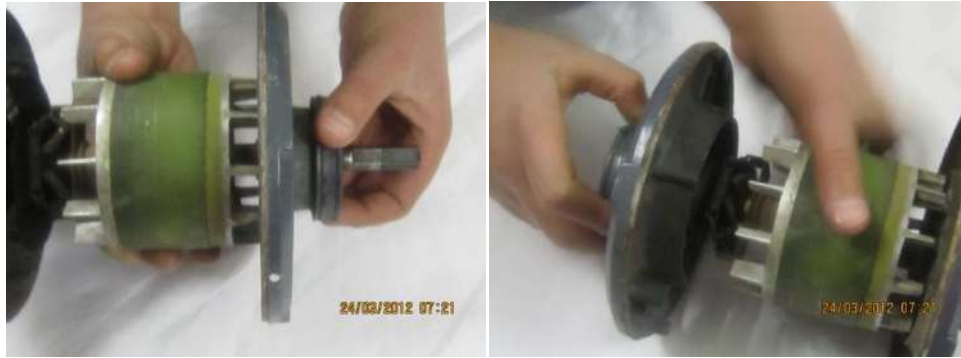
شكل (6 - 31) يوضح كيفية فحص صلاحية البوش وشففت المحرك
