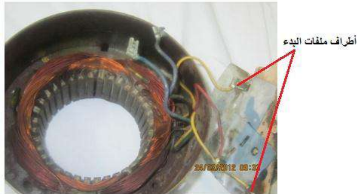
شكل (6-37) يوضح طريقة عكس أطراف ملفات البدء لعكس أتجاه دوران المحرك الحثي الاحادي الطور
