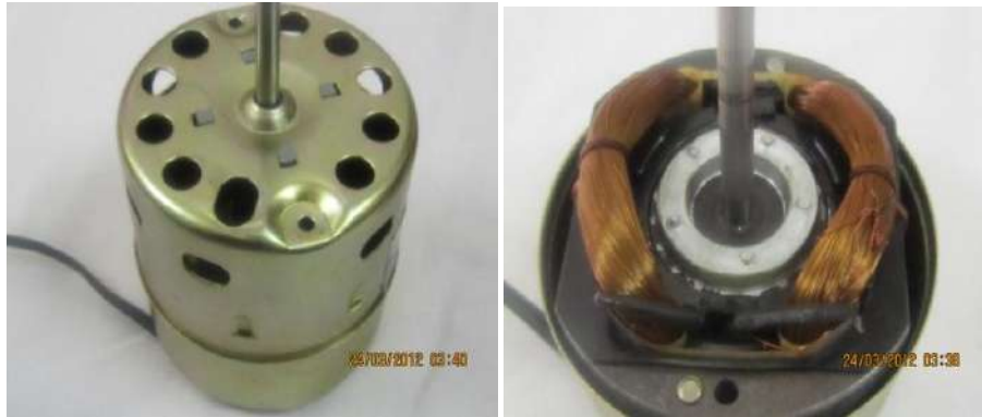
شكل (6-43) يوضح طريقة عكس اتجاه دوران محرك مضخة ماء لمبردة الهواء من خلال قلب الجزء الساكن للمحرك بزاوية ( 180^\circ )
