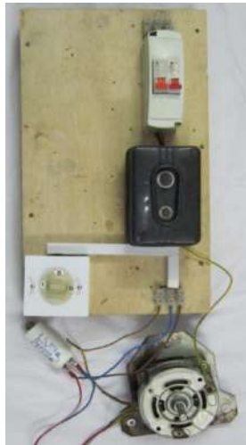
شكل (7-60) يوضح طريقة توصيل وتشغيل دائرة عكس اتجاه دوران محرك غسالة أحادي الطور
