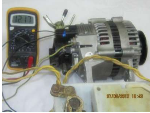
شكل (6- 7) فحص قيمة الجهد المتردد قبل توحيدده لكل من الملفات الثلاثة
