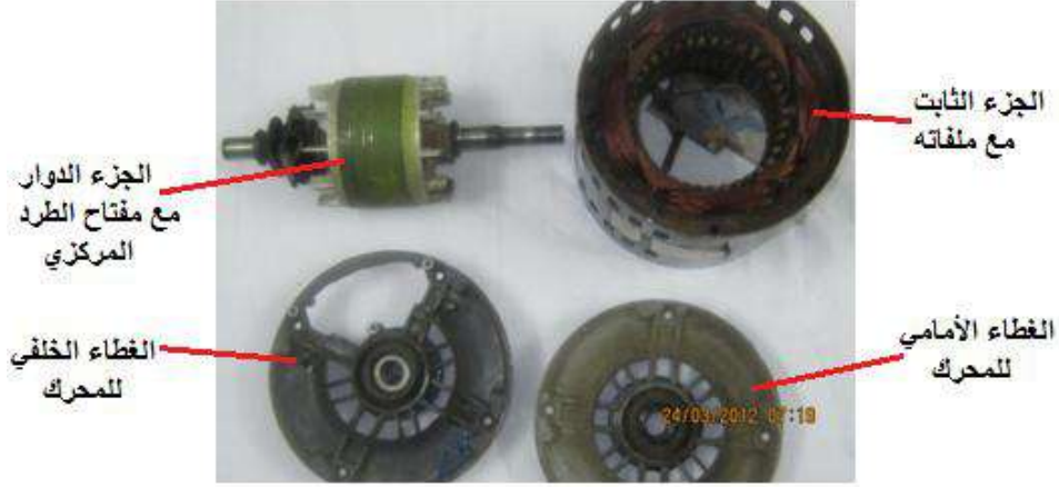
شكل (6-30) أجزاء المحرك الحثي الأحادي الطور ذي متسعة البدء ومفتاح الطرد المركزي
