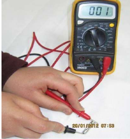
شكل (8-72) طريقة فحص الفاصم (الفاصم سليم)
