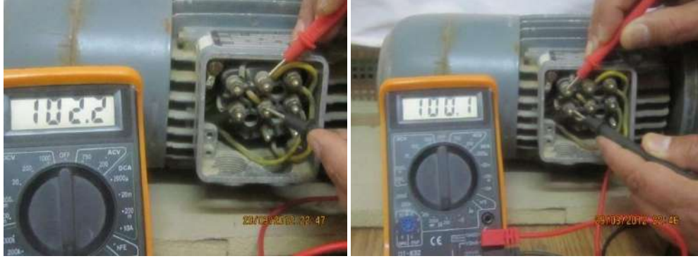
(أ) قياس قيمة مقاومة الملف ( U_1-U_2 ) (ب) قياس قيمة مقاومة الملف ( V_1-V_2 )
