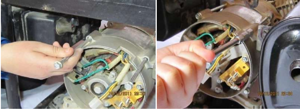
شكل (8- 44) فك براغي ماسك غطائي رأس التوليد الأمامي والخلفي
