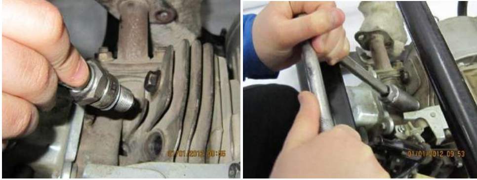
شكل (8- 66) فتح شمعة القدح باستخدام المفك (21mm)
