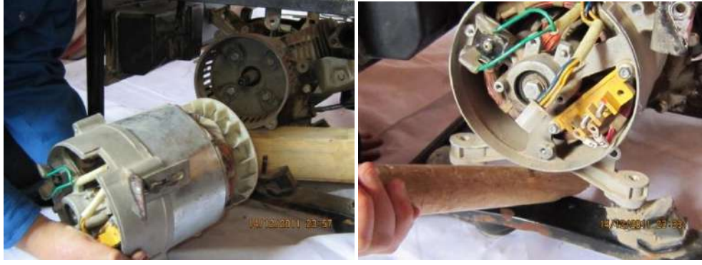
شكل ( 8- 49 ) كيفية سحب رأس التوليد من المحرك الميكانيكي خارج المولد
