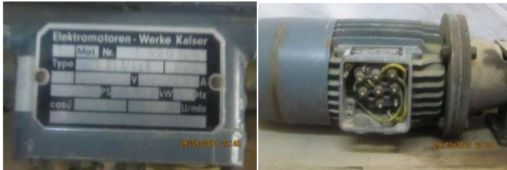
شكل (6-44) يوضح محرك حثي ثلاثي الأطوار قفص سنجابي مع لوحة التسمية له
