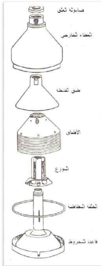
شكل ( 13 ) أجزاء قاعدة المخروط في جسم الفراز .
