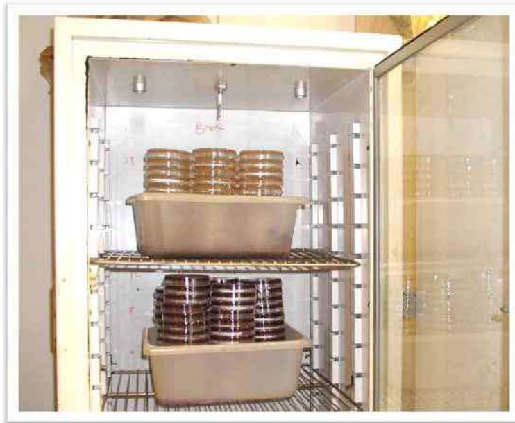
شكل ( 24 ) فرن الهواء الساخن المستعمل في تعقيم الأوساط الغذائية.
