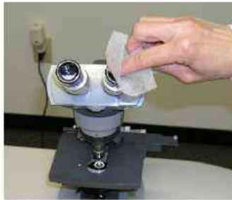
شكل (25) كيفية تنظيف العدسات بالورق الخاص بها.
