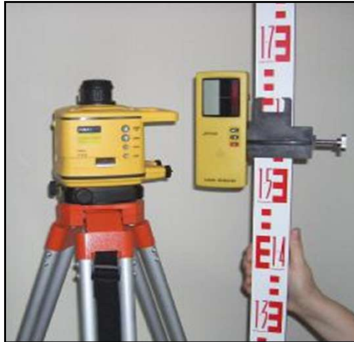
الشكل (39): جهاز يستخدم اشعة الليزر للكشف عن استوائية الاسطح
