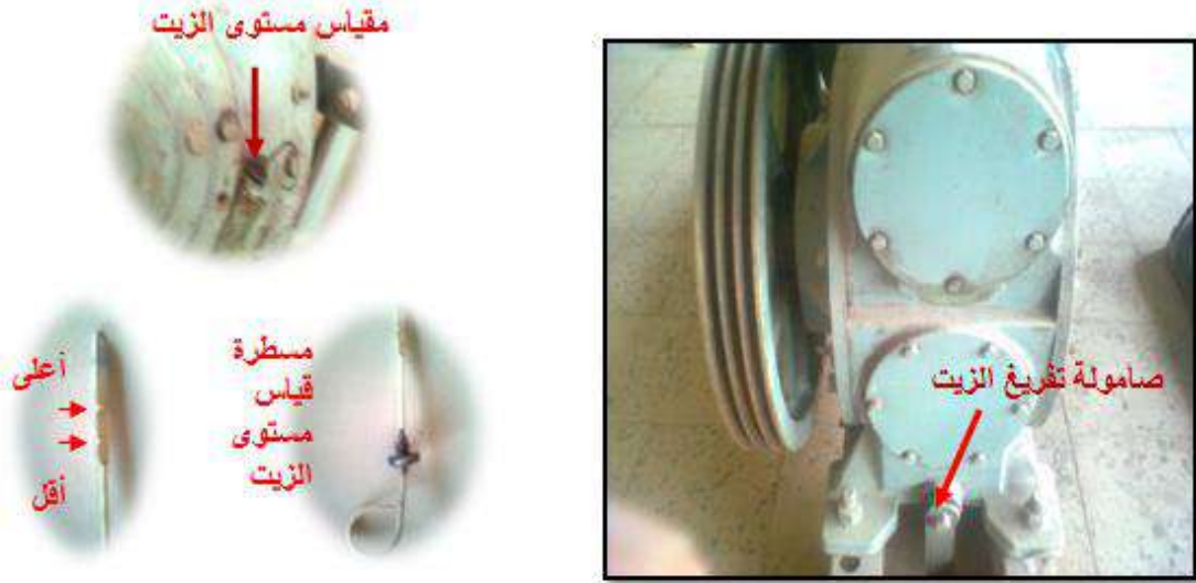
شكل (5-1) مقياس مستوى الزيت
