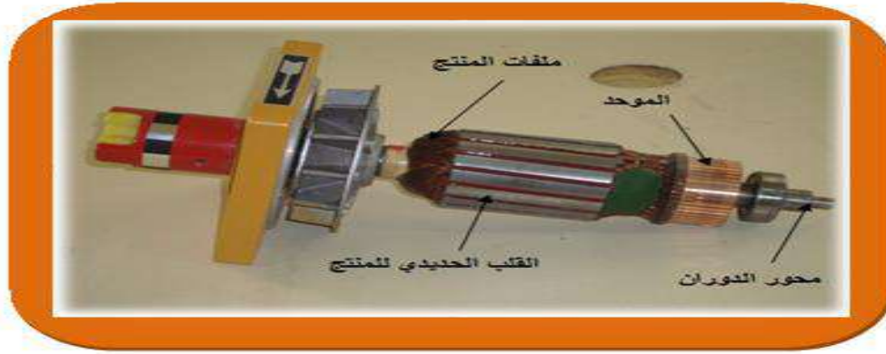
شكل (8-2) يبين الأجزاء الرئيسة للجزء الدوار
