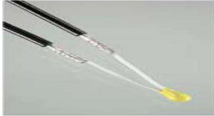
شكل (7-8) المزدوج الحراري ورمزه
