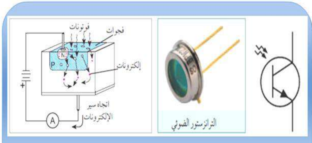
شكل (2-7) الترانزستور الضوئي ورمزه وتركيب
