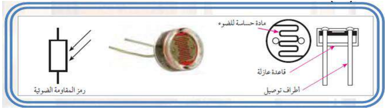
شكل (7-1) شكل المقاومة الضوئية وتركيبها ورمزها
