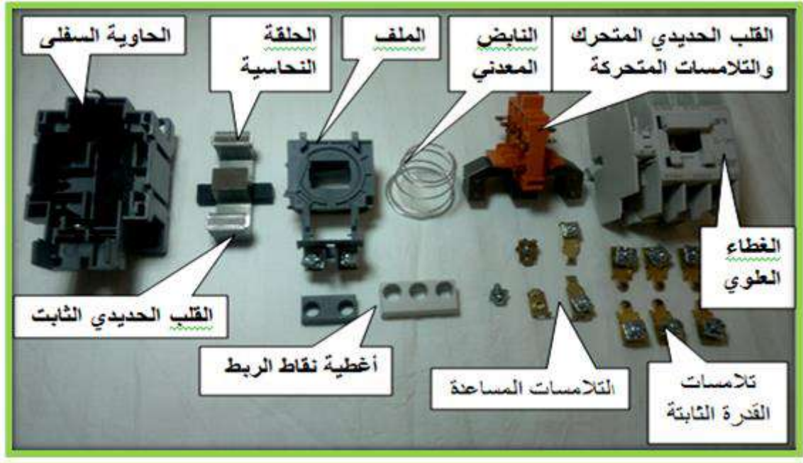
شكل (2-3) أجزاء الموصل الهوائي (AIR CONTACTOR)
