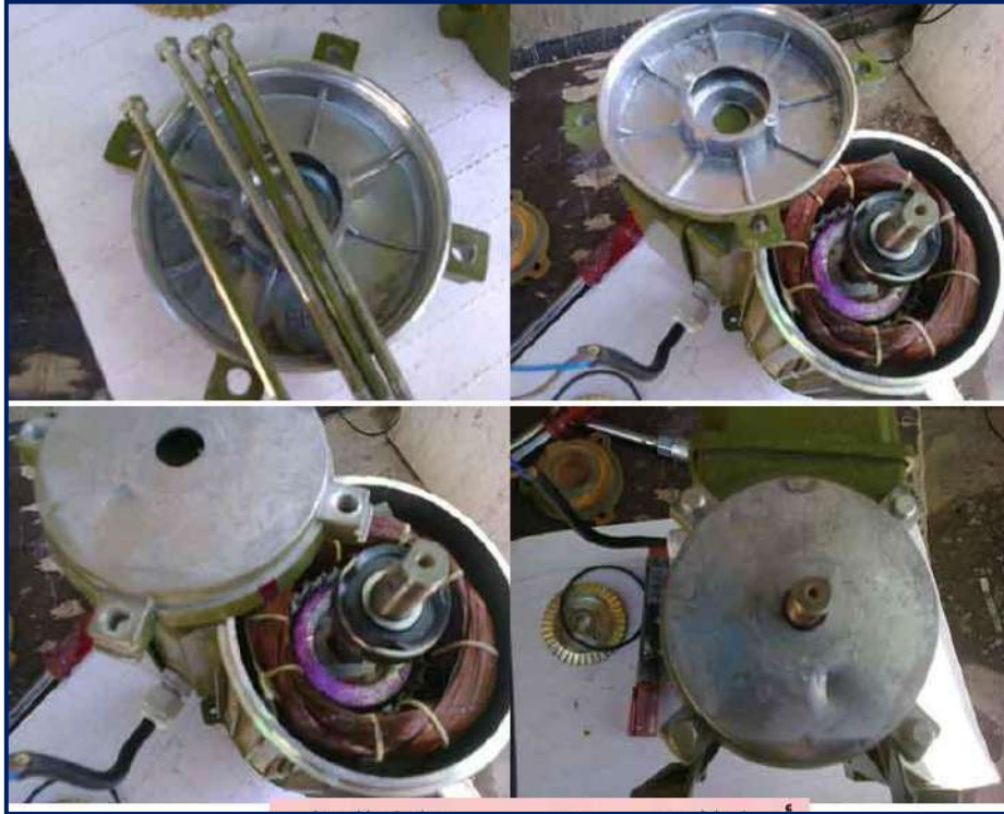
شكل 12-9 فتح براغي الغطاء الخارجي
