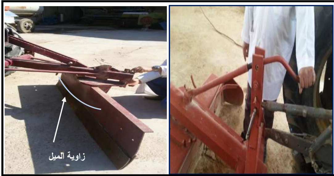
شكل 4-36 تقليل زاوية ميل آلة التسوية بوساطة العتلة اليدوية
