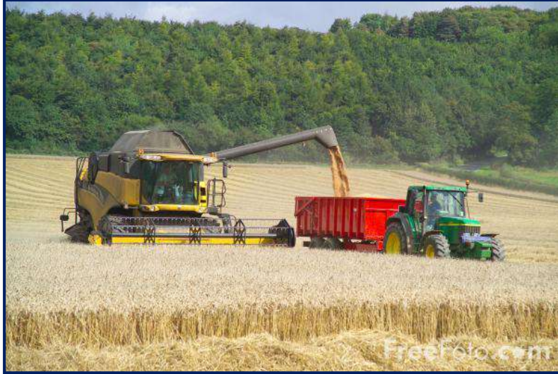
شكل 8-9 تفرغ الحبوب من خزان الحاصدة الى عربة النقل
