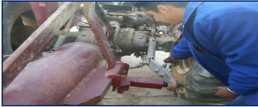
شكل 4-25 أرخاء أذرع الربط السفلية
