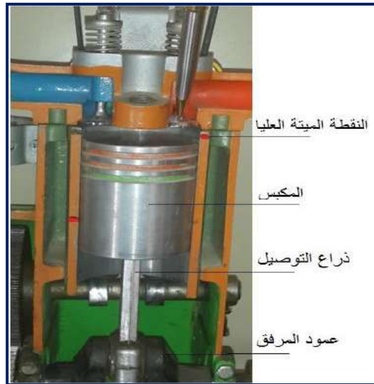
شكل 23-1 تحديد النقطة الميتة العليا
