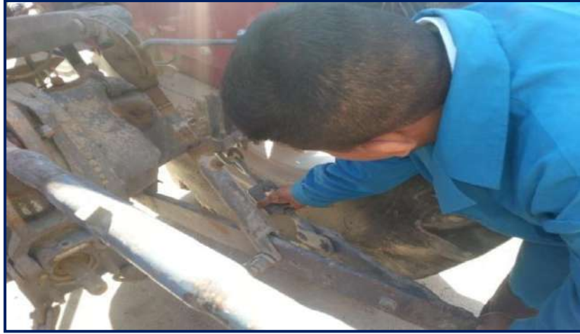
شكل 17-3 شد سلاسل الأذرع المخصصة لتثبيت الأذرع الجانبية
