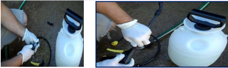
شكل 7-11 فصل صامولة رأس المرشحة
