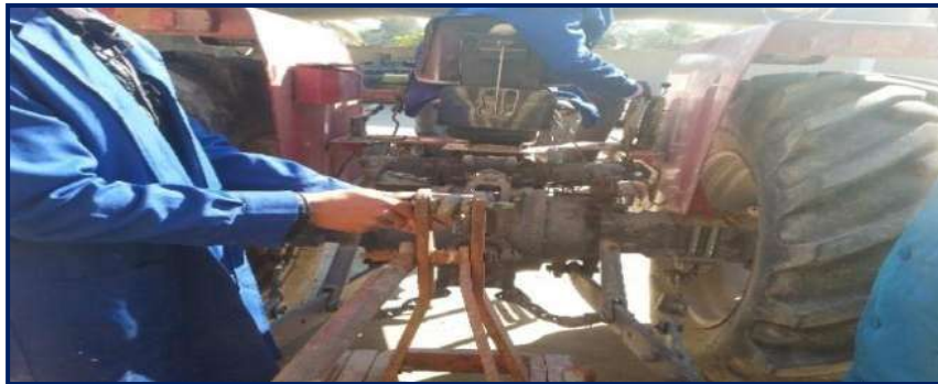
شكل 4-17 ربط الذراع التلسكوبية مع المحراث
