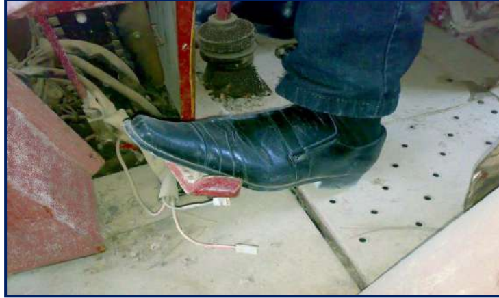
شكل 3-5 الضغط على دواسة الفاصل بواسطة القدم اليسرى
