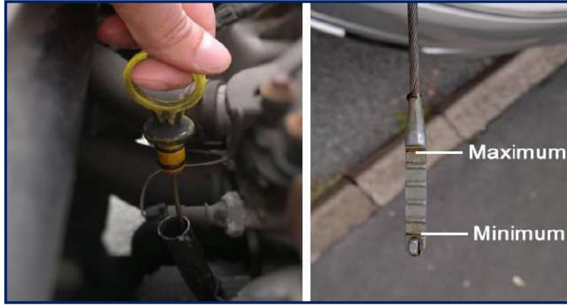
شكل 24-2 طريقة فحص مستوى الزيت
