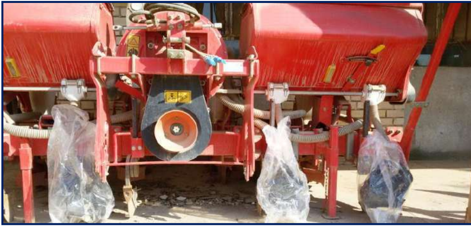
شكل 5-20 وضع اكياس تحت انابيب التقاوي
