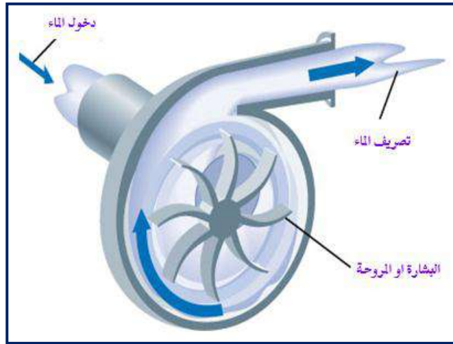
شكل 6-15 مبدأ عمل المضخة
