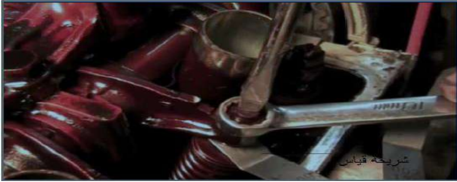
شكل 34-1 تدوير لولب الصمام مع تثبيت الصامولة ووضع شريحة القياس
