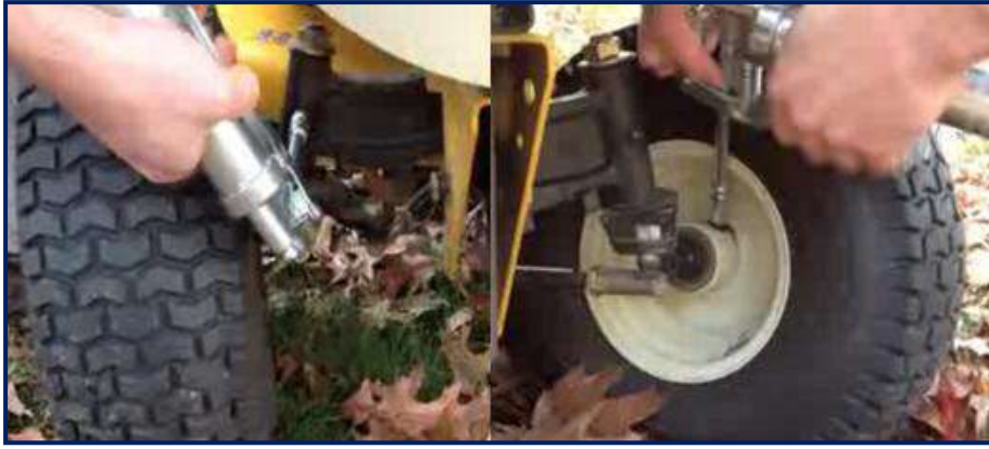
شكل 2-19 تثبيت رأس أنبوب التشحيم في الأماكن المحددة للتشحيم
