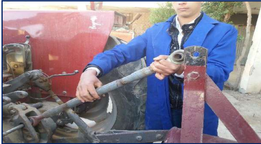
(7) اربط الذراع التلسكوبية مع المحراث وثبته بمسمار التثبيت وقم بضبط شده لضمان ثبات المحراث، الشكل (4-29).
