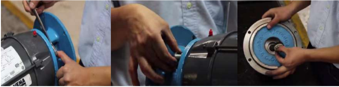
شكل 25-6 فصل بدن ربط البشارة من المحرك
