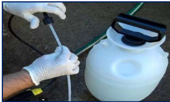
شكل 10-7 سحب أنبوبة خروج السائل إلى المسدس
