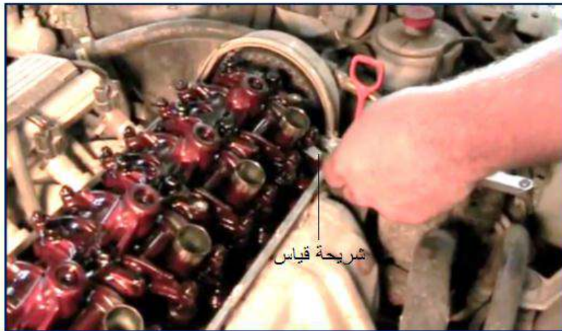
شكل 1-32 قياس خلوص صمام السحب باستعمال شريحة القياس
