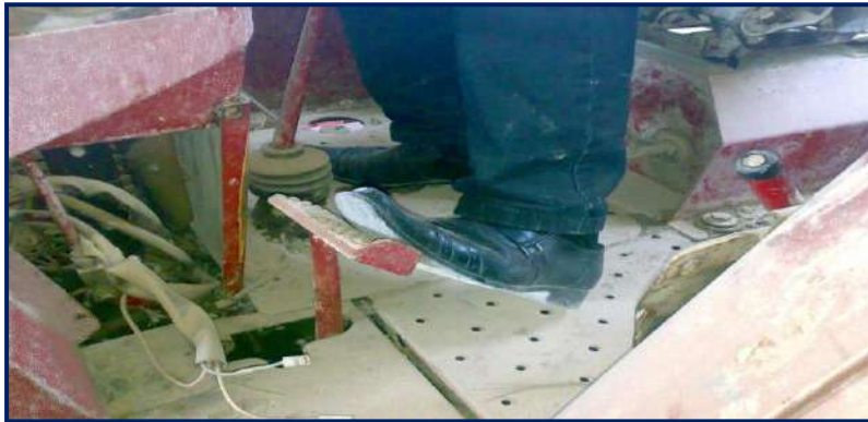
شكل 3-6 رفع القدم عن دواسة الفاصل ببطء
