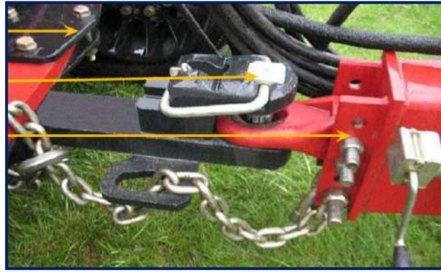
شكل 2-3 التأكد من ربط الآلات الزراعية بالجرّار
