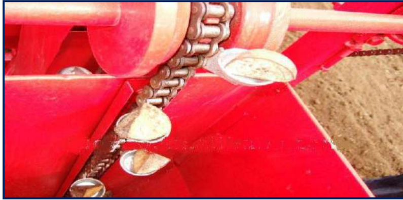
شكل 5-30 حمل كل كوب درنة واحدة
