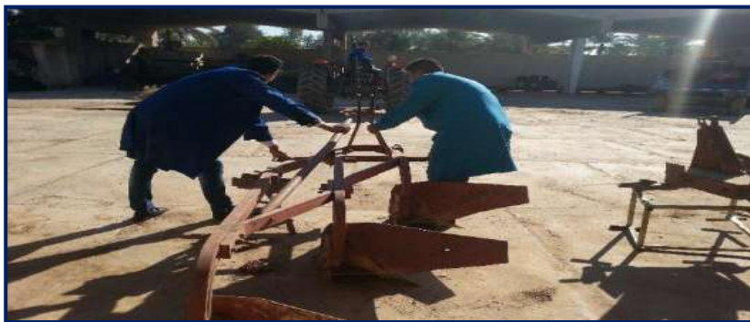
شكل 13-4 إرجاع الجرّار إلى الخلف باتجاه المحراث
