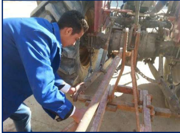
شكل 3-14 أرخاء ذراع الربط السفلية
