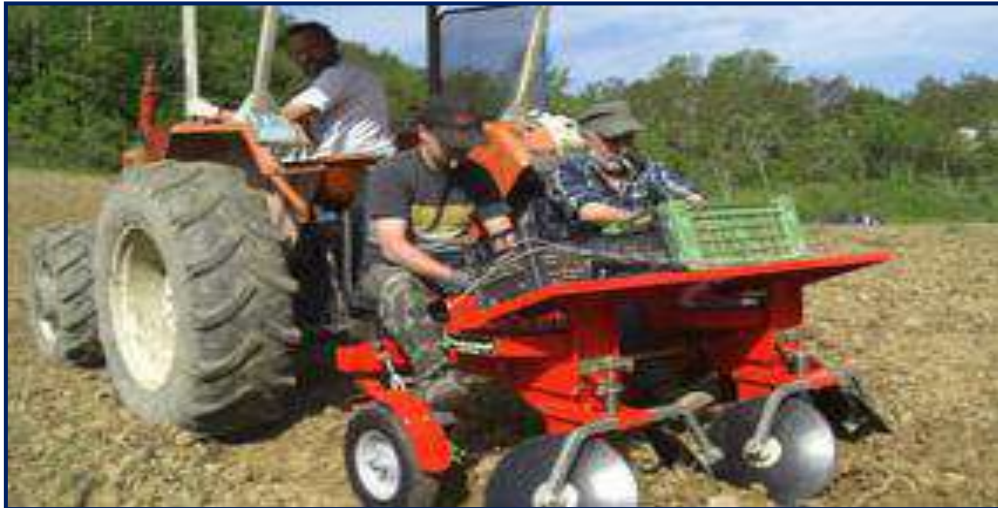
شكل 5-31 وجود عامل خلف الزراعة لمراقبة نزول الدرنات
