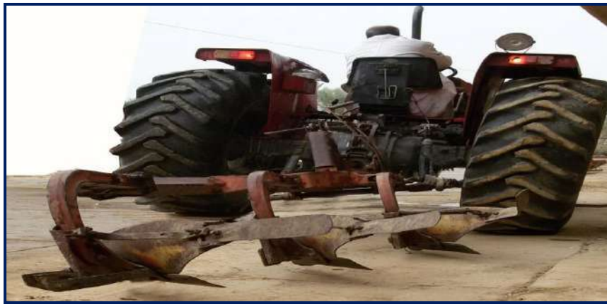
شكل 4-19 المحراث خلف الجرّار بعد إنزال الجرّار على ارض مستوية
