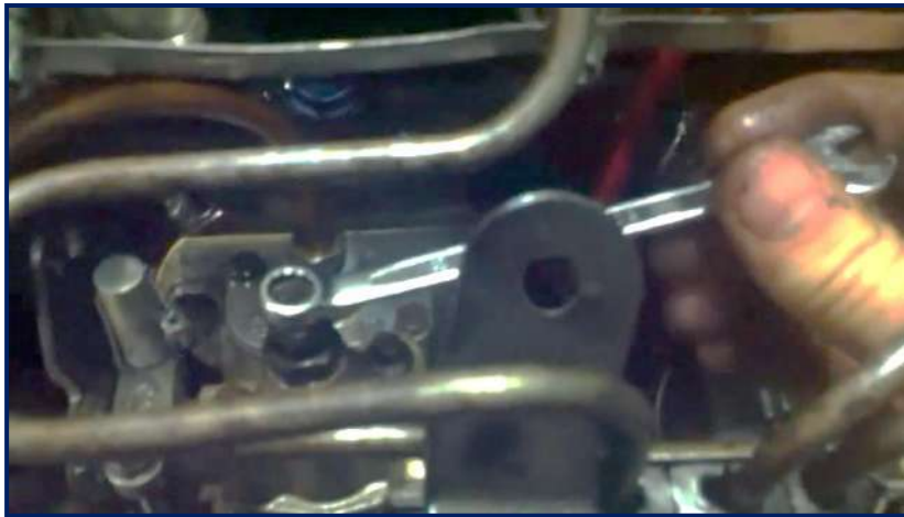
شكل 12-2 إرخاء الانبوب الخارجي من المرشح الثانوي
