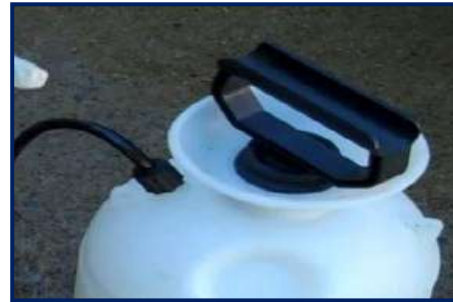
شكل 9-7 فتح الصامولة البلاستيكية
