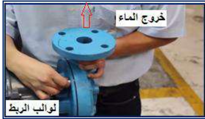
شكل 6-28 ربط بدن فتح التصريف مع البدن الرابط بين المحرك والبشارة
