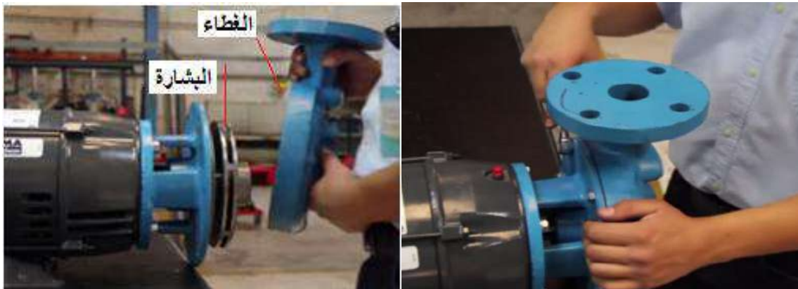
شكل 6-23 فتح بدن فتحة التصريف
