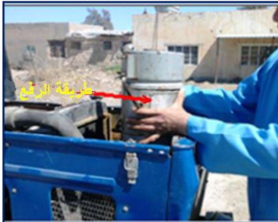
شكل 30-2 إخراج منقية الهواء من هيكل الساحة.
