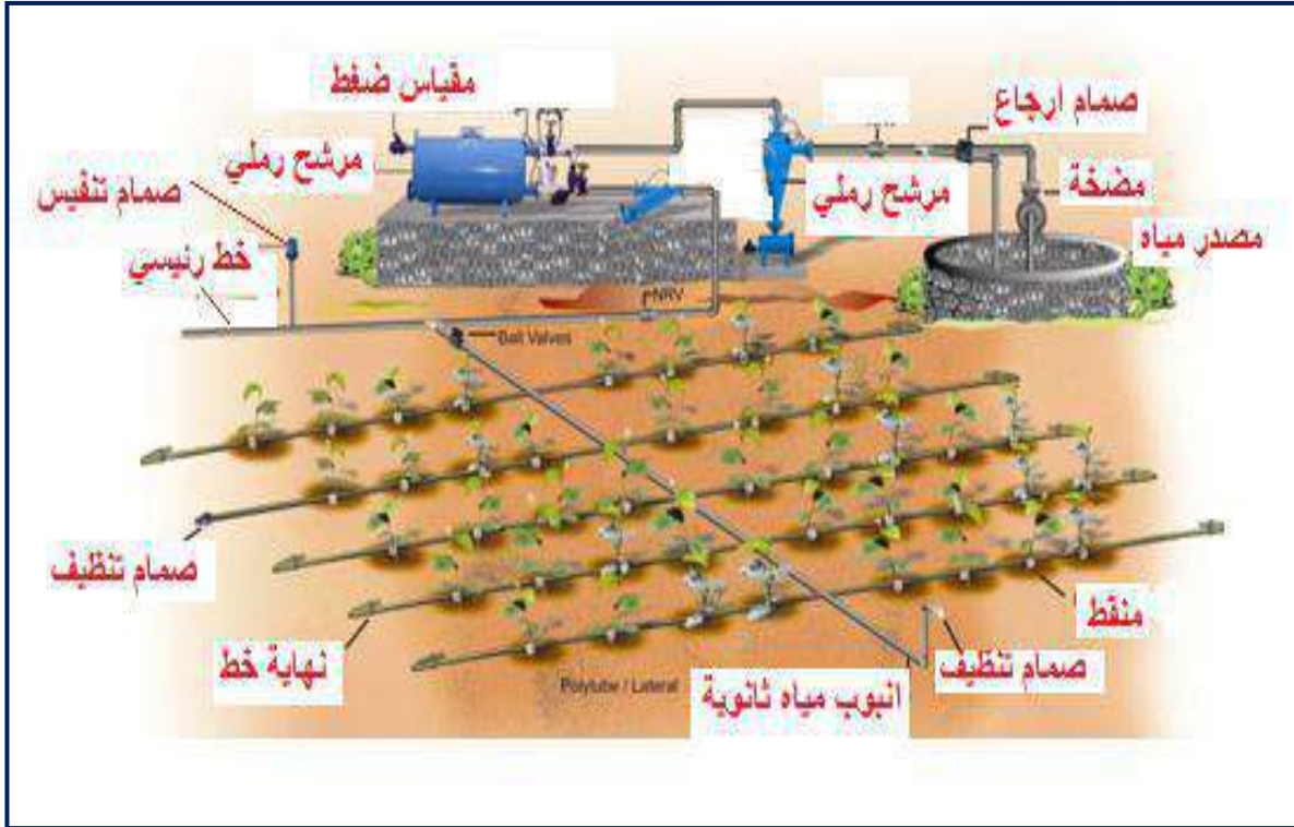
شكل 4-6 نموذج لشبكة الري بالتنقيط
