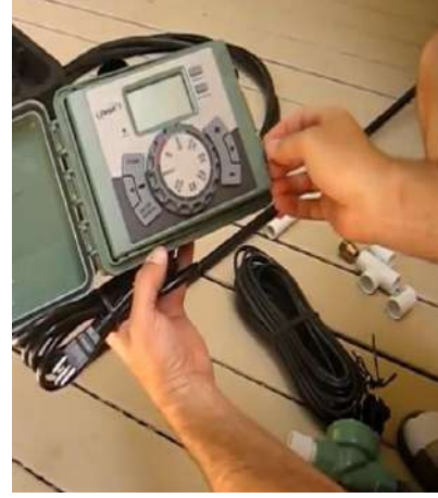
شكل 6-20 ربط التوصيلات الكهربائية مع مفتاح السيطرة
