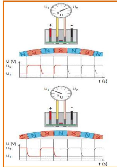
الشكل (4-22) آلية عمل متحسس زاوية عمود عجلة القيادة ذو الفيض المغناطيسي
