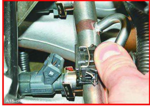
شكل (11-2) فصل الوصلة الكهربائية عن البخاخات شكل (12-2) فصل خراطيم الخلخلة
