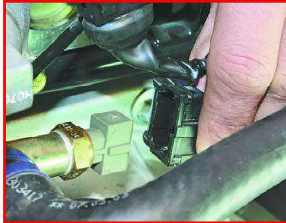
شكل (2-58) فصل الوصلة الكهربائية عن حساس درجة حرارة سائل تبريد المحرك
