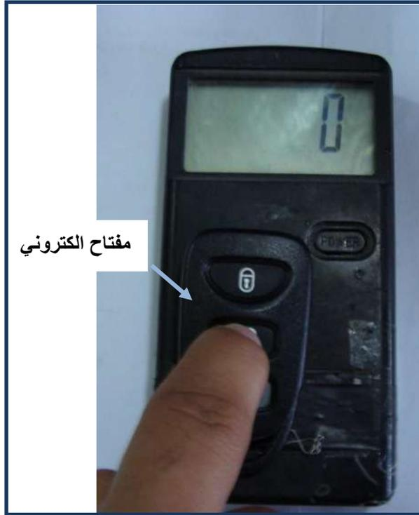
الشكل (12-1) وضع المفتاح الالكتروني فوق جهاز فحص التردد
