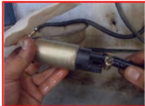
شكل (2-4) توصيل أنبوب تغذية للجهاز بمضخة الوقود
