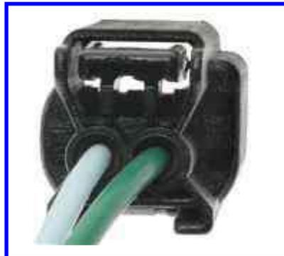
الشكل (3-15) رفع التوصيل الكهربائي عن الحساس
