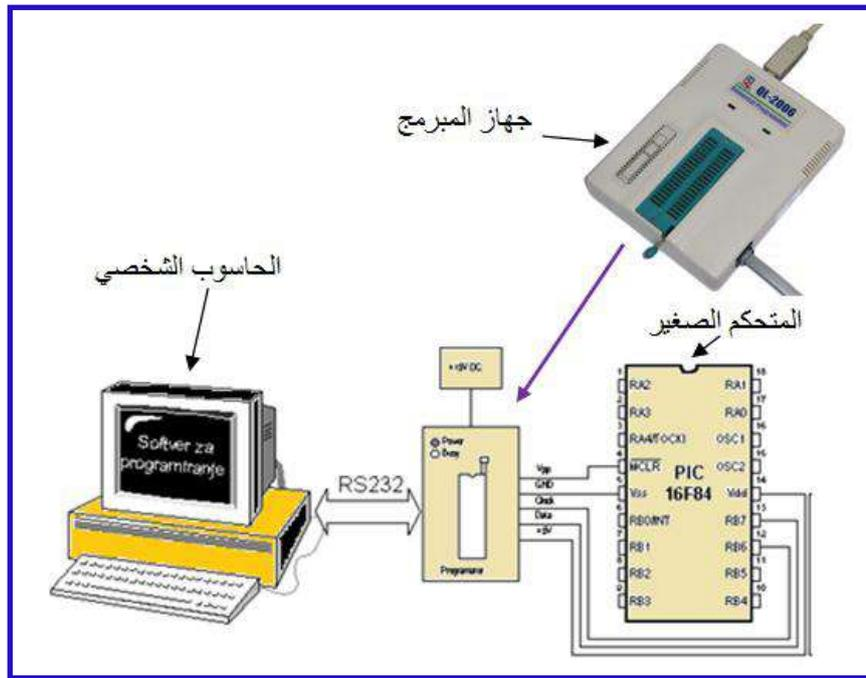
الشكل (2-3) جهاز المبرمج programmer Device
