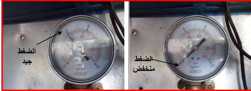
شكل (8-2) قراءة قياس ضغط الوقود
