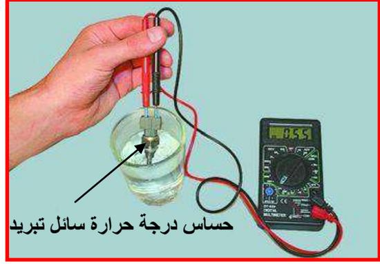
شكل (2-56) وضع حساس درجة حرارة شكل (2-57) قراءة المقاومة مع درجات الحرارة
