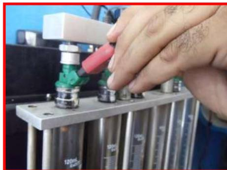
شكل (20-2) توصل الوصلة الكهربائية للجهاز الى البخاخ
