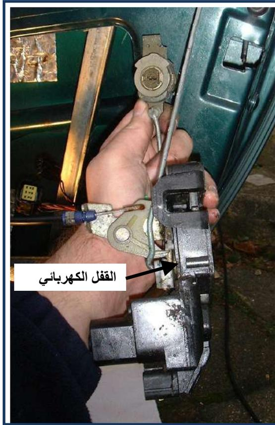
الشكل (9-1) اسحب القفل الكهربائي
