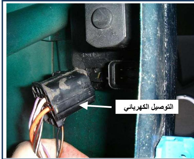
الشكل (8-1) فصل التوصيل الكهربائي
