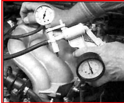
شكل (31-2) قراءة قياس الضغط الوقود
