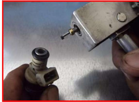
شكل (16-2) بتبديل مصفي الوقود الداخلي للبخاخ شكل (17-2) بتبديل الحلقة الدائرية المطاطية
