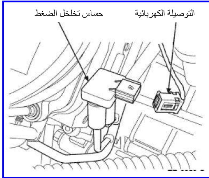
الشكل (3-43) فصل التوصيل الكهربائي
