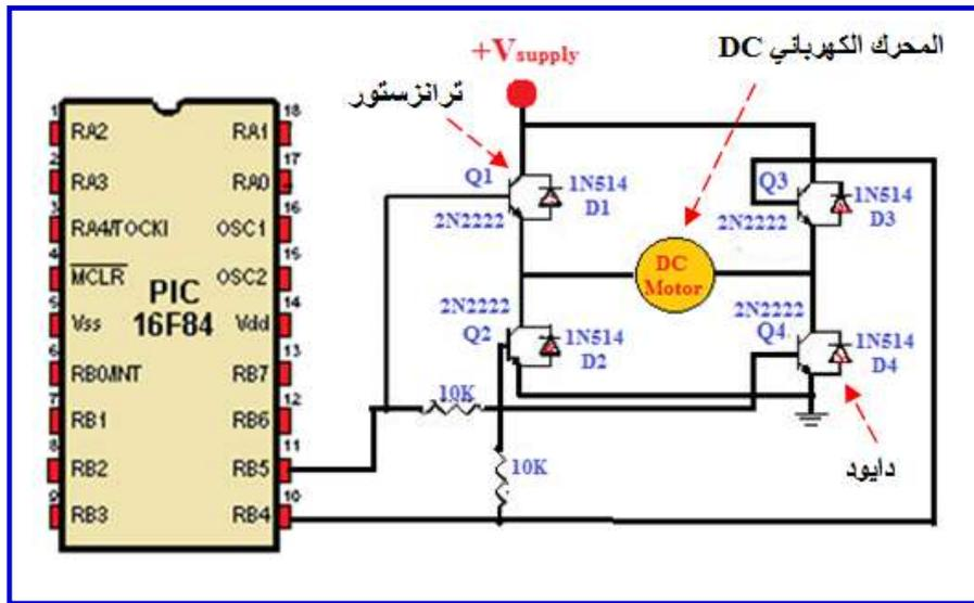
الشكل (3- 14) ربط المحرك الكهربائي (DC) الى المتحكم الصغير
