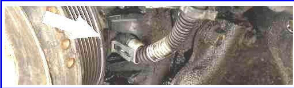
الشكل (12-3) التوصيل الكهربائي لحساس عمود المرفق
