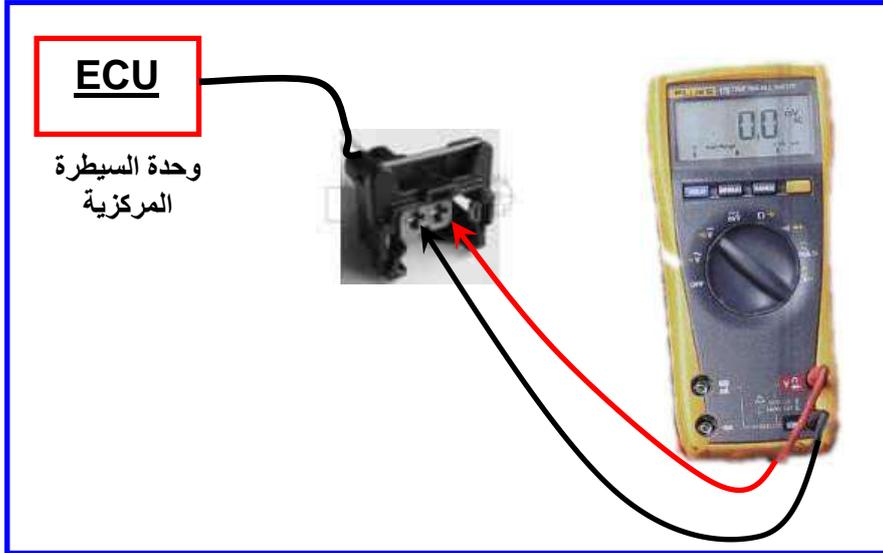
الشكل (3-40) ربط مقياس الفولتية الى التوصيلة
