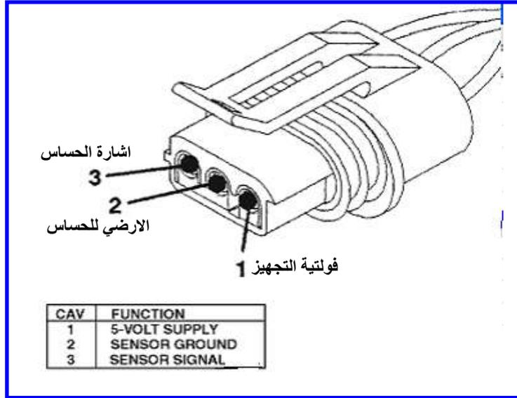
الشكل (19-3) التوصيلة الكهربائية لحساس هول
