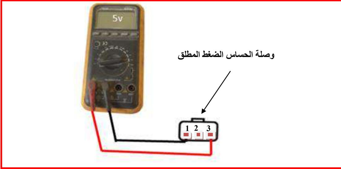
شكل (52-2) وضع أسلاك الأوفوميتر على الوصلة الكهربائية لحساس الضغط المطلق
