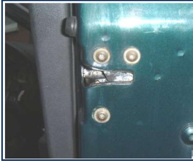
الشكل ( 1-1 ) لسان القفل الكهربائي
