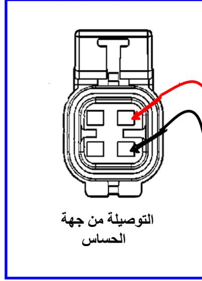
الشكل (3-49) ربط مقياس الفولتية الى الحساس
