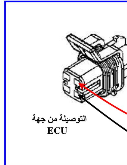
الشكل (3-47) ربط مقياس الفولتية الى توصيلة حساس الاوكسجين
