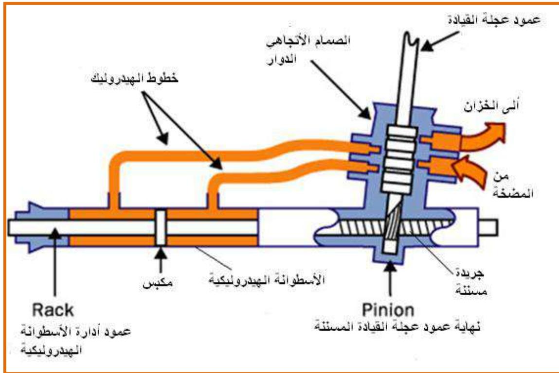
الشكل (4-8) الأسطوانة الهيدروليكية
