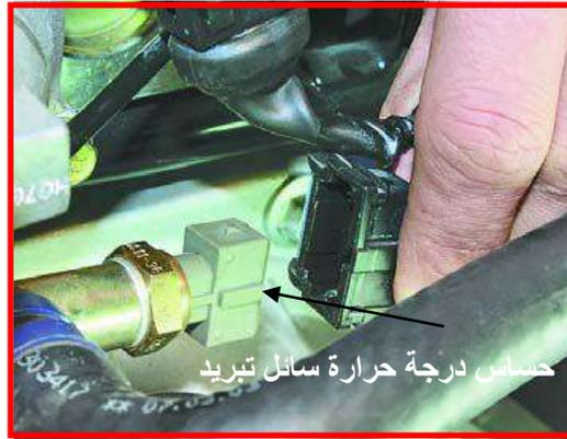
شكل (2-54) فصل الوصلة الكهربائية عن الحساس
