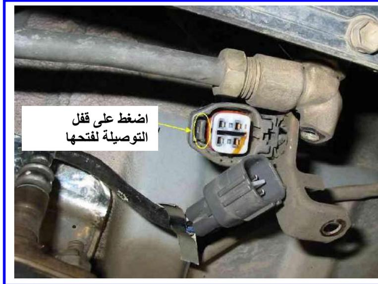
الشكل (3-46) فتح التوصيلة الكهربائية
