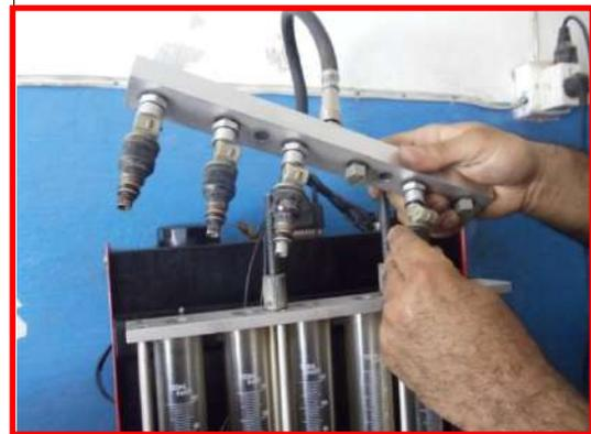
شكل (18-2) وضع البخاخ في المسطرة شكل (19-2) اربط المسطرة وثبتها بجهاز الفحص
