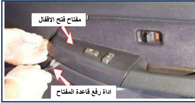
الشكل (3-1) مفتاح القفل الكهربائي
