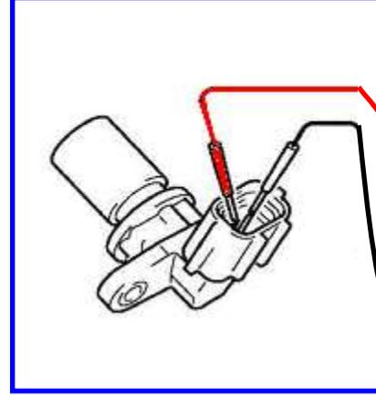
الشكل(3-16) ربط مقياس المقاومة الى حساس عمود المرفق
