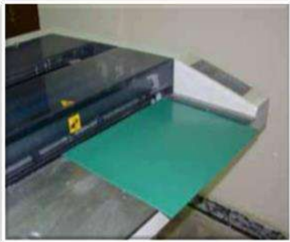
شكل رقم (٢) ادخال اللوح الطباعي
