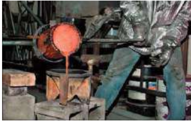
الشكل (14-1) بودقة اثناء الصب
