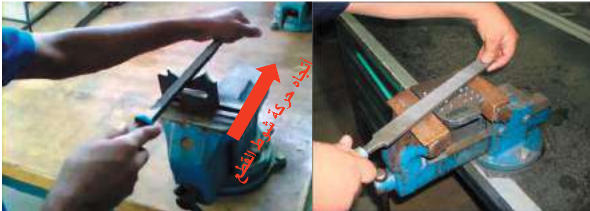
شكل رقم (2-3) مبدأ عمل المبرد
