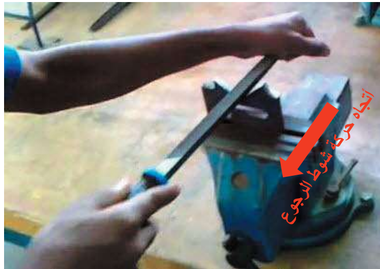
شكل (4-3) شوط الرجوع بالمبرد
