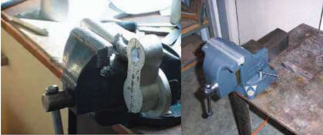
شكل (8-3) تثبيت المسبوكة بواسطة الملزمة
