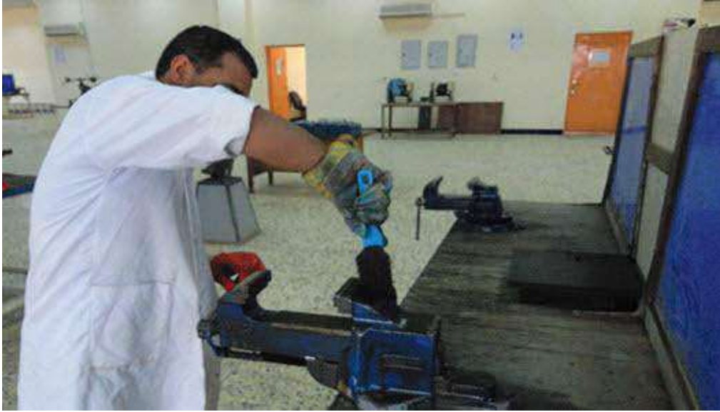
الشكل (3-11) السلامة المهنية اثناء عملية البرادة
