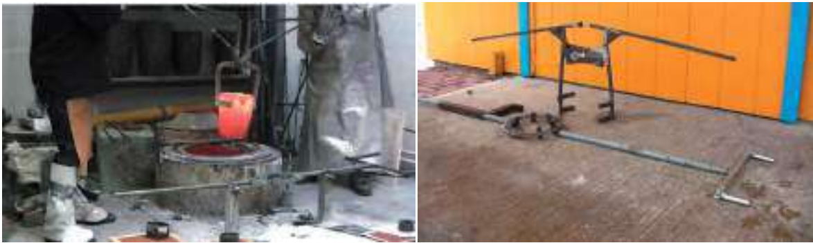
شكل ( 5-17 ) الصب بالبواق المحمولة يدوياً
