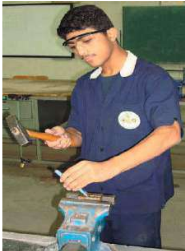
الشكل (33-3) الوقوف الصحيح أثناء التأجين
