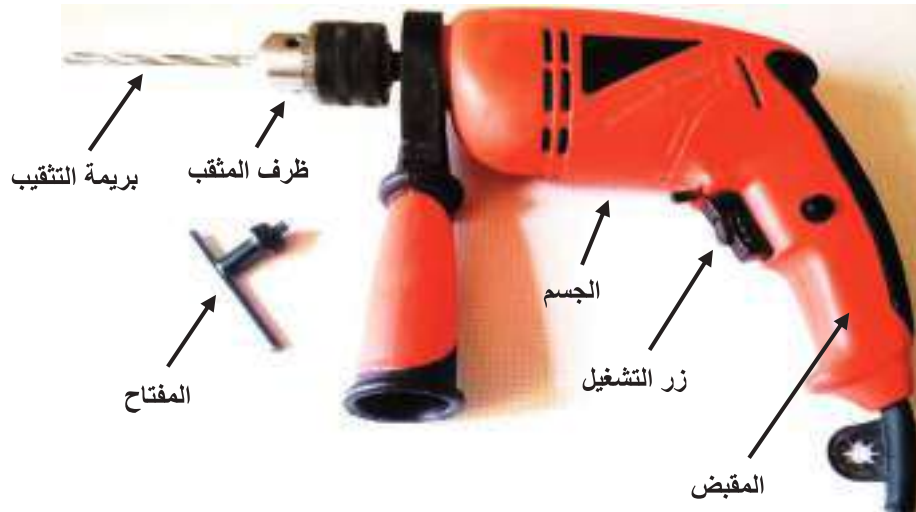
شكل (3-16) المثقاب الكهربائي اليدوي ومكوناته
