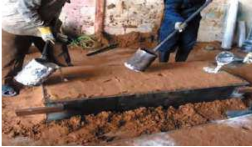
الشكل ( 7 - 3 ) الصب في ارضية المسبك
