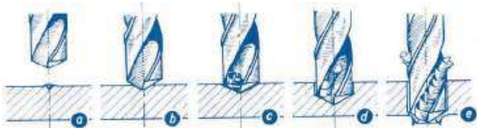
الشكل (3-15) كيفية عمل الثقوب في المسبوكة
