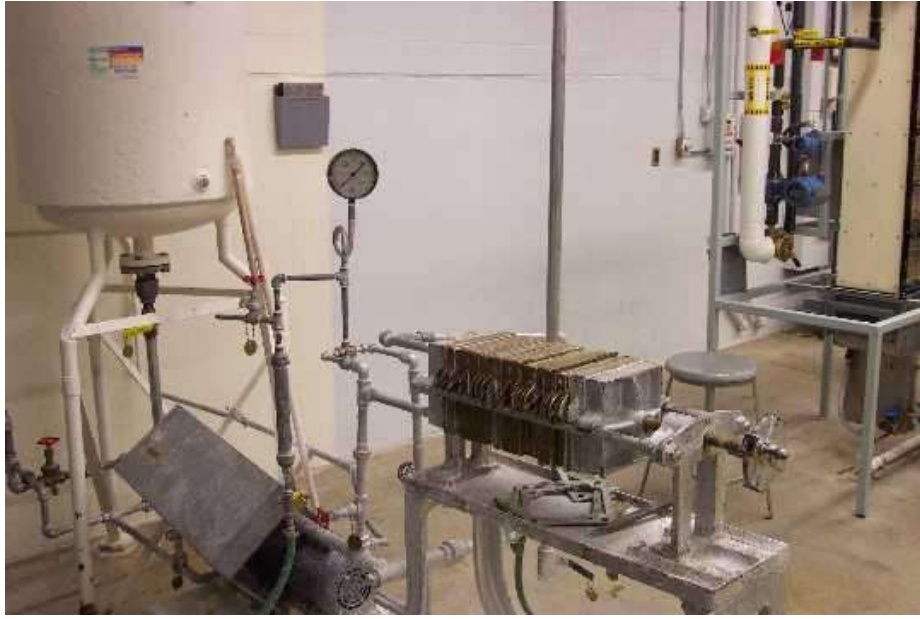
الشكل 2-7 المنظومة الكاملة لجهاز الترشيح ذي الألواح
