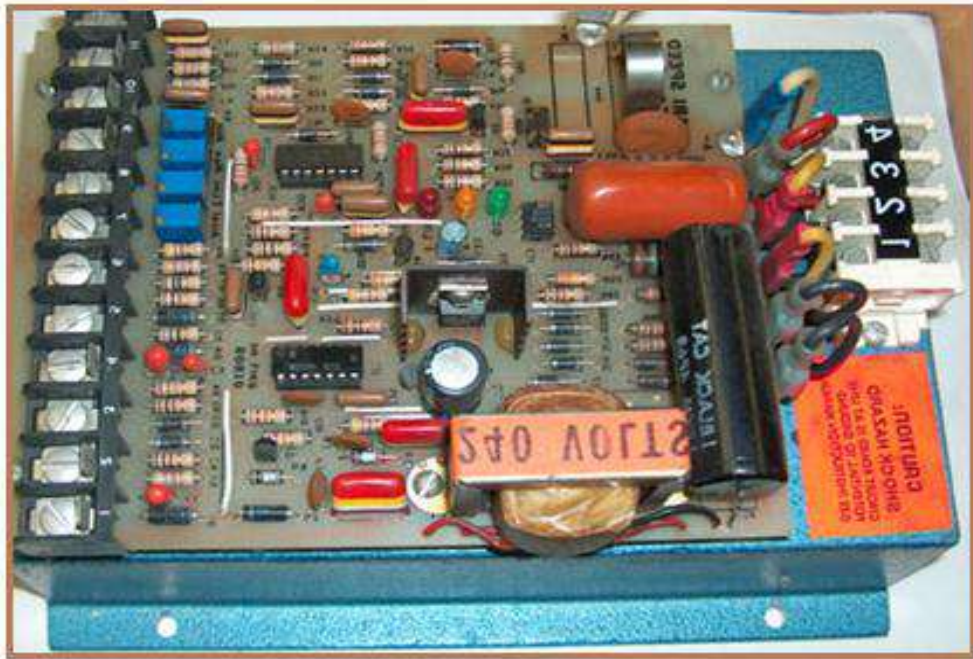
الشكل (1-5) عدد من عناصر الكترونيات القدرة في دائرة الكترونية لمحرك ماكينة إنتاجية
