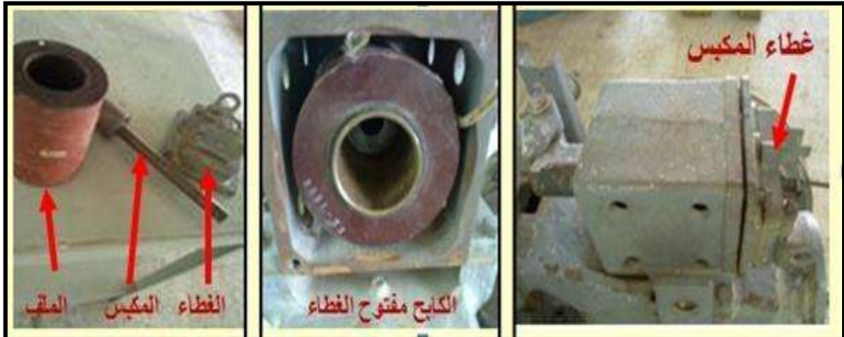
شكل (1 - 53) ج تفكيك أجزاء الكابح
