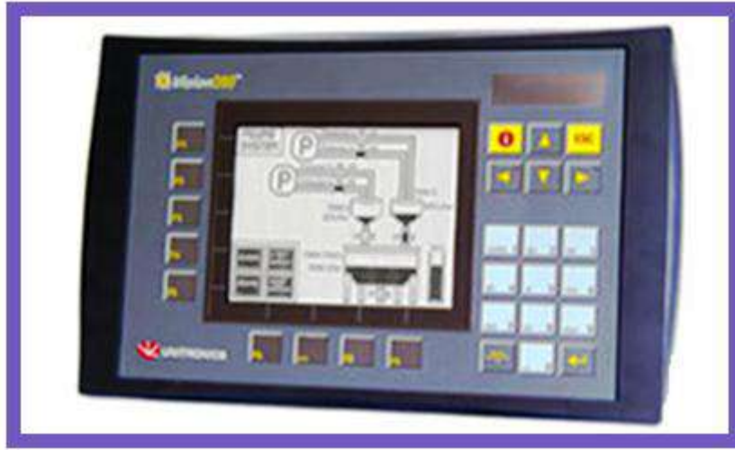
شكل (8-6) وحدة المشغل لجهاز (PLC)
