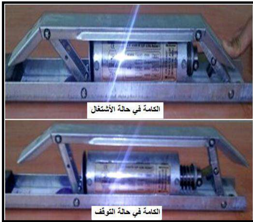
شكل(21-3) كامة فتح باب المصعد بوضعها (التوقف ، الأشتغال)
