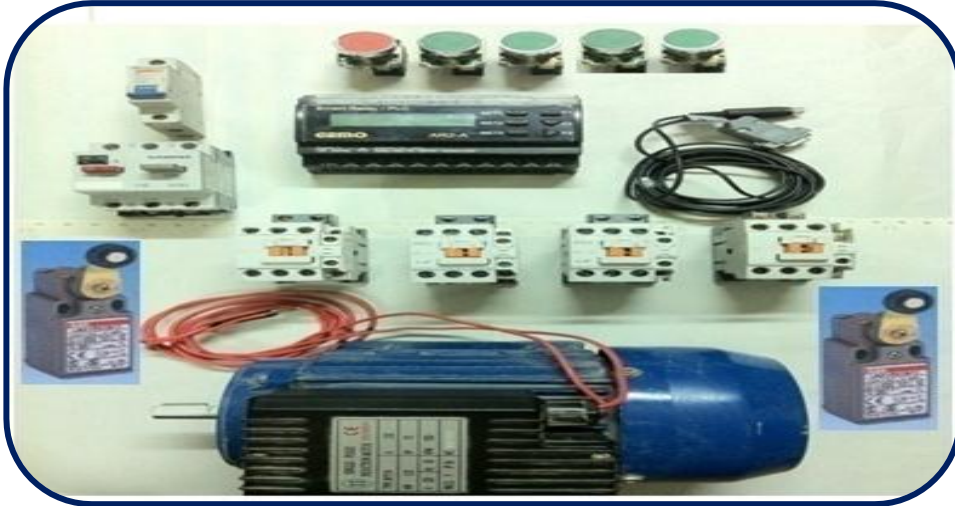
الشكل (6-47) تثبيت عناصر الدائرة الكهربائية الخاصة بالتمرين
