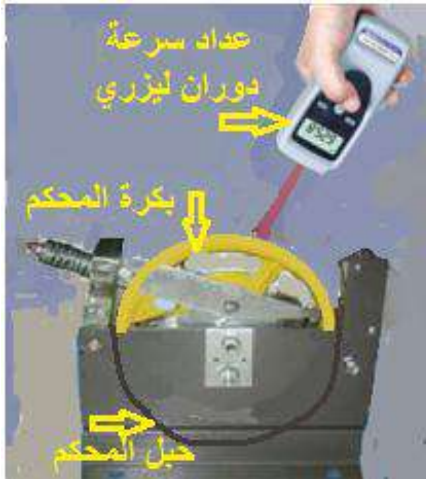
شكل (1 - 51) قياس عدد الدورات بكرة محكم السرعة
