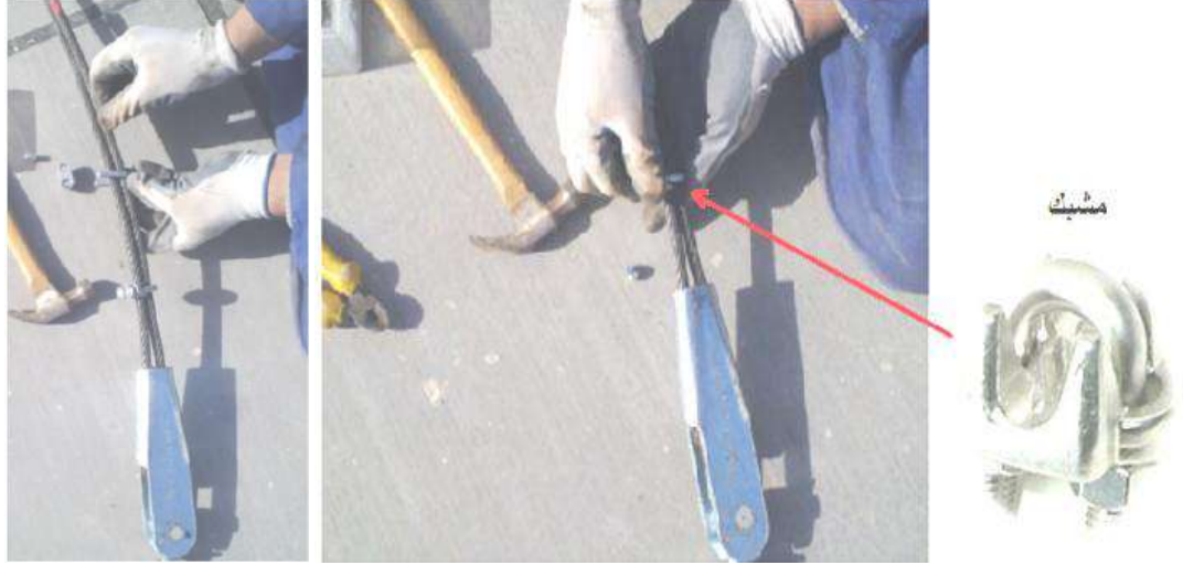
شكل (1 - 8) ربط جزئي الحبل الداخل والخارج بواسطة قفيص (مشبك)
