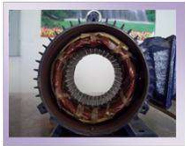
شكل (2-20) الجزء الثابت لمحرك ثلاثة أطوار
