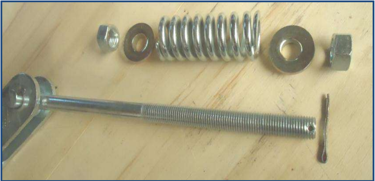
شكل (1 - 16) فتح صامولتي عمود المثبت ثم إخراج النابض وحلقتي الحصر
