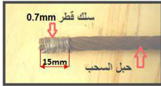
شكل (1 - 3) لف سلك من الحديد حول بداية الحبل الرئيس
