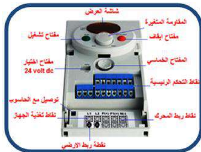
شكل (12-5) الأجزاء الرئيسية لجهاز العاكس (Ac-inverter) لشركة LG موديل ic5
