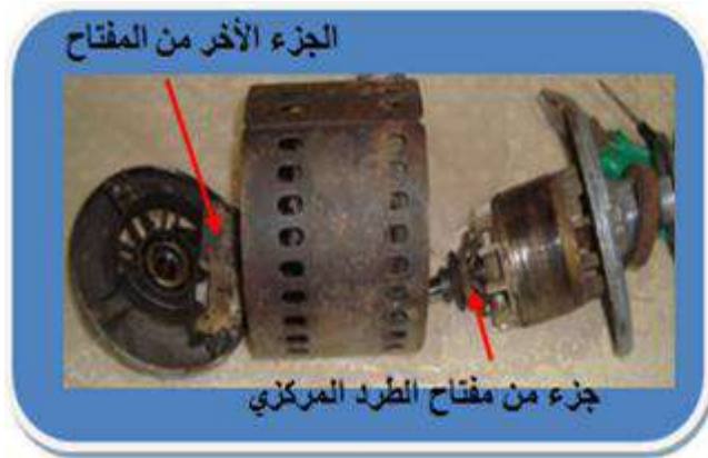
شكل (7-2) ب المفتاح المغناطيسي مع الملفات
