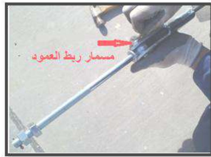
شكل (1 - 9) ربط العمود المسنن مع ثقب الكشتبان بواسطة المسمار (بيم)
