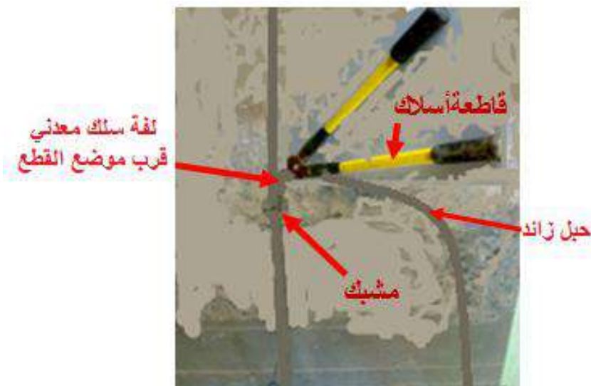
شكل (1 - 18) قطع الطول الزائد للحبل بواسطة قاطعة الأسلاك
