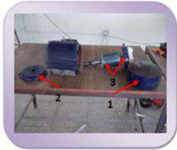
شكل (2-19) تفكيك محرك حثي ثلاثة أطوار
