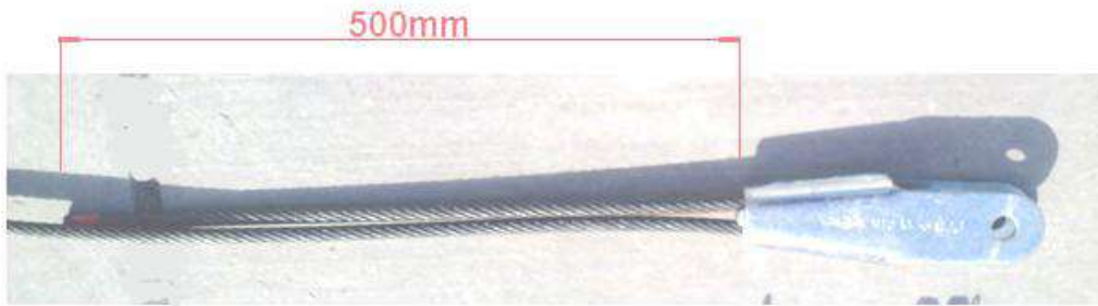
شكل (1 - 7) سحب جانبي الحبل بقوة لإدخال الحاصرة داخل الكشتبان
