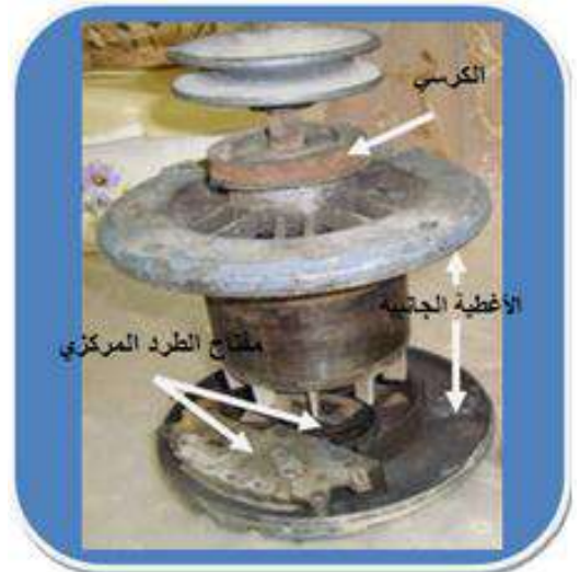
شكل (9-2) الأغطية الجانبية للجزء الدوار المقصور
