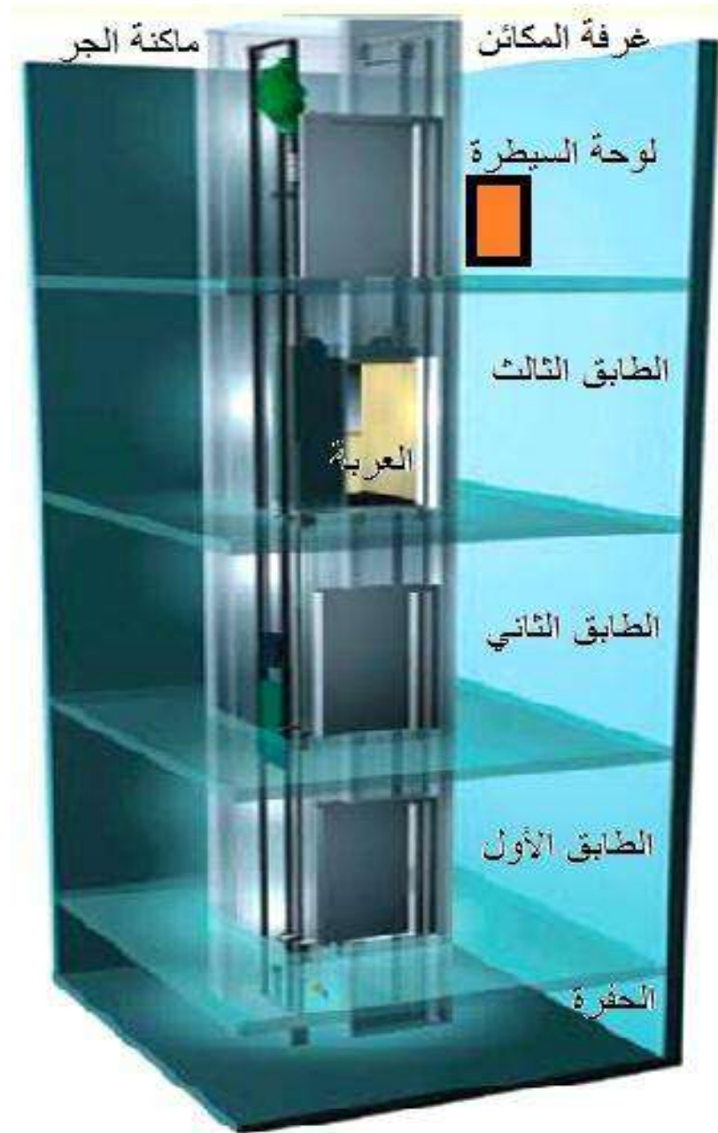
شكل (3-28) مصعد كهربائي ذو طوابق ثلاث
