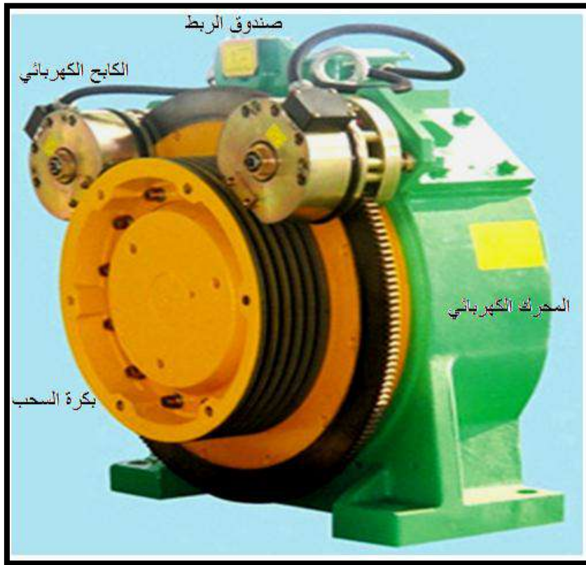
شكل (31-3) ماكينة سحب لمصعد كهربائي بطابقين وبسرعتين عالية وبطيئة
