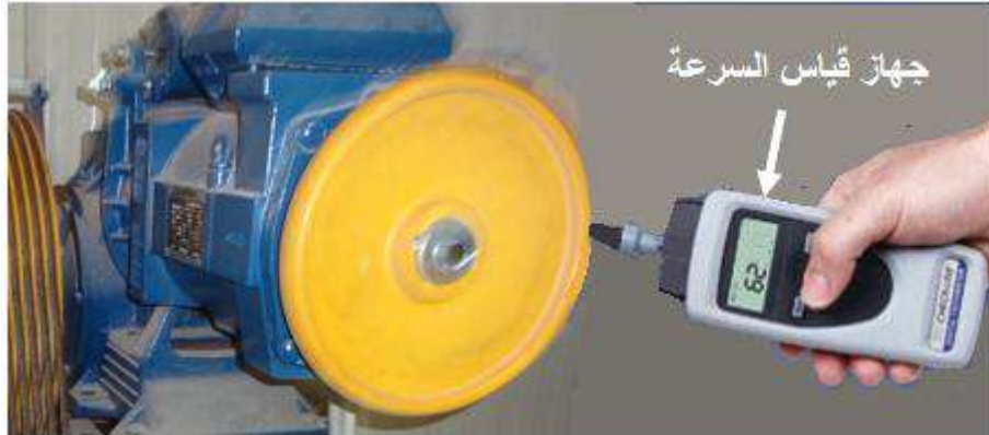
شكل (1 - 45) قياس سرعة دوران ماكينة السحب بأستخدام جهاز قياس السرعة (Tachometer)
