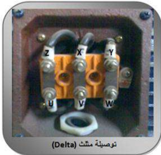
شكل (2-17) توصيل الأطراف النهائية للمحرك الثلاثي الأطوار (الحتي)
