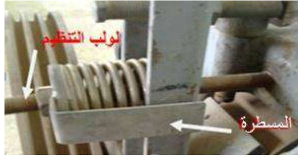
شكل (1 - 54) فتح لولب ومسطرة التنظيم للكابح
