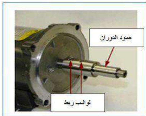
الشكل رقم ( 21-3 ) يبين طريقة ربط عمود المحرك وعمود دوران المضخة
