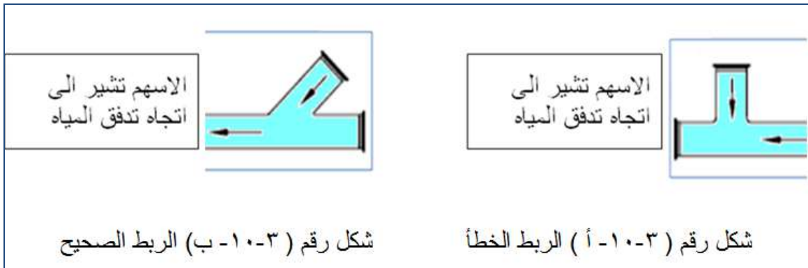
شكل رقم ( 10-3 ) يبين الربط الخطأ والصحيح للأنابيب
