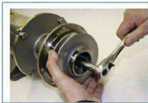
الشكل رقم ( 31-3 ) طريقة ربط البشارة
