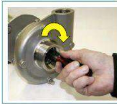
الشكل رقم ( 34-3 ) التأكد من دوران المضخة بشكل طبيعي
