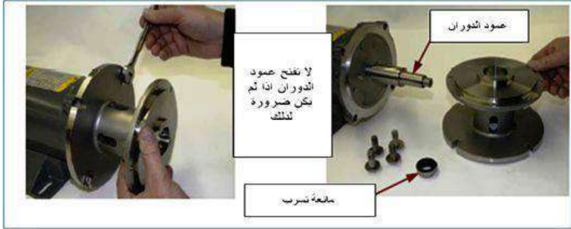
الشكل رقم ( 20-3 ) يبين طريقة فصل البراكييت الرابط
