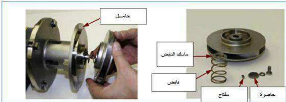
الشكل رقم ( 3-19 ) يبين طريقة فتح البشارة
