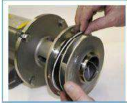
الشكل رقم ( 32-3 ) يبين كيفية تركيب حلقة الحصر
