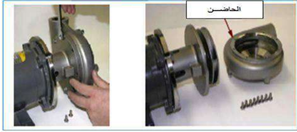
الشكل رقم ( 3-17 ) فصل المضخة عن الحاضن
