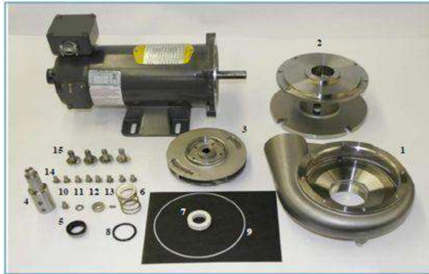
الشكل رقم ( 3-16 ) يبين أجزاء وارقام كل جزء من المضخة .
