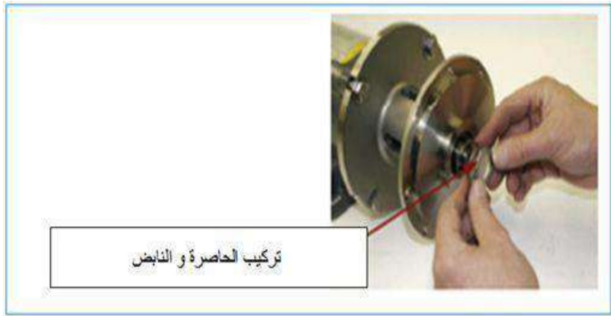
الشكل رقم ( 29-3 ) تركيب الغطاء المسطح
