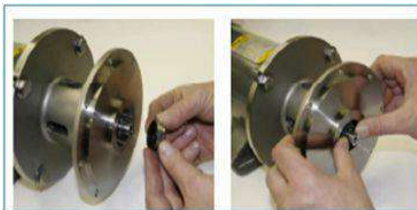
الشكل رقم ( 3-27 ) تركيب مجموعة القفل على المحور
