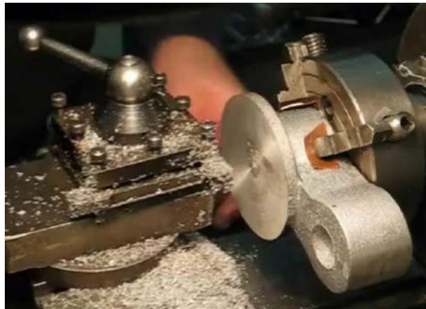
الشكل ( 5-16 ) التشغيل على ماكنات الخراطة
