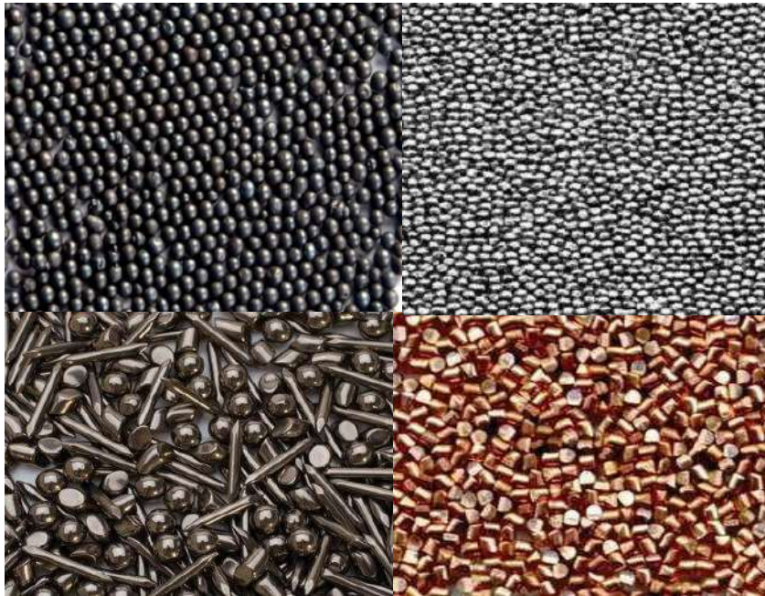
الشكل ( 5-31 ) يوضح المواد المعدنية المستعملة بطريقة العصف
