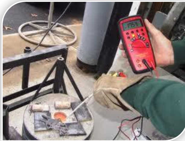
الشكل 2-2 جهاز قياس درجة الحرارة بالمقاومة الكهربائية
