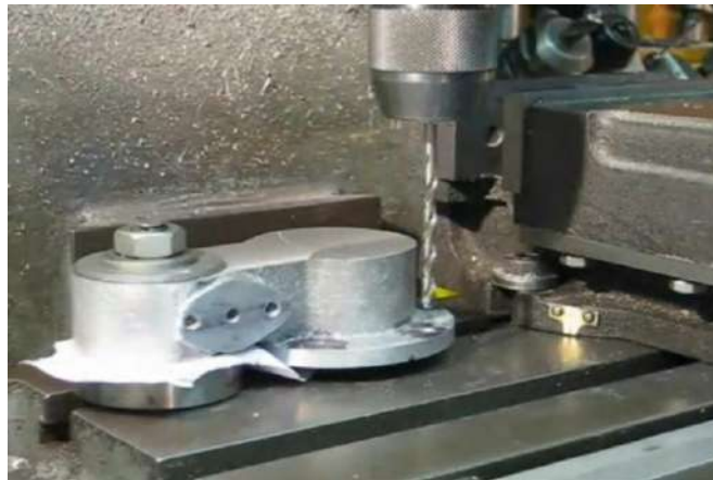
الشكل ( 19-5 ) التشغيل على ماكنات التثقيب
