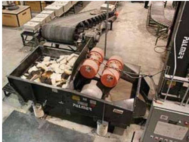
الشكل 4-8 يبين طريقة تفتيت القوالب الرملية بعد الصب
