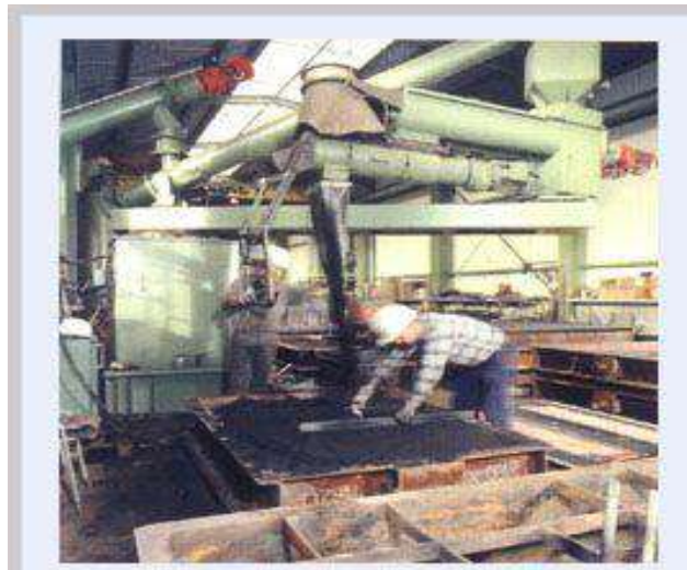
الشكل 4-4 يبين طريقة استعمال الخلاط المستمر المتحرك لملء صناديق المقالبة
