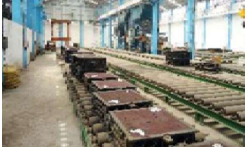
الشكل 4-5 يبين طريقة نقل القوالب الرملية آليا
