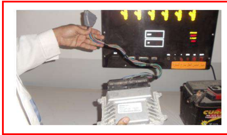
شكل (37-1) ربط التوصيلة بوحدة التحكم
