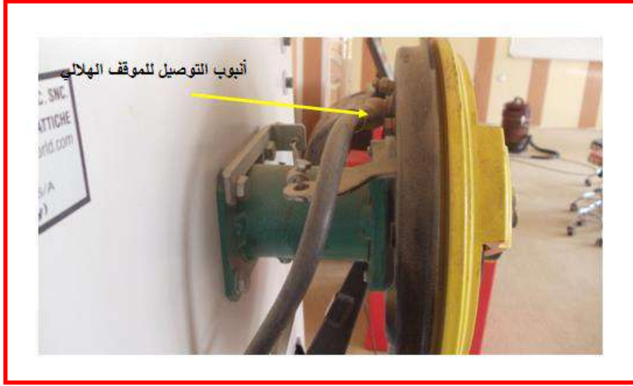
شكل (3-21) تأكد من عدم تسرب سائل الموقف من مكان ربط انبوب التوصيل لنظام الموقف الهلالي
