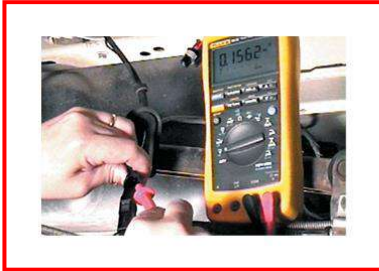
شكل (34-3) قراءة الفولتية المحتثة من حساس سرعة العجلة عند تحريك الاطار المطاطي
