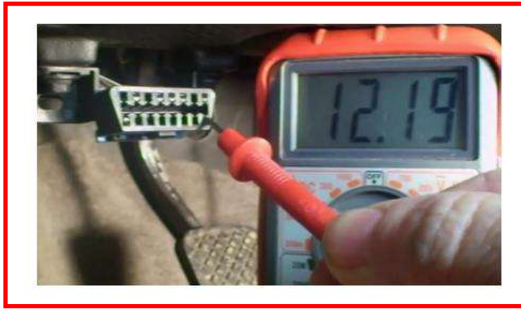
شكل (1-45) فحص نقطة توصيل الفولتية
