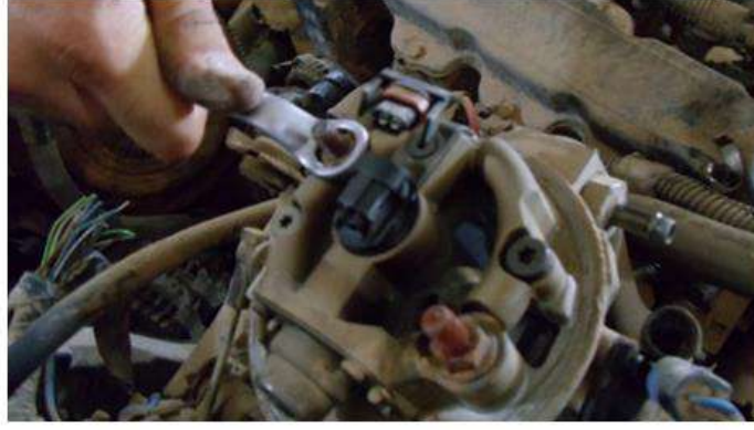
شكل (12-4) فتح برغي تثبيت جسم الخانق في المحرك
