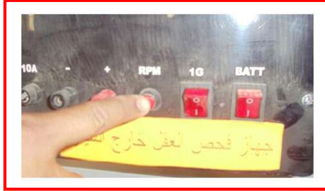
شكل(1-39) تزويد وحدة التحكم بإشارة دوران عمود المرفق
