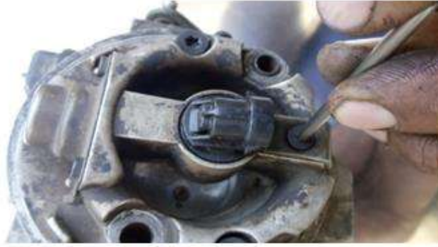
شكل (13-4) فتح براغي تثبيت البخاخ المركزي
