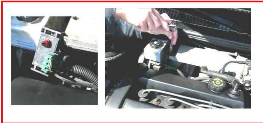
شكل (21-1) رفع الحساس وفصل التوصيلة
