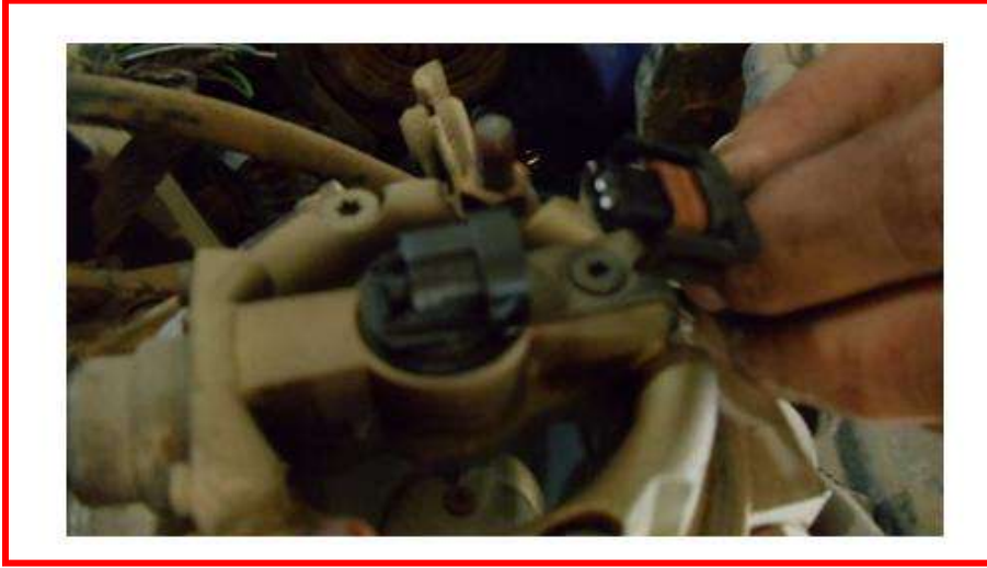
شكل (4-10) فصل الوصلة الكهربائية عن الحاقن المركزي
