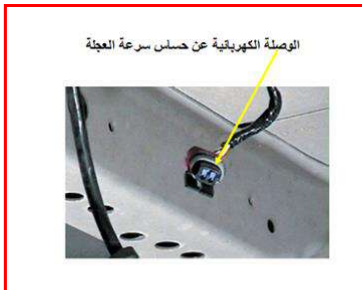
شكل (28-3) فصل الوصلة عن حساس سرعة العجلة
