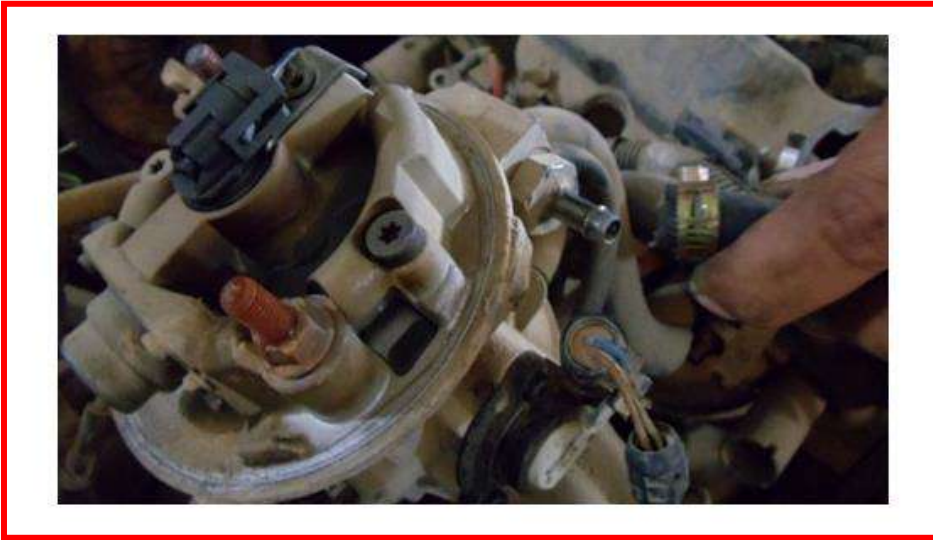
شكل (9-4) فصل خراطيم الوقود من حاقن الوقود المركزي
