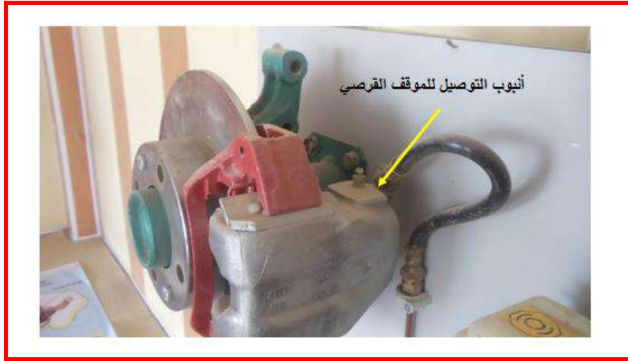
شكل (20-3) تأكد من تسرب سائل الموقف من مكان الربط انبوب التوصيل لنظام بالموقف القرصي
