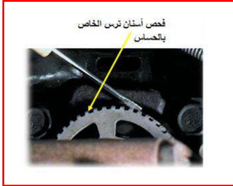
شكل (25-3) فحص اسنان الترس الخاص بالحساس
