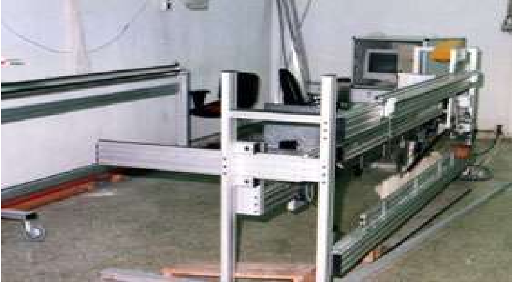
الشكل رقم ( 2 ) يبين آلة اللقي سرعتها من 600- 800 خيط / ساعة
