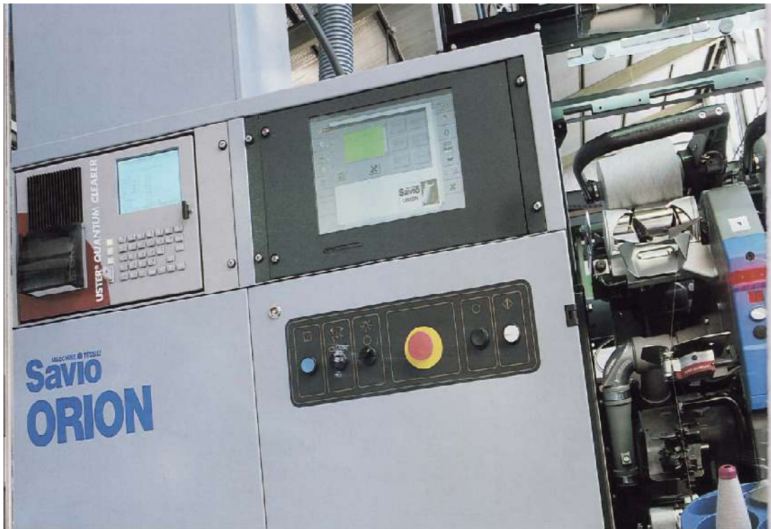
الشكل رقم (2) يبين الوحدة المركزية الحديثة في آلة تدوير البكر
