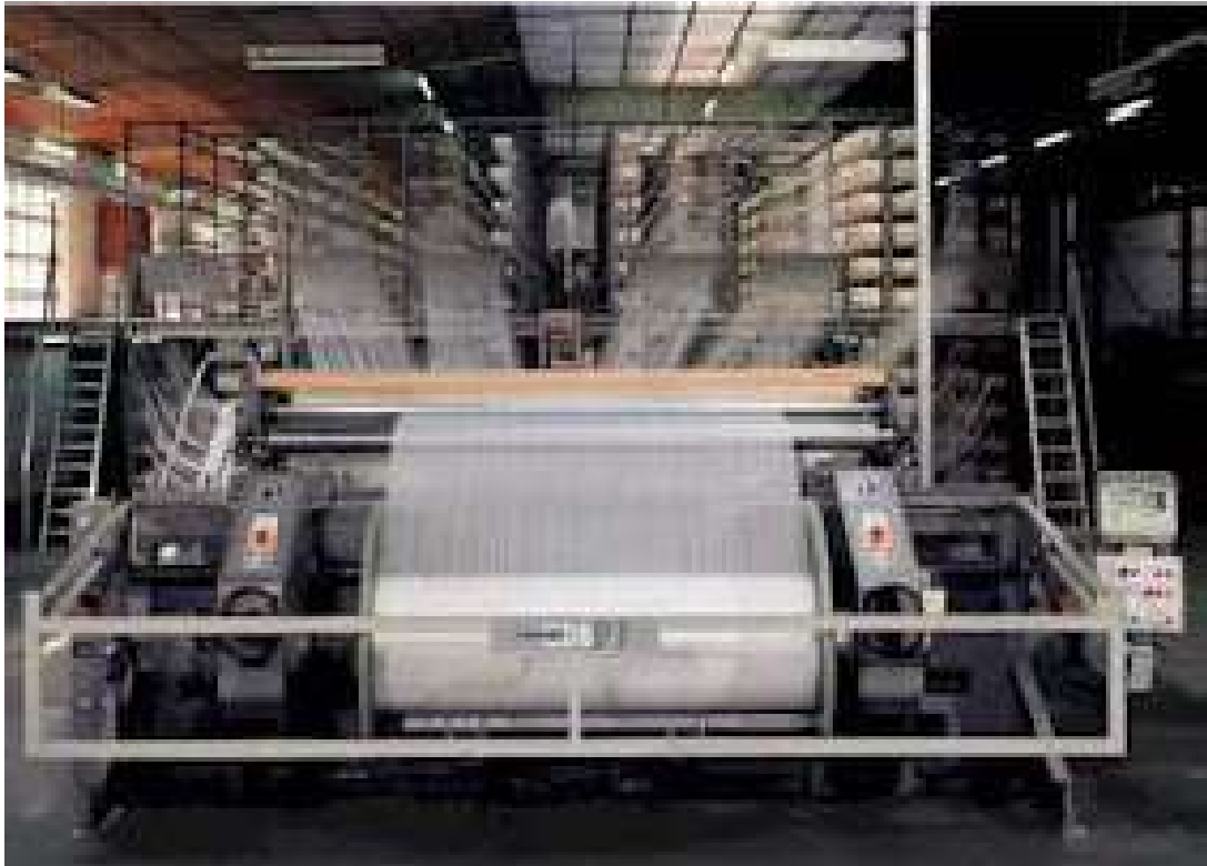
الشكل رقم (2) يبين احد أنواع آلة السداء المباشرة
