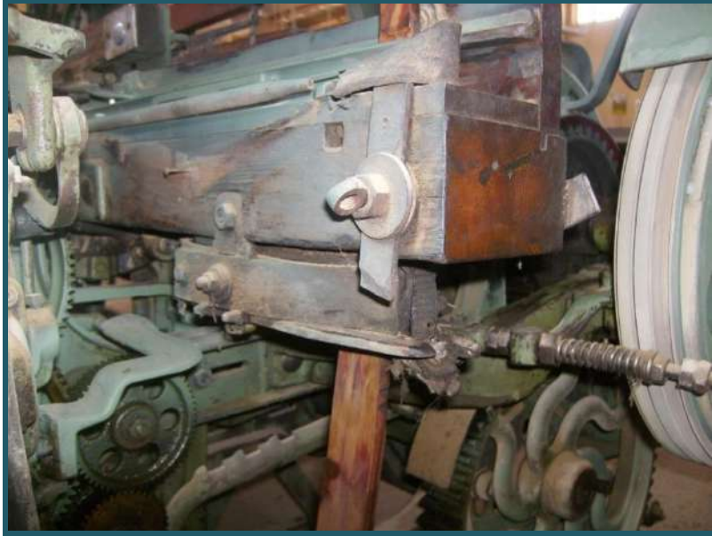
الشكل رقم ( 47-3 ) يبين عمل المصدات الآلية
