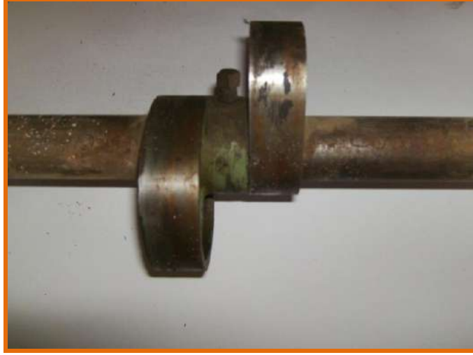
الشكل رقم ( 4-3 ) يبين الكامة مثبتة على المحور السفلي
