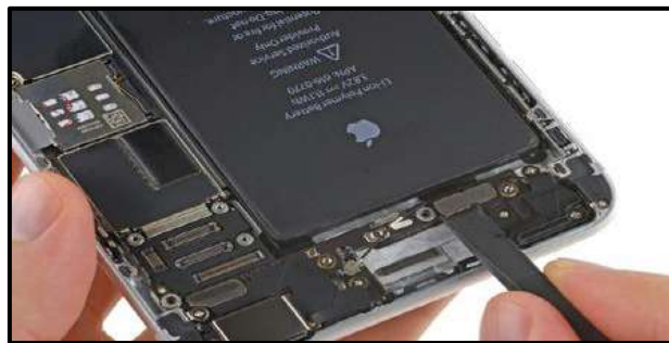
الشكل 27-2 س إزالة موصل كابل الزر Home وموصل كابل سيطرة الصوت
