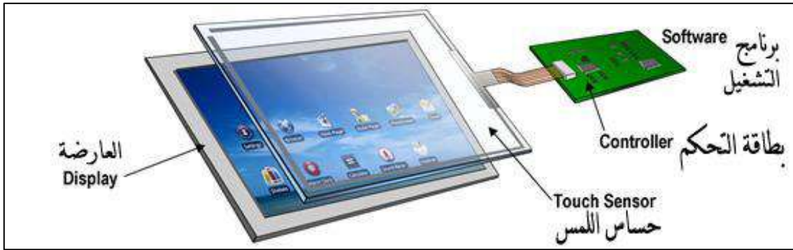
الشكل 1-71 آلية عمل شاشة اللمس Touch Screen
