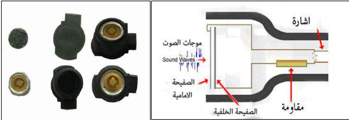
الشكل 1-65 مكونات الميكروفون السعوي وأنواع منه لهواتف مختلفة
