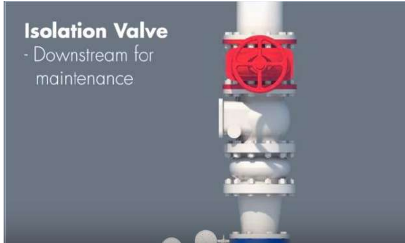
الشكل (1 - 39) ربط صمام العزل للتيار النازل لغرض الصيانة
