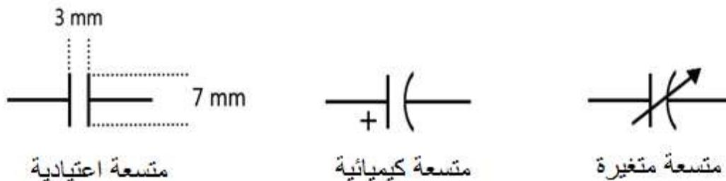
الشكل (11-1) رموز المتسعات الكهربائية
