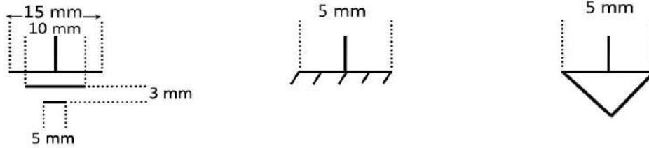
الشكل (1- 14) رمز الأرضي في الدوائر الكهربائية
