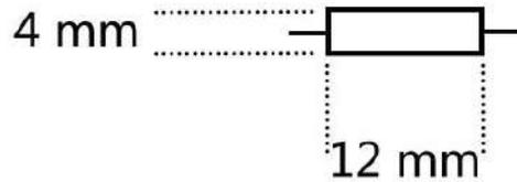
الشكل (1-9) رموز المقاومات الكهربائية
