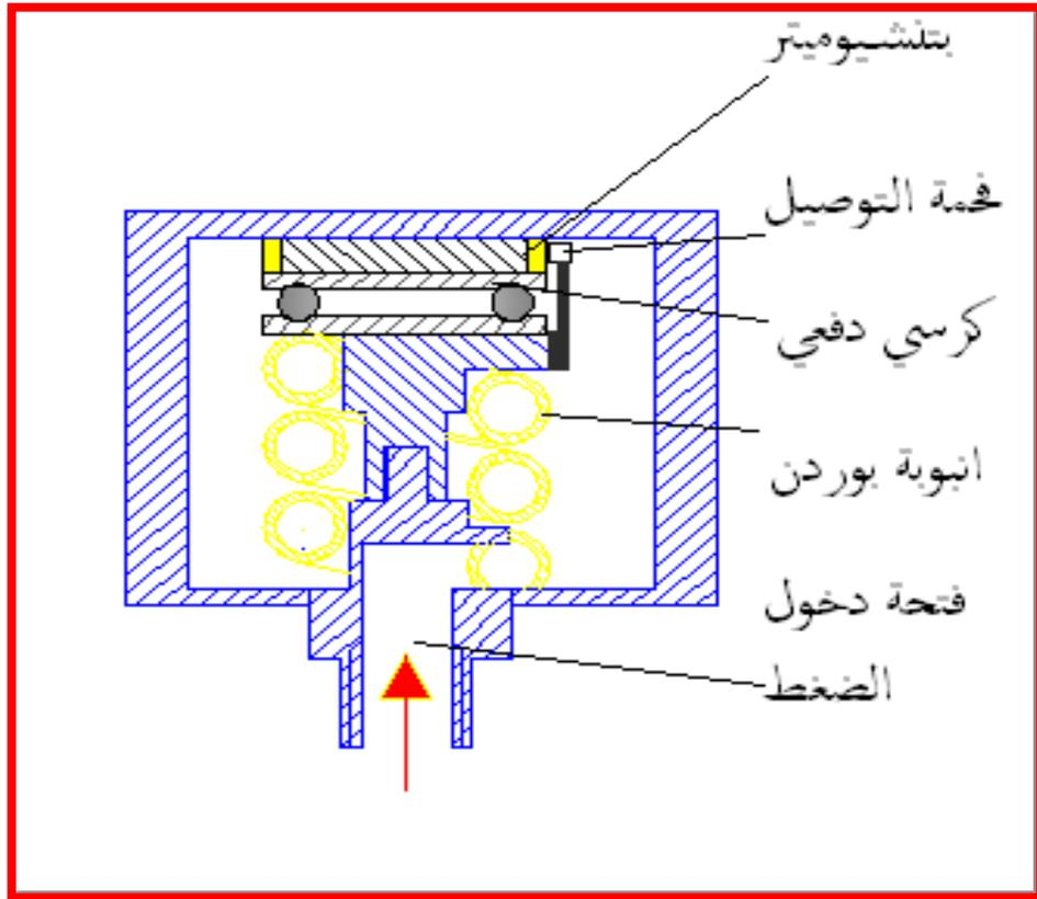
الشكل (5-8) حساس الضغط ذو أنبوبة بوردن الكهربائي
