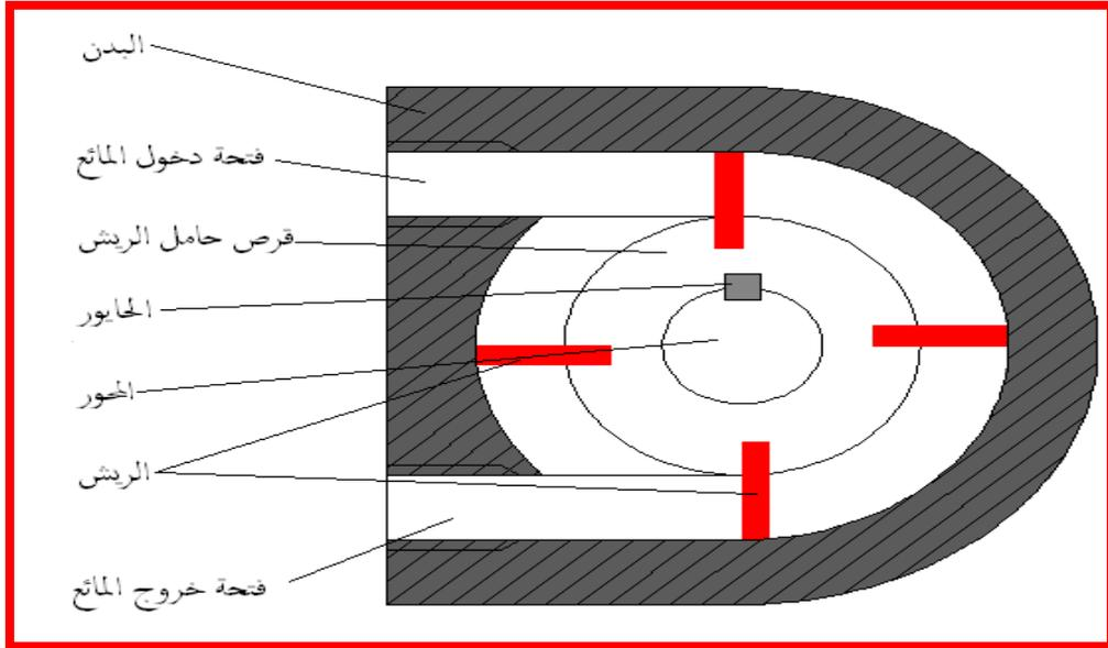
شكل ( 2-5 ) مقطع لمحرك هيدروليكي ذو الريش
