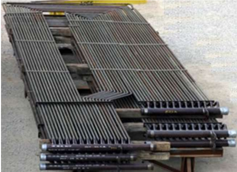
الشكل (13) يوضح مصفوفات أنابيب مهينة لصنع محمصاة بخار في مرجل أنابيب الماء
