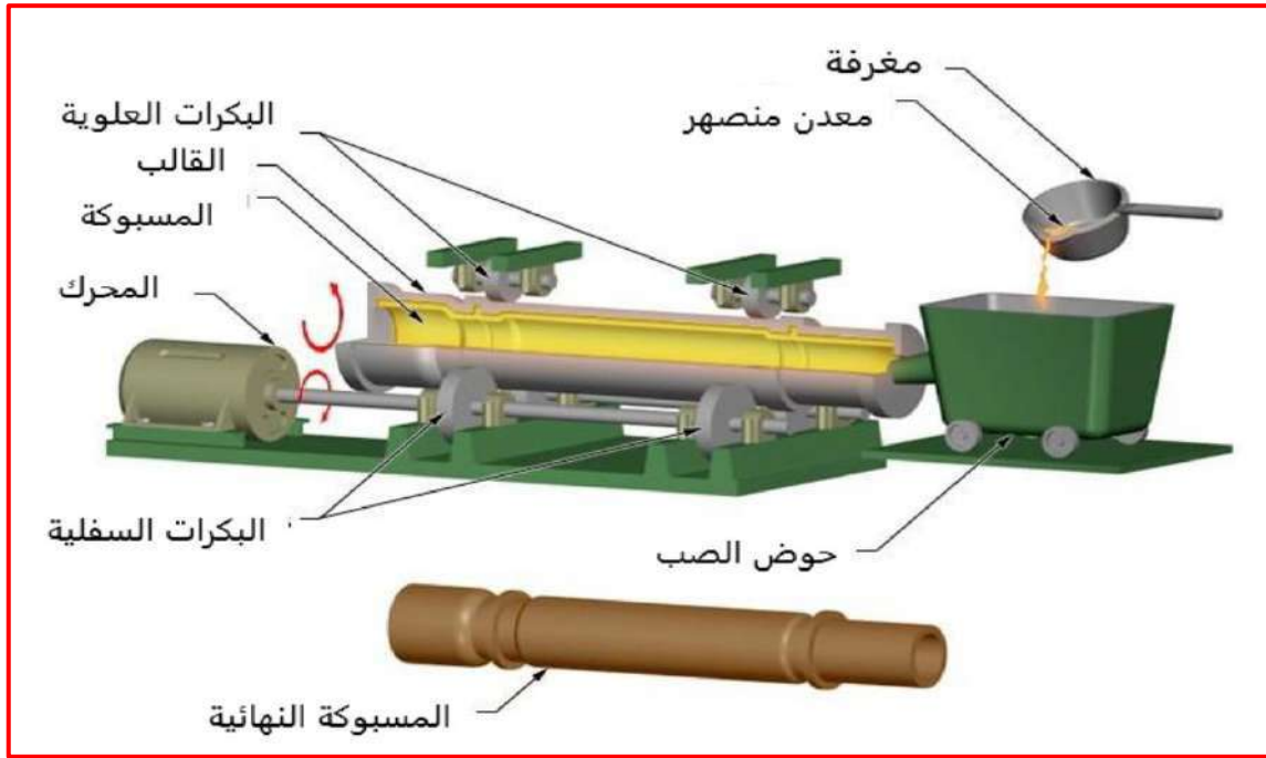
الشكل 1-3 ماكينة إنتاج أنبوب بطريقة سباكة الطرد المركزي (اثراني).
