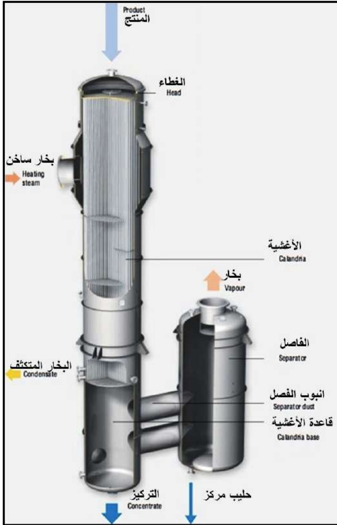
الشكل 2-3 : المبخّر ذي الغشاء الساقط الأنبوبي
