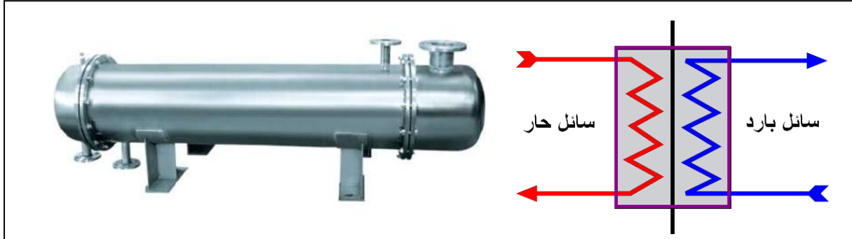
الشكل 3- 19: المبادل الحراري (نوع الصدفة والأنبوب)
