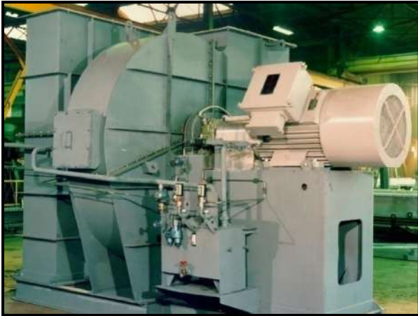
الشكل 2-21 : مضخة دفع الهواء ومسخنات هواء تعمل على الوقود السائل
