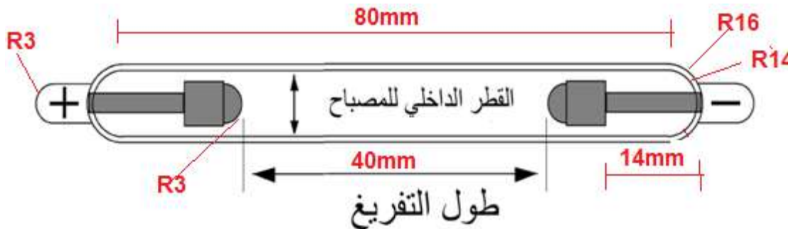
شكل (٢ - ٢٦) المصباح الوميضي الخطي المستخدم في منظومة ليزر الصبغ
