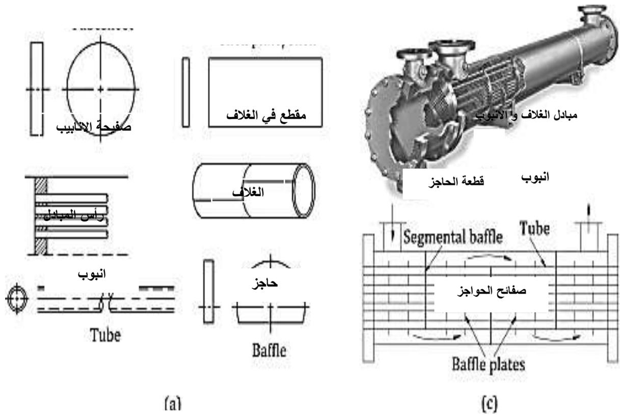
شكل ( 1 - 19 ) مقاطع في الأجزاء الرئيسية للمبادل الحراري ( لوحة ) مقياس الرسم 1:1
