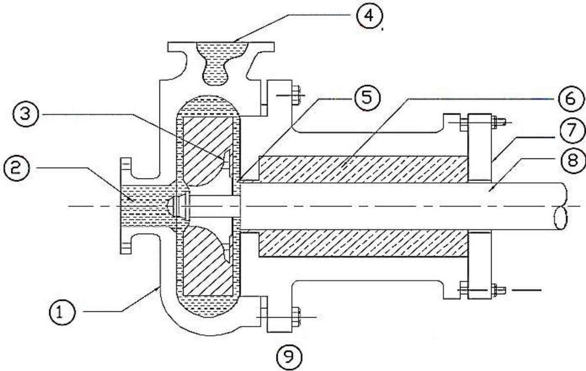
شكل (1 - 34) مقطع لمضخة طاردة مركزية (لوحة) مقياس الرسم 1 : 1
