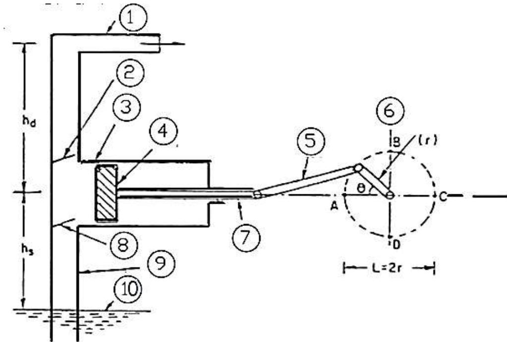
شكل (1 - 28) مقطع في المضخة الترددية أحادية الفعل أحادية المكبس (لوحة) مقياس الرسم 1: 1
