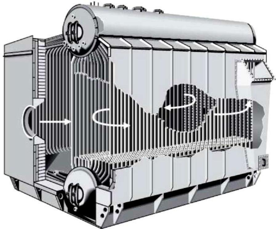
شكل ( 1 - 21 - A ) مخطط لمرجل بخاري يعمل بالزيت
