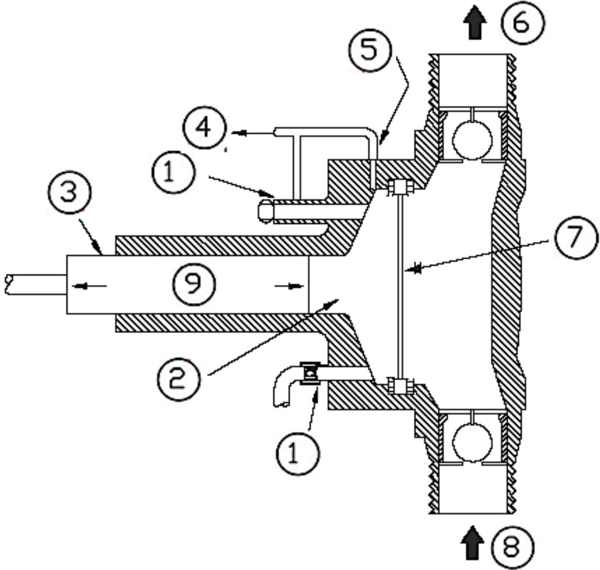
شكل (1 - 32) مقطع في المضخة ذات الغشاء (أحدى أنواع المضخات الترددية) (لوحة) مقياس الرسم 1:1
