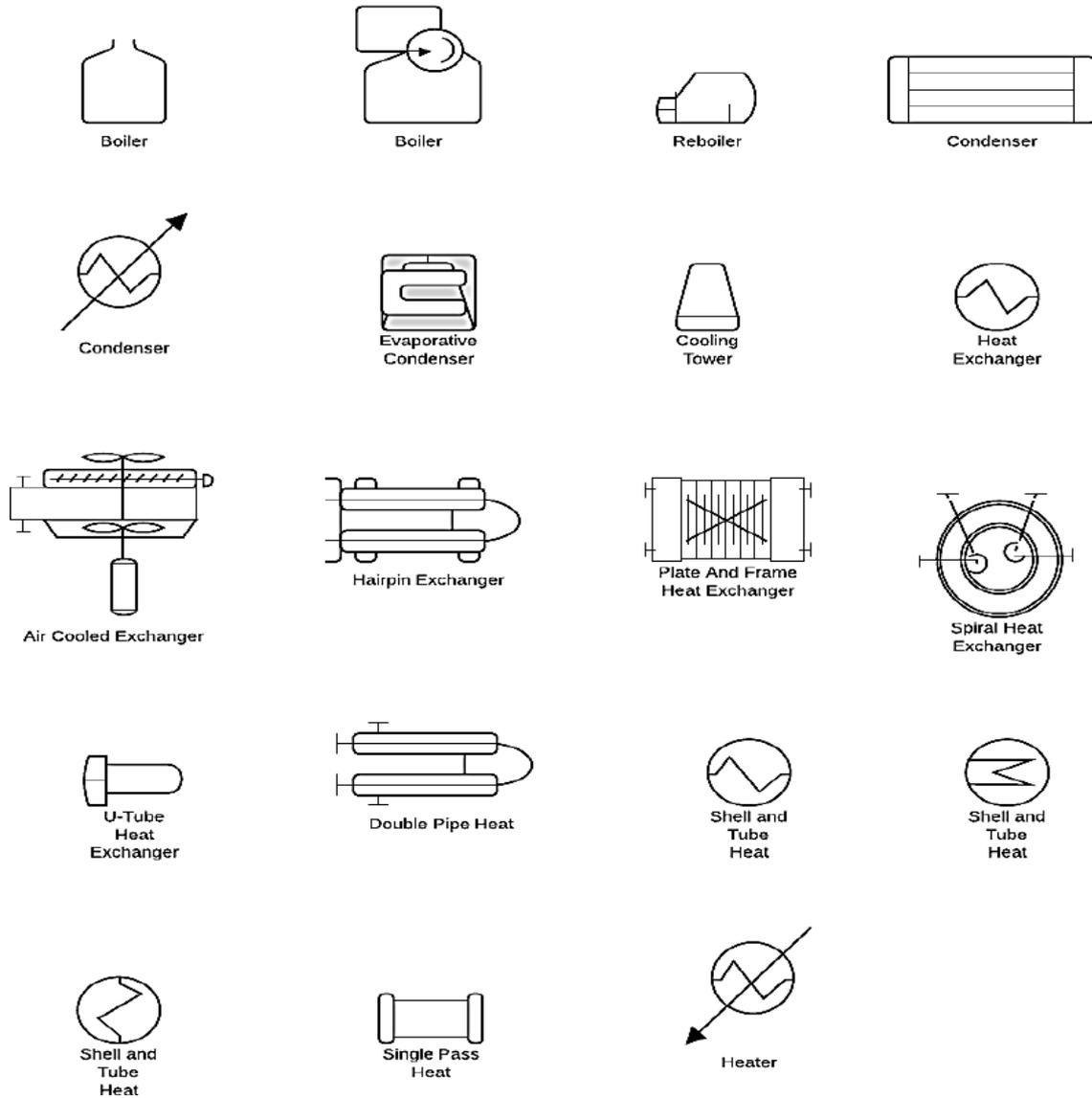
الشكل (3-1) رموز المبادلات الحرارية المستخدمة في مخططات الصناعة النفطية
