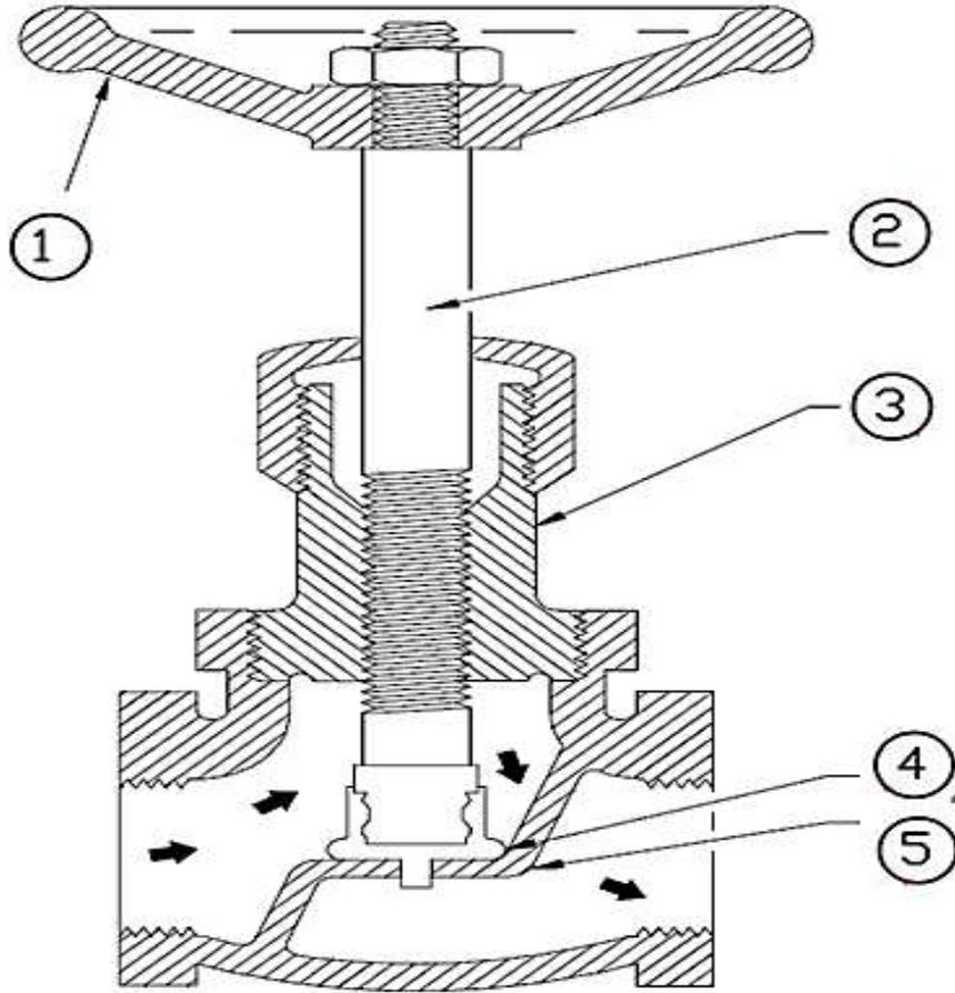
شكل ( 1 - 58 ) مقطع في جسم صمام كروي على شكل حرف ( Z ) ( لوحة ) مقياس الرسم 1:1
