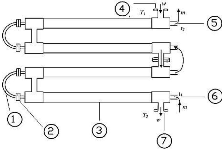
شكل (1 - 18) مخطط لمبادل حراري مزدوج الأنابيب (لوحة) مقياس الرسم 1 : 1
