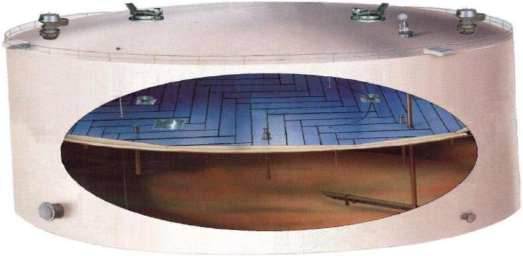
الشكل (1-46) خزان ذي سقف داخلي عائم وسقف خارجي ثابت
