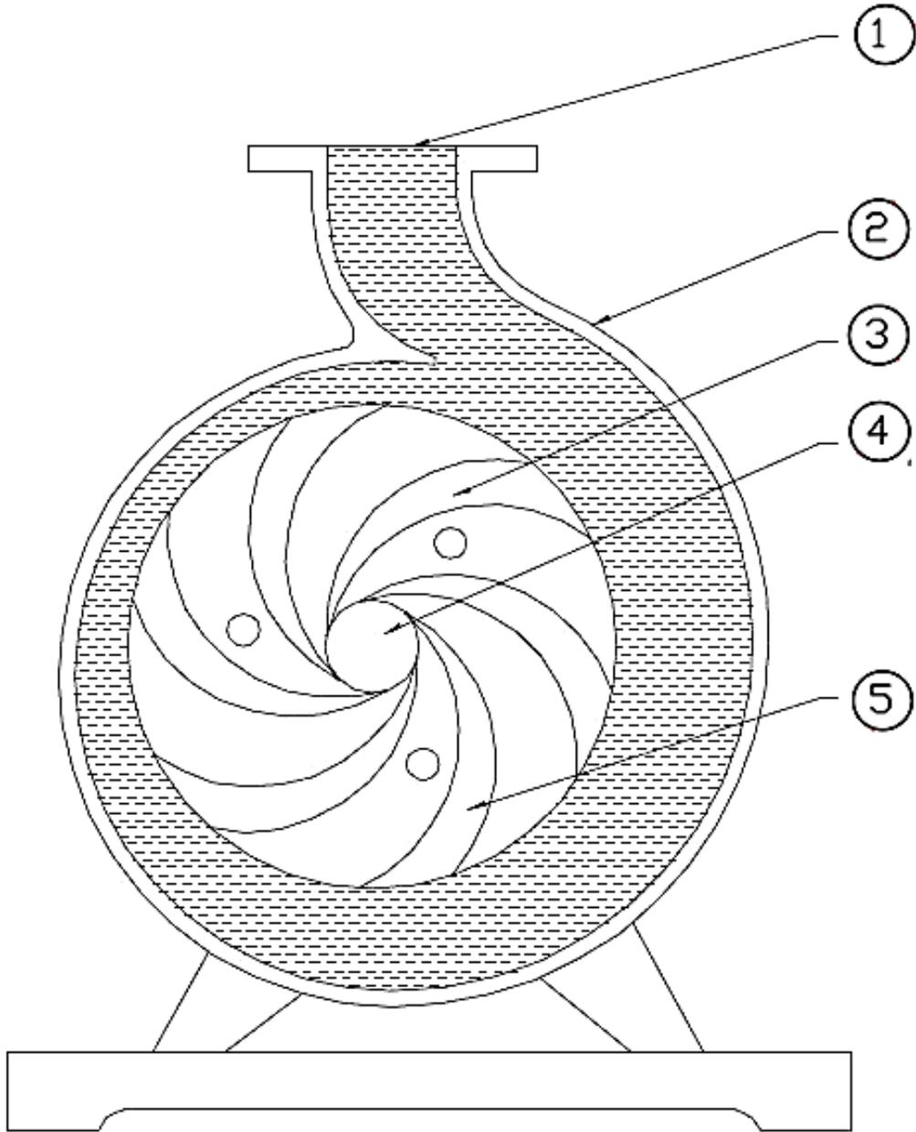
شكل (1 - 35) مخطط لمضخة طاردة مركزية يبين حركة السائل داخلها (لوحة) مقياس الرسم 1 : 1
