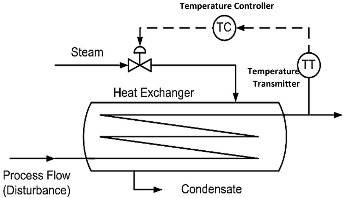
الشكل ( 10-1 ) مخطط السيطرة على درجة حرارة مبادل حراري (لوحة), مقياس الرسم 1:1
