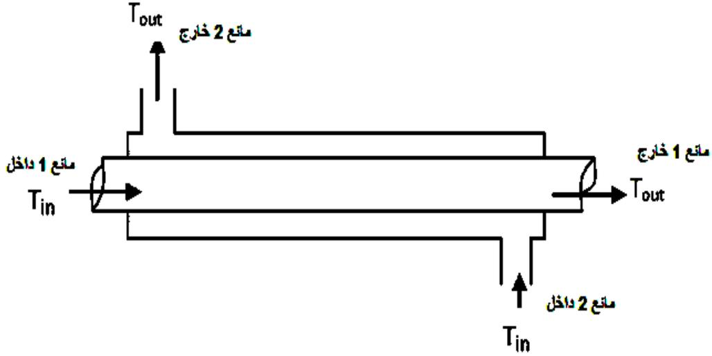
شكل (1- 17) مخطط لمبادل مزدوج الانابيب ذي نمط تدفق متعاكس (Counter-current) (لوحة) مقياس الرسم 1 : 1
