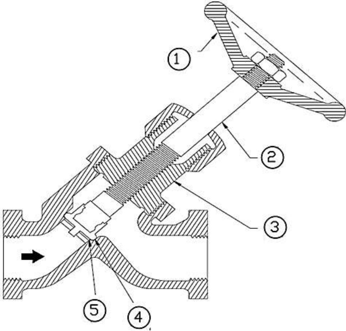
شكل (1- 59) مقطع في جسم صمام كروي مائل الزاوية (لوحة) مقياس الرسم 1 : 1
