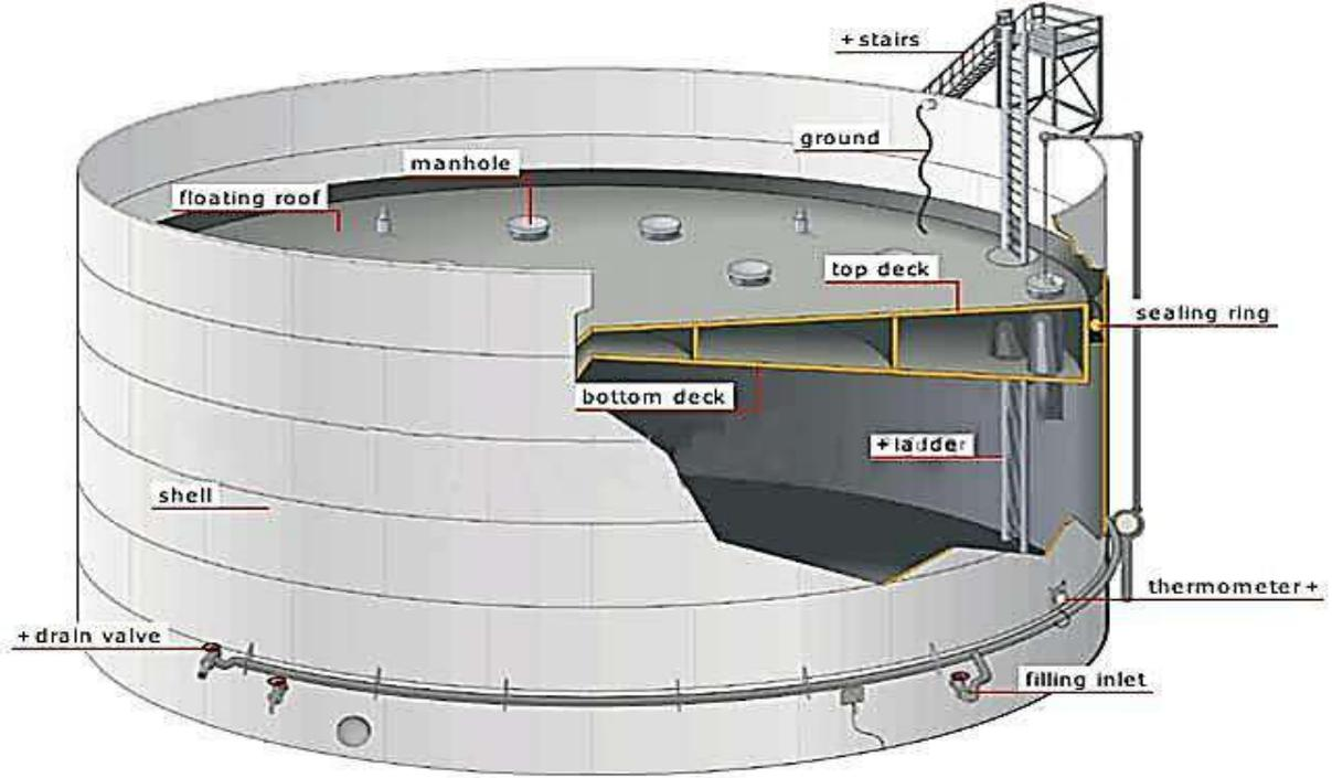
الشكل ( 48-1 ) مجسم لخزان ذي سقف عائم مزدوج وبدون سقف خارجي ثابت
