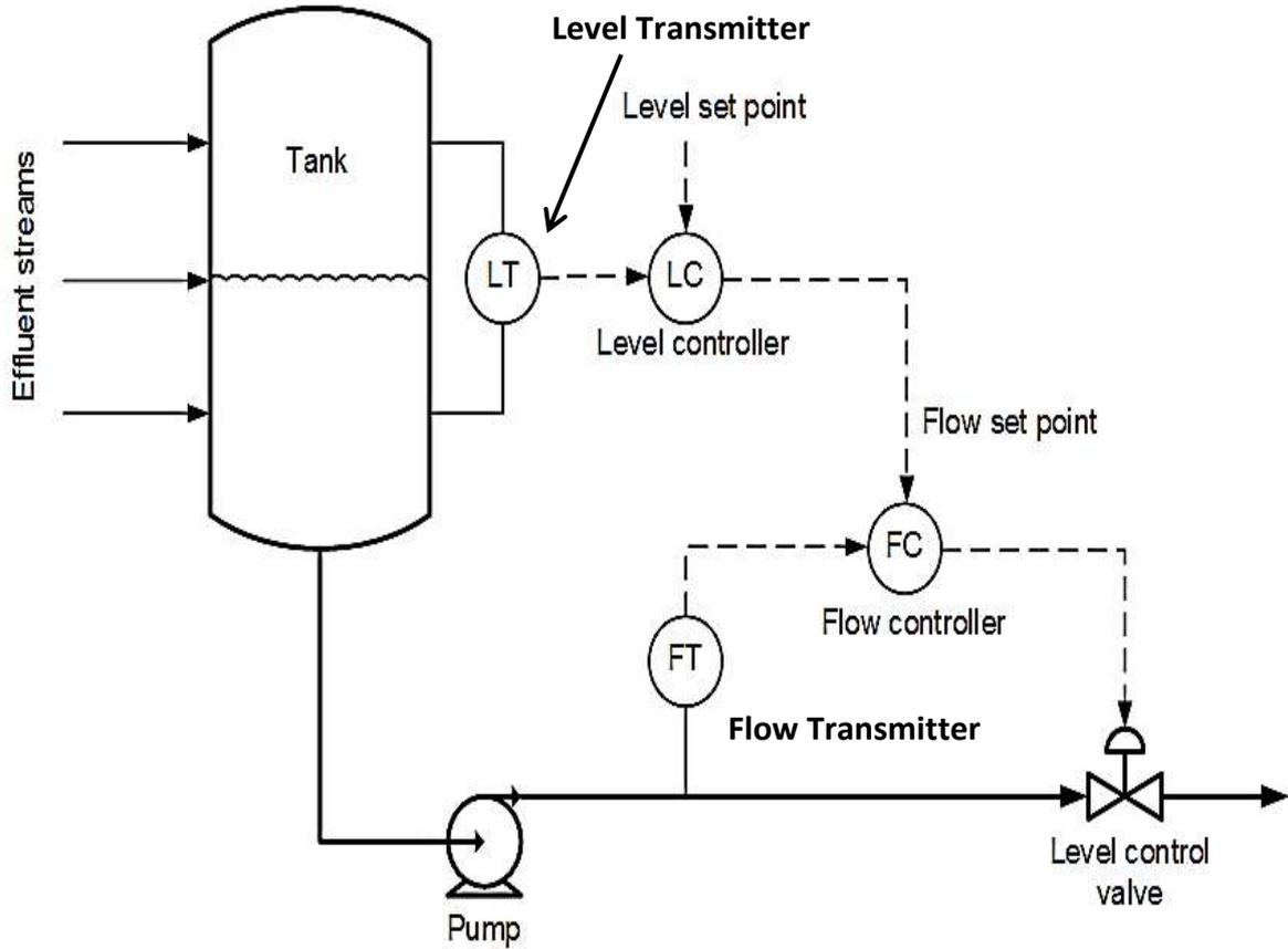
الشكل ( 11-1 ) مخطط السيطرة على مستوى السائل في خزان (لوحة) مقياس الرسم 1 : 1
