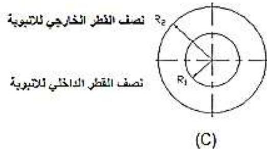
شكل (1 - 20) المبادل الحراري ذو الأنابيب المزدوج (لوحة) مقياس الرسم 1 : 1
