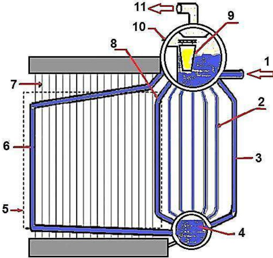
الشكل ( 1- 23 ) مخطط يوضح أجزاء وطريقة عمل المرجل البخاري (اثنائي)
