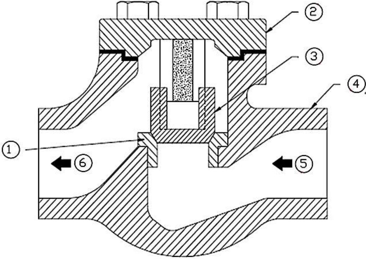
الشكل ( 1 - 64 ) مقطع في صمام الاتجاه الواحد (أحد أنواع الصمام البوابي) (لوحة) مقياس الرسم
