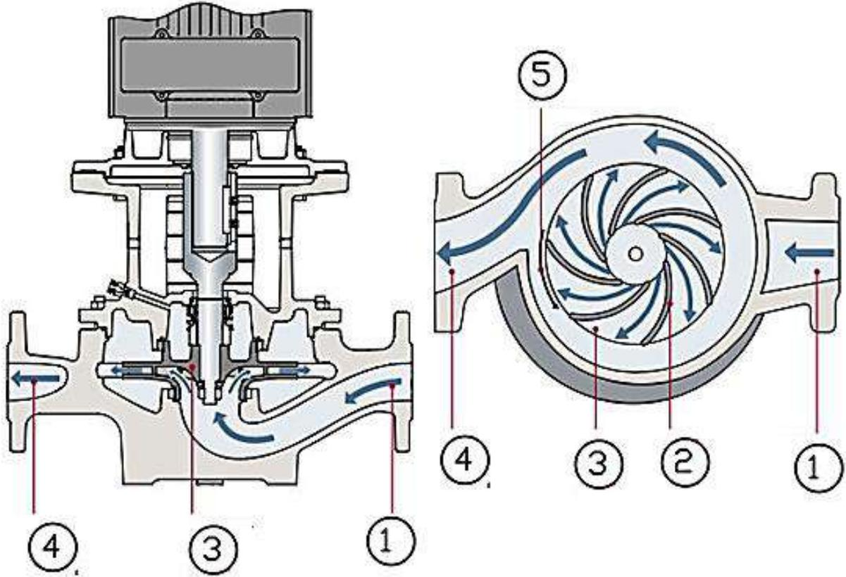
شكل (1 - 33) رسم توضيحي للمضخة الطاردة المركزية (اثنائي)
