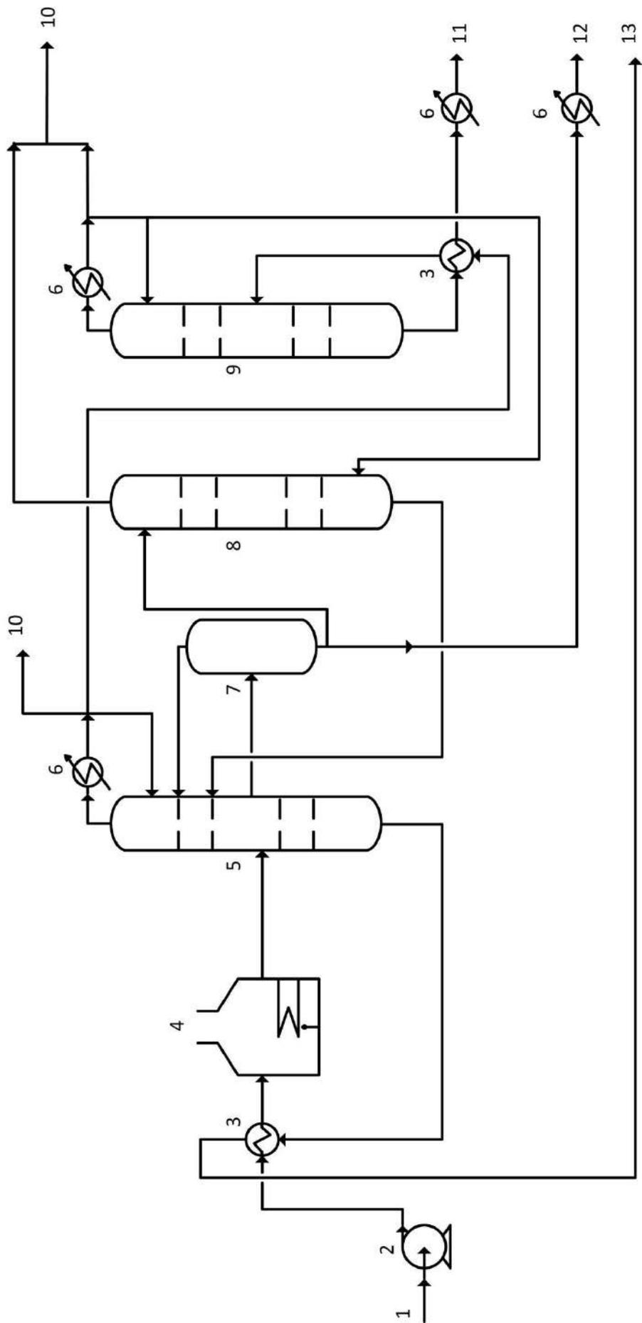
شكل (5-2) المخطط التدفقي لعملية كسر أو خفض اللزوجة (لوحة) مقياس الرسم 1:1
