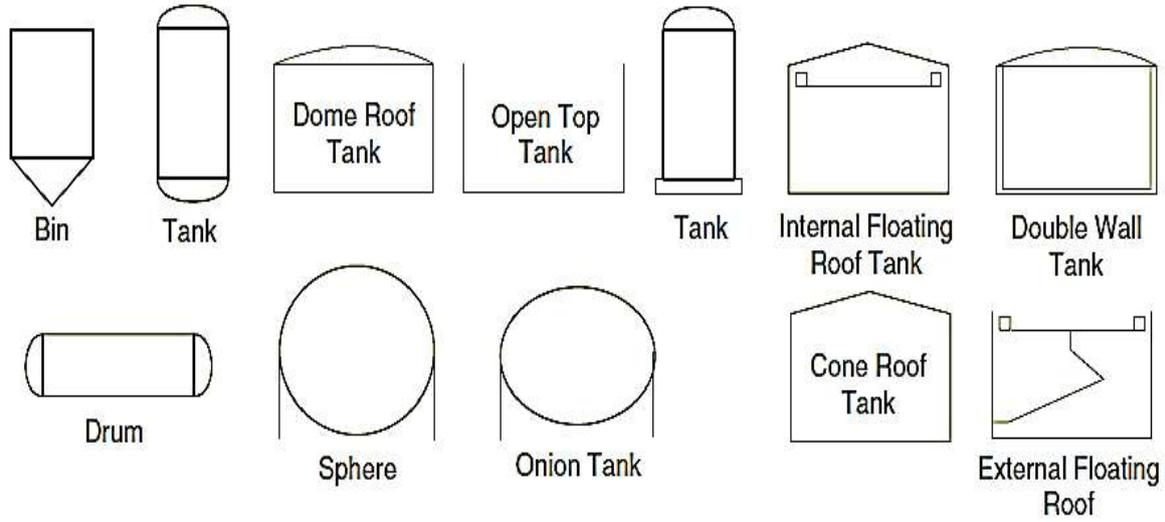
الشكل (4-1) رموز الخزانات المستخدمة في مخططات الصناعة النفطية
