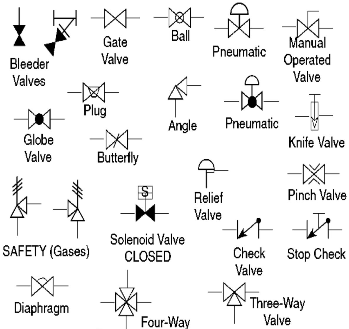
الشكل (7-1) رموز الصمامات المستخدمة في مخططات الصناعة النفطية
