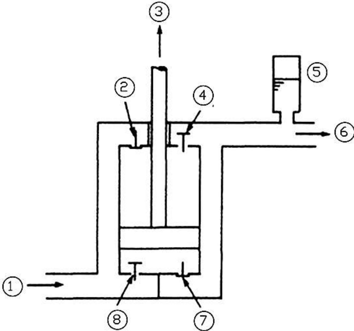
شكل (1 - 31) مخطط المضخة ذات المكبس (احدى أنواع المضخات الترددية) (لوحة) مقياس الرسم 1 : 1
