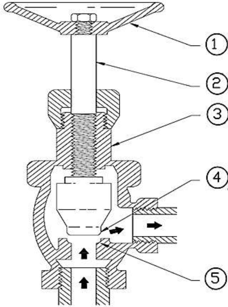
شكل (1 - 60) مقطع في جسم صمام كروي على شكل حرف ( Y ) (لوحة) مقياس الرسم 1 : 1
