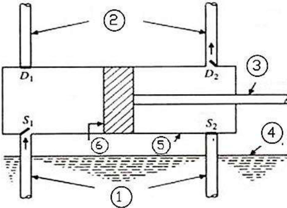
شكل (1 - 30) مقطع في المضخة الترددية ثنائية الفعل أحادية المكبس (لوحة) مقياس الرسم 1 : 1
