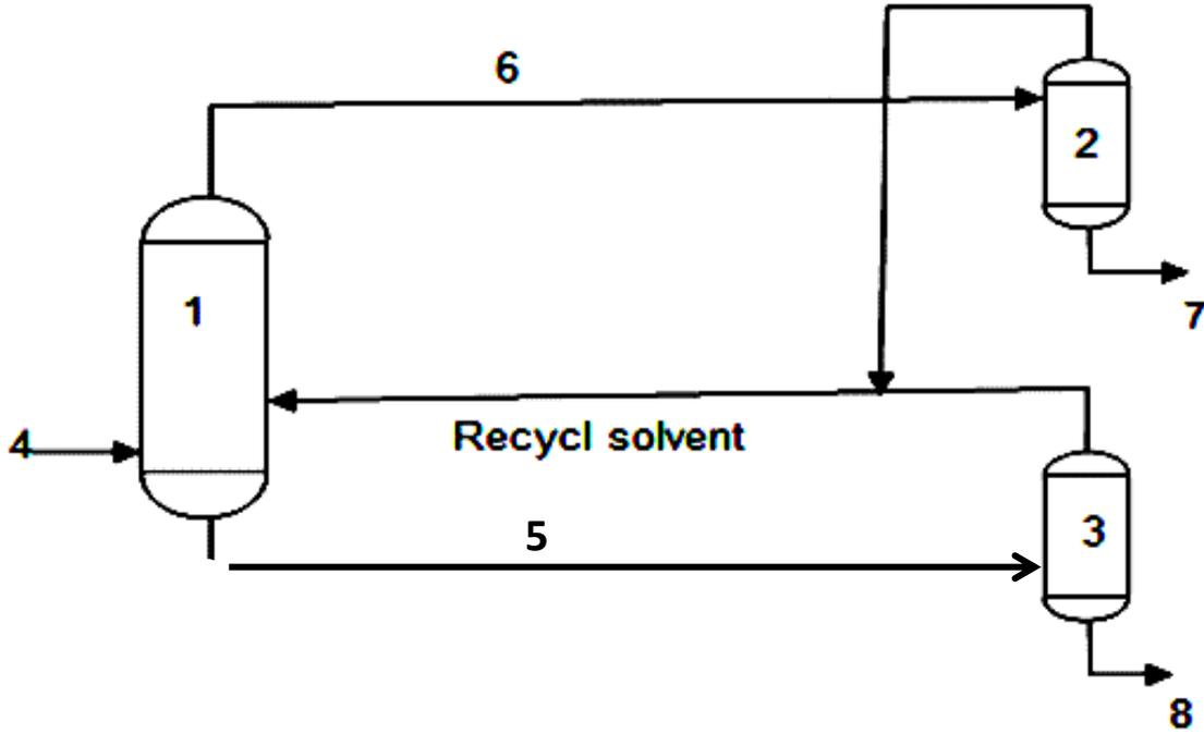
شكل ( 2 - 3 ) مخطط يمثل عملية الاستخلاص بالمذيب (لوحة) مقياس الرسم 1 : 1
