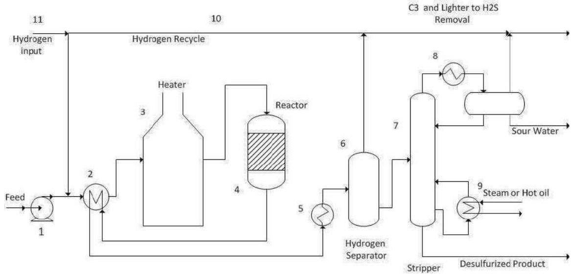
شكل ( 1 - 2 ) المخطط التدفقي لعملية إزالة الكبريت من المشتقات النفطية بواسطة الهيدروجين (لوحة) مقياس الرسم 1 : 1
