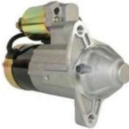
شكل ( 1 - 3 ) بادئ الحركة في السيارة ( السلف )
