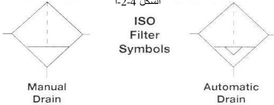
الشكل 4 - 2 - ب يبين مرشحات الهواء المضغوط التلقائي والأتوماتيكي
