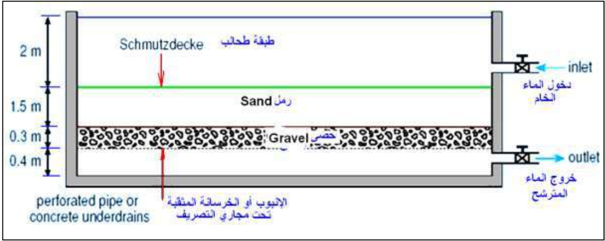
الشكل 3-4 : مقطع طولي أمامي لمرشح رملي بطيء (لوحة للرسم)
