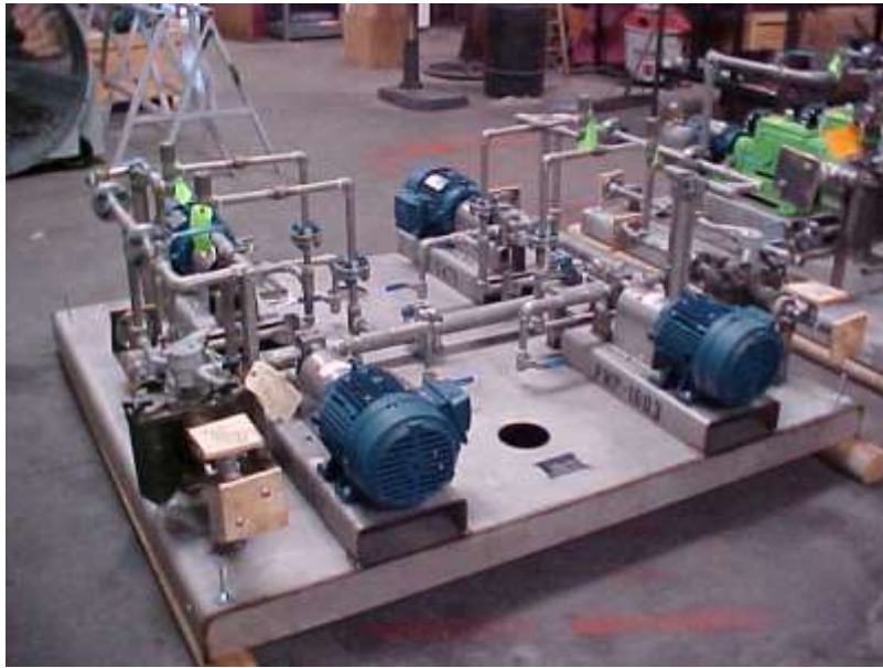
الشكل 11-3 : مضخات مربوطة ربطاً مزدوجاً (Series-Parallel Pump).
