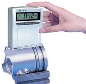
الشكل 4-3: جهاز الكتروني لفحص الخشونة
