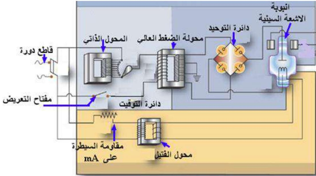
**شكل 1-1 مخطط مكونات جهاز الأشعة السينية**
