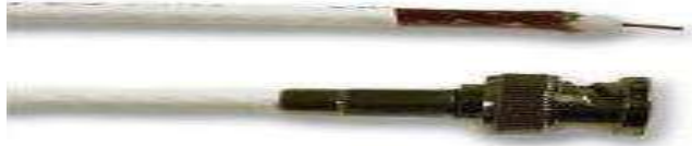
شكل (٢ - ٤) يوضح الموصلات المحورية الرقيقة المستخدمة في الربط الشبكي 10Base2 مع مقبس الربط BNC
