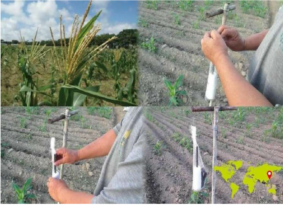
الشكل 1-8 يوضح طرائق ووضعية تركيب شبكات التحسس في المجال الزراعي
