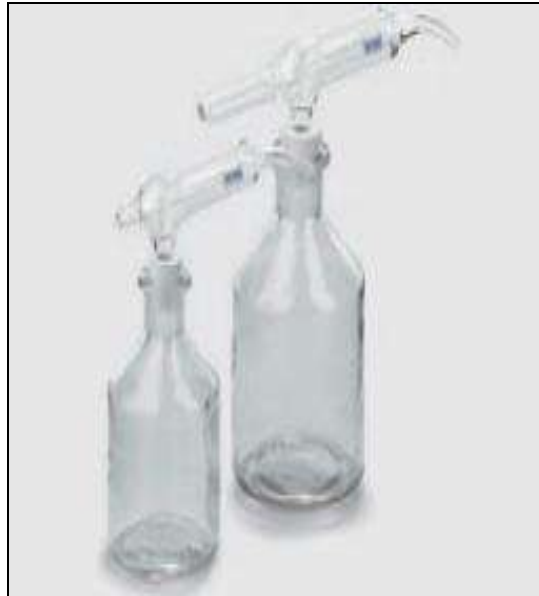
الشكل (ع-2-3) قنينة قياسية لإضافة كمية قياسية من الحامض أو الكحول الاميلي
