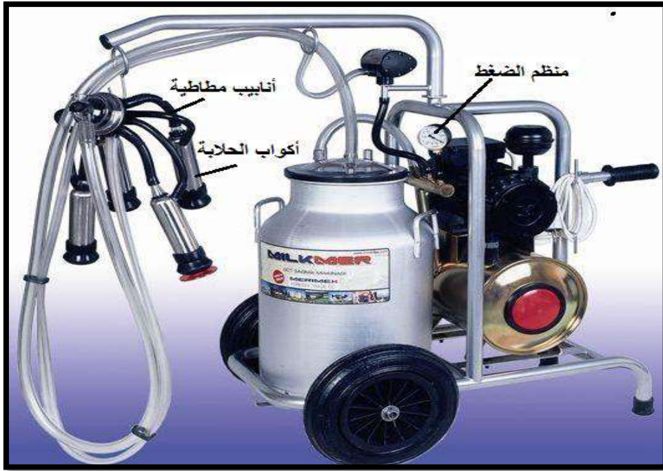
الشكل (4-3) أجزاء جهاز الحلب الآلي
