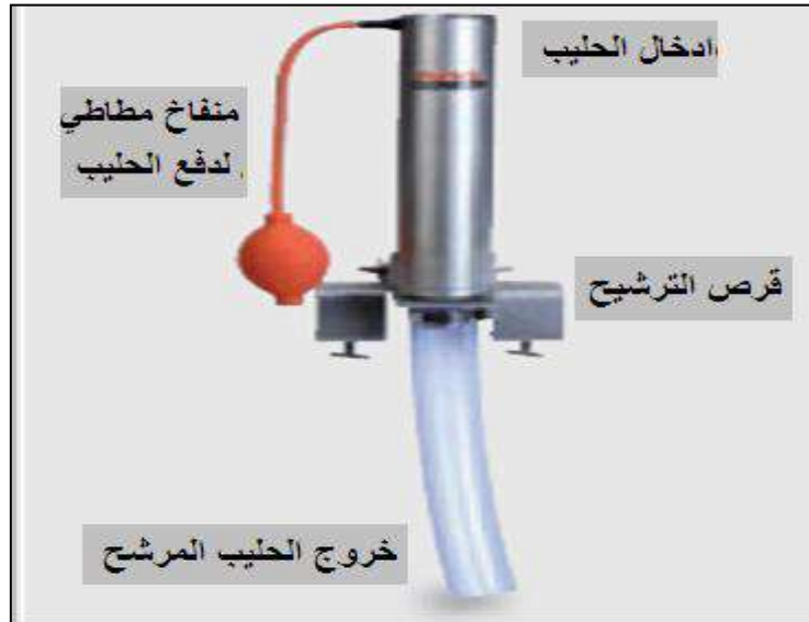
الشكل (ع - 4 - 1) جهاز فحص الشوائب
