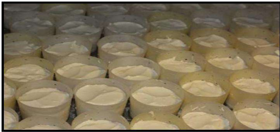
الشكل (5-9) تعبئة خثرة الجبن بقوالب مثقبة
