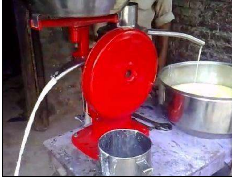
الشكل (ع-5-2) كيفية إجراء عملية الفرز
