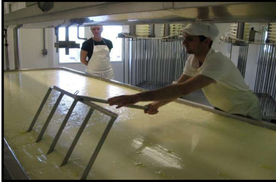
الشكل (9-3) تقطيع الخثرة بالسكاكين الطولية
