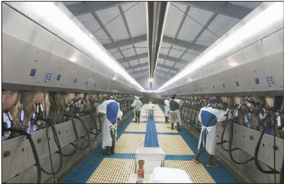
الشكل ( 4-2 ) قاعة كبيرة لإجراء الحلب الآلي لقطيع من الأبقار
