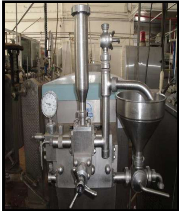
الشكل (6-7) جهاز تجنيس الحليب ومخطط لعملية التجنيس
