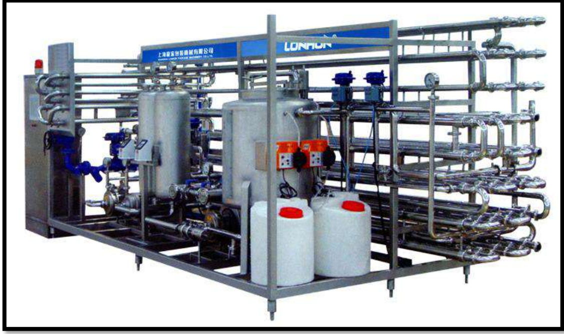
الشكل (6-8) جهاز التعقيم السريع بالحرارة فوق العالية
