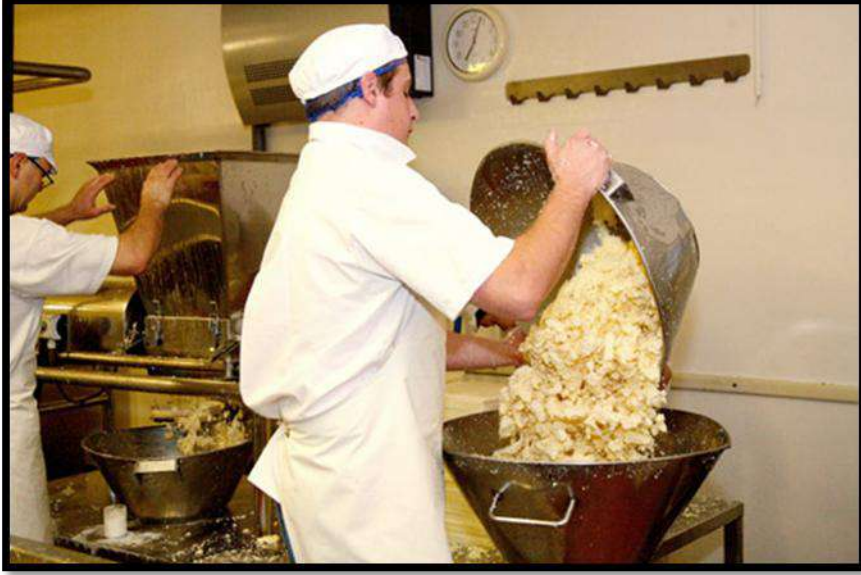
الشكل (ع - 7-2) عملية ثرم الأجبان مرحلة اولية من مراحل صناعة الجبن المطبوخ
