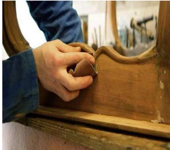
شكل (3-23) يوضح عملية التنعيم والانتهاء السطحي لأثاث من مادة الخشب
