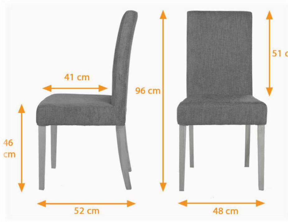
شكل (6-13) يوضح الابعاد القياسية لنوع من كراسي الطعام
