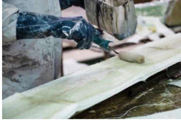
الشكل (5-19) يوضح التصفيح بالألياف الزجاجية
