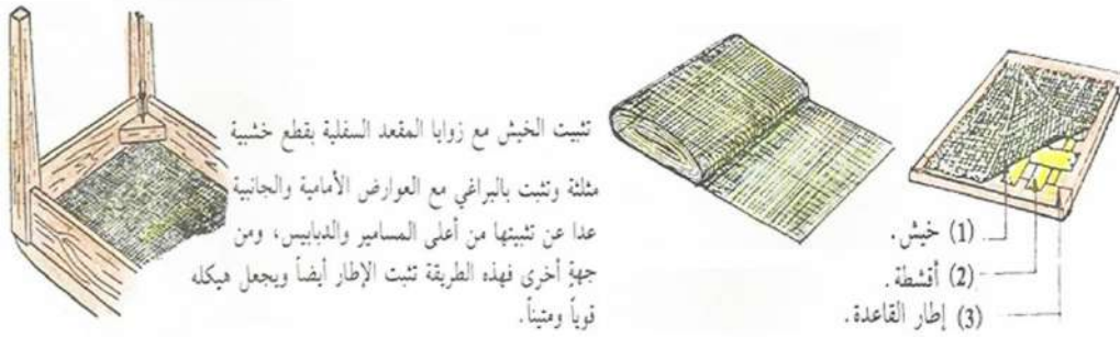
شكل (4-22) شكل قماش الخيش وطريقة تثبيته
