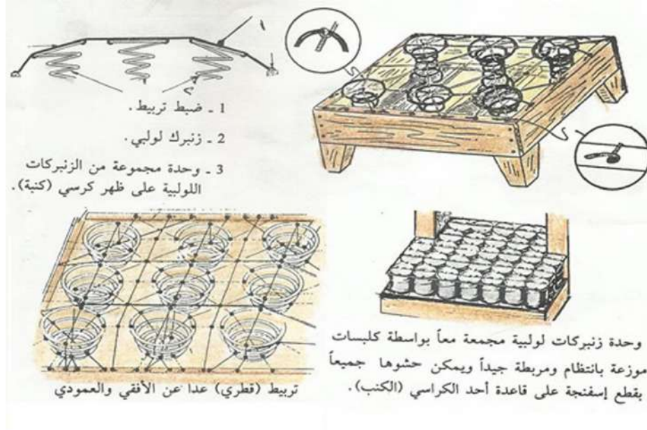
شكل (4-49) كيفية تركيب النوابض
