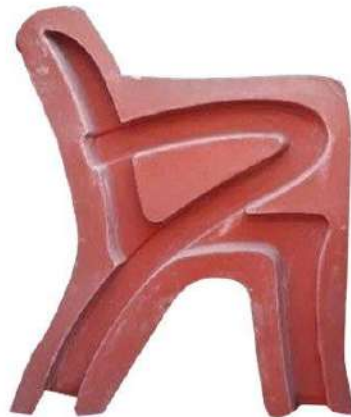
الشكل (5-18) يوضح القولية بالألياف الزجاجية لكرسي
