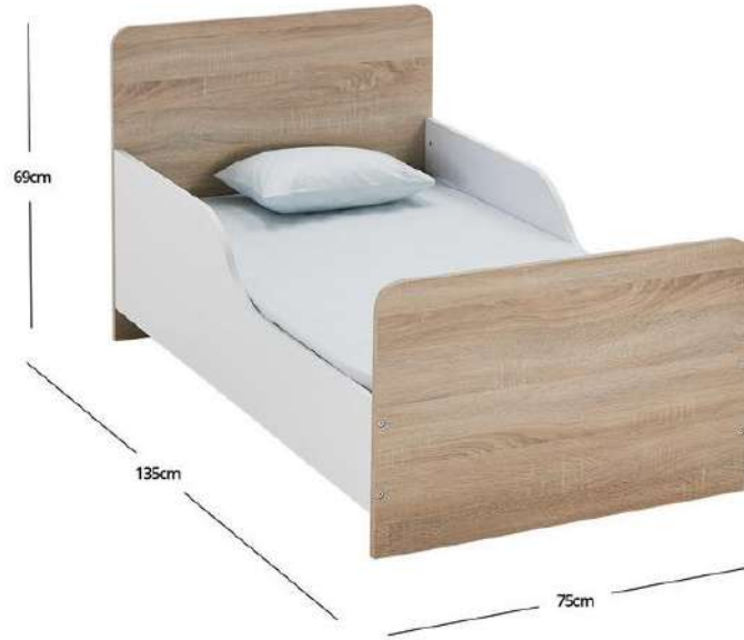
شكل (7-23) يوضح المقاسات الاساسية لسرير الطفل
