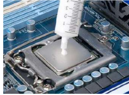
الشكل (7-3) العجينة الحرارية نوع سيلكون
