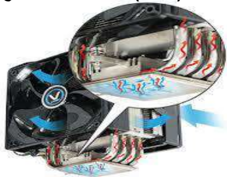
الشكل (11-3) المبدد الحراري مع مروحة
