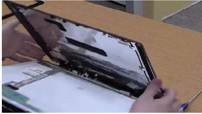
8- افصل كيبيل LCD كما موضح بالشكل الآتي:
