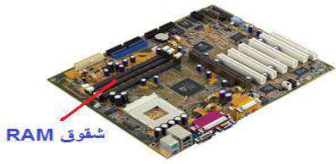
الشكل (6-1) شقوق ذاكرة الوصول العشوائي
