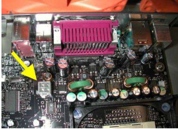
الشكل (1-2) لوحة أم نوع (D865PERL) مع ( Jumper )
