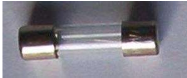
الشكل (5-21) الفاصم ( الفيوز ) داخل جهاز القدرة في الحاسوب
