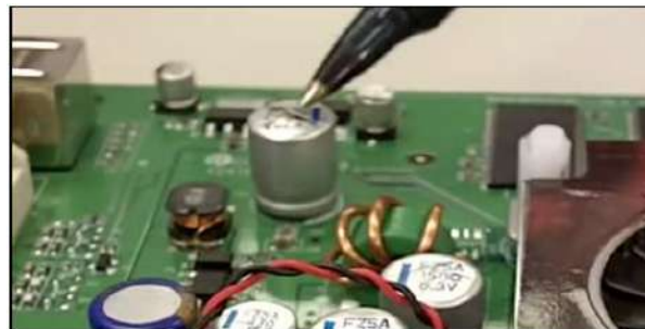
الشكل (4-2) شكل متسعة منتفخة
