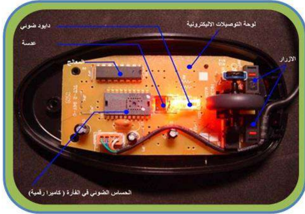
الشكل رقم (4 - 31) يوضح المكونات الداخلية للفأرة الضوئية
