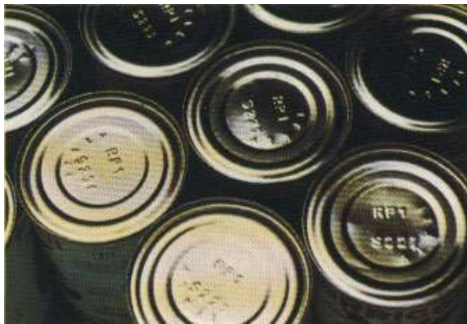
شكل (37) اكمال شكل العلب المعدنية بكبس الاغطية
