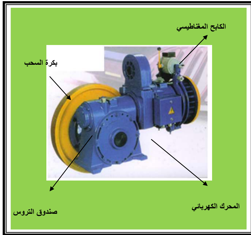
شكل رقم (9-1) ماكينة سحب ذات تروس
