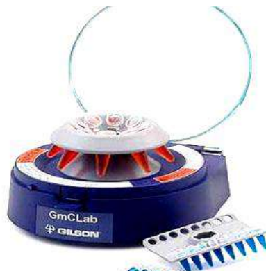
شكل 17 - 8 جهاز الطرد المركزي مع حاويات المحلول. شكل 17 - 9 الانبوبة الحاوية على المحلول بعد تفكيك اجزائه
