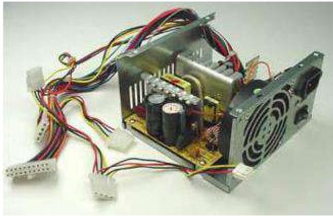
الشكل ( 4 - 5 ) مصدر الطاقة الكهربائية
