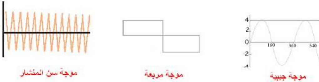
الشكل ( 1 - 4 ) أشكال موجات التيار المتناوب
