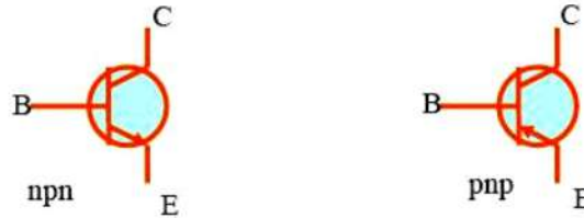
شكل 2-31 أطراف الترانزستور الثنائي القطبية بنوعيه
