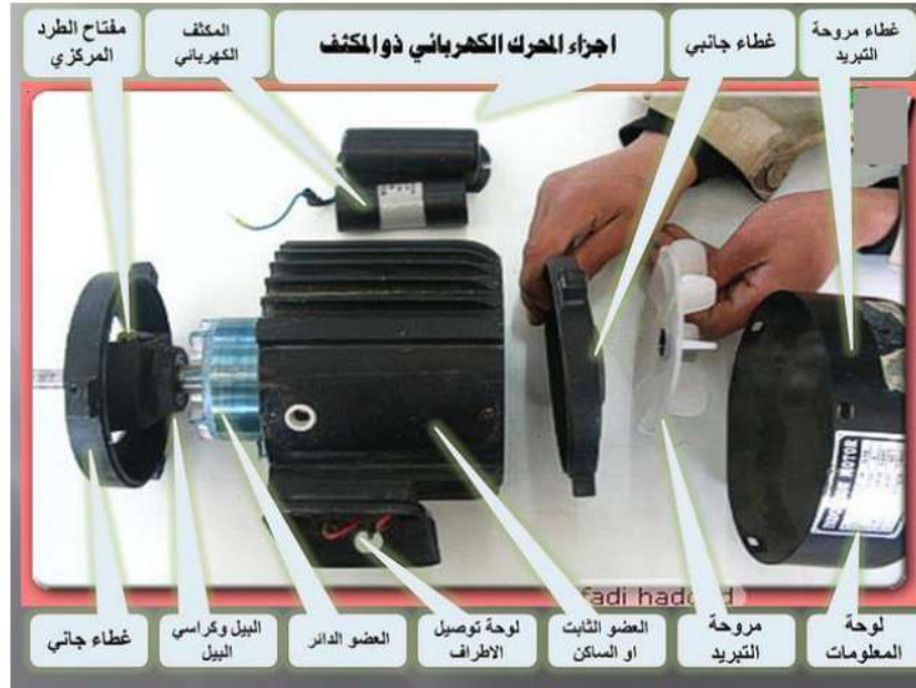
شكل 4-5 أجزاء محرك كهربائي ذو مكثف
