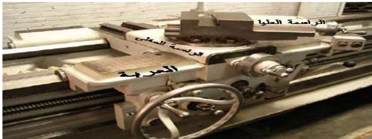
شكل (7-17) يوضح العرببة وتحمل الراسمتين العليا والسفلى
