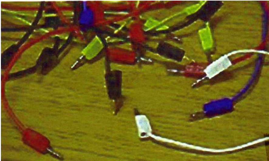
شكل ( 1 - 18 ) يمثل العوازل المستعملة مع الأسلاك الكهربائية
