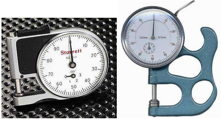
شكل ( 1 - 22 ) يوضح ساعة القياس ذات فكي القياس
