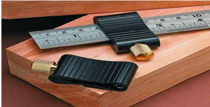
شكل رقم ( 1 - 6 ) يوضح مسطرة لقياس العمق مع الجزء المنزلق
