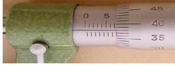
شكل ( 1 - 19 ) يوضح تدريج الميكرومتر
