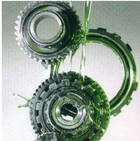
شكل ( 4 - 6 ) يوضح عمل الترس باستعمال بالزيت
