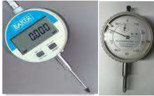
شكل ( 1 - 20 ) يوضح ساعة القياس بنوعيهما الرقمية والميكانيكية
