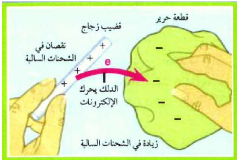
شكل (2-5) يوضح انتقال الشحنات بالدلك
