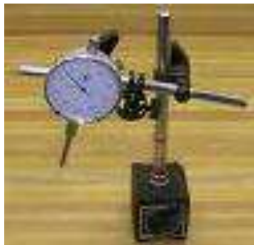
شكل ( 1 - 21 ) يوضح تثبيت ساعة القياس على الحامل ذي القاعدة المغناطيسية
