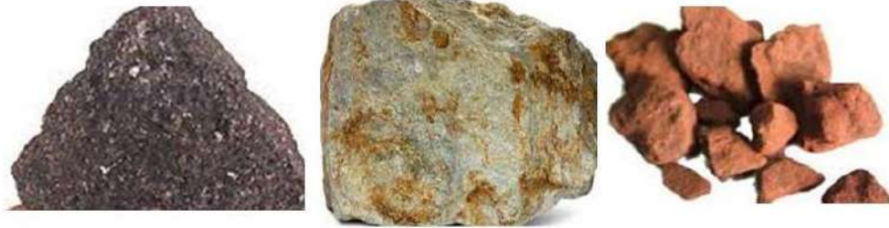
شكل رقم ( 5 - 1 ) يوضح خامات الحديد ( من اليمين الى اليسار الهيماتيت ، الليمونيت ، المكنتايت )
