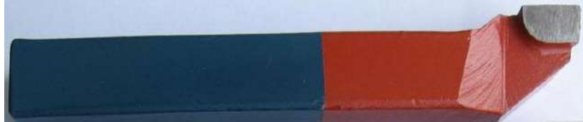
شكل رقم ( 7 - 29) يوضح أحد أشكال اللقم الكربيدية مثبتة على نصاب القلم
