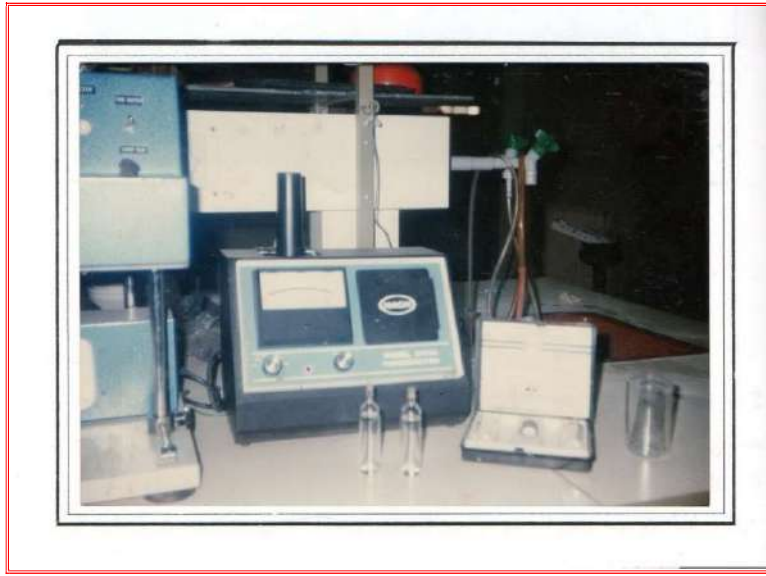
شكل 9-2 جهاز تحديد كمية المخثرات المطلوب إضافتها لمعالجة عكارة المياه
