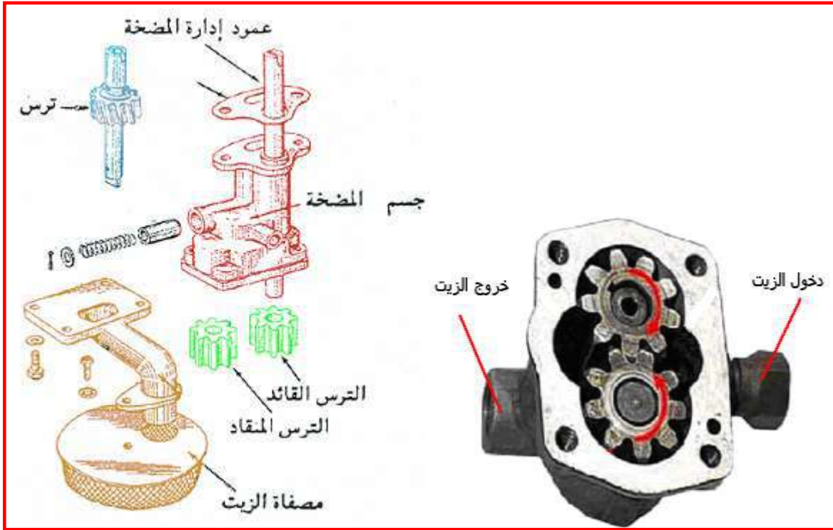
شكل 10-6 مضخة الزيت ذات التروس
