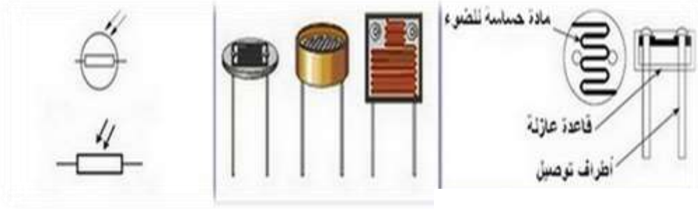
شكل 9-1 يوضح المقاومة الضوئية والرمز الهندسي لها
