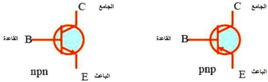
شكل 2-31 أطراف الترانزستور الثنائي القطبية بنوعيه
