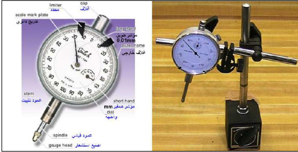
الشكل 1-32 : أجزاء ساعة القياس وطريقة التثبيت.
