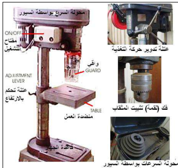
الشكل 4-32 : أجزاء المثقب العمودي.
