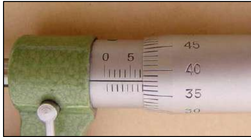
الشكل 1-23 : قراءة قياس ميكروميتر الأبعاد الخارجية.
