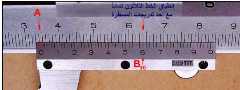
الشكل 1-15 : قراءة ورنية ذات دقة قياس (0.02mm).
