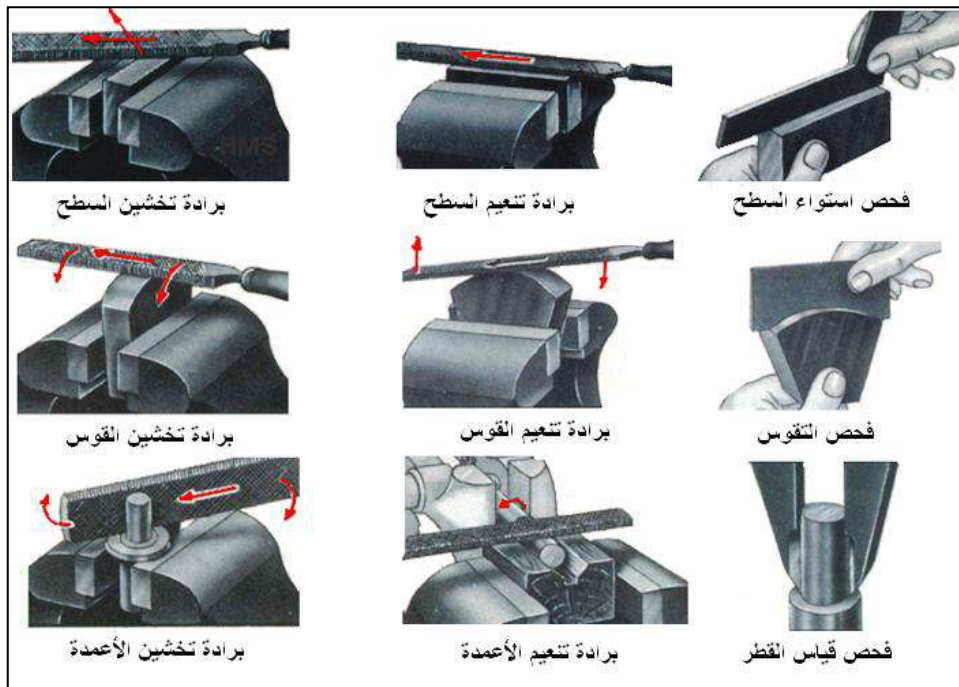
الشكل 4-20 : حركة المبرد عند برادة التخشين والتنعيم.
