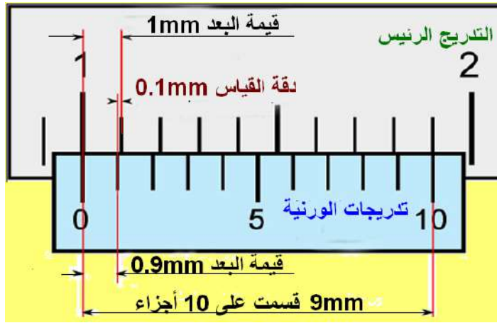
الشكل 1-12 : القدمة ذات الدقة (0.1mm).
