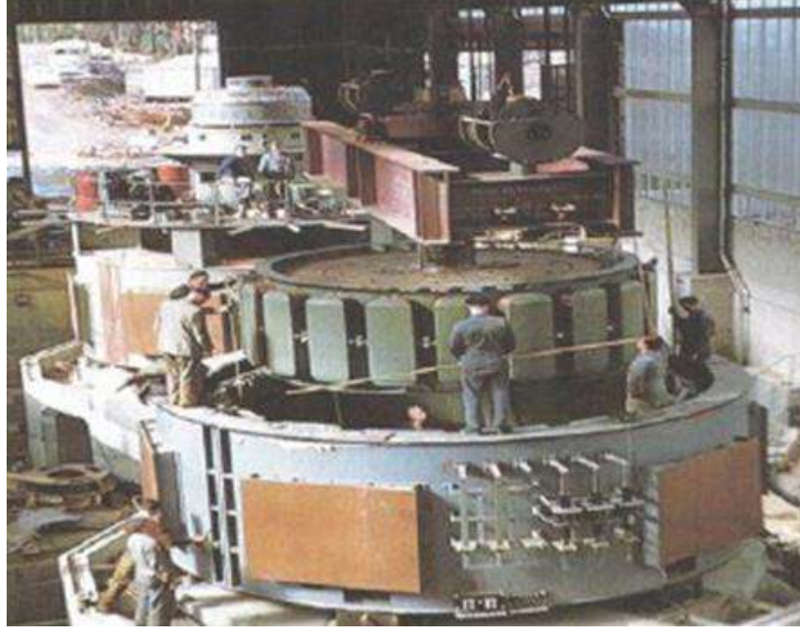
الشكل (3-3) مولدة ذات جزء دوار ذي أقطاب بارزة خلال التجميع ويبلغ قطرها 925 سم وطولها 235 سم وعدد المجاري 378 مجرى
