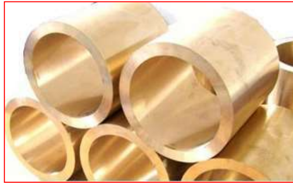
شكل رقم 3-4 مسبوكات البراص المنتجة بطريقة السباكة بالطرد المركزي
