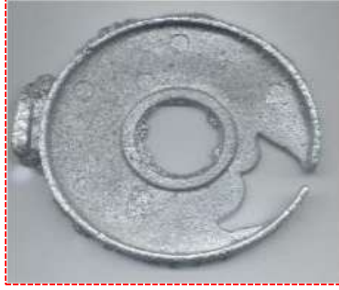
شكل رقم 16-6 عيب نقص المعدن
