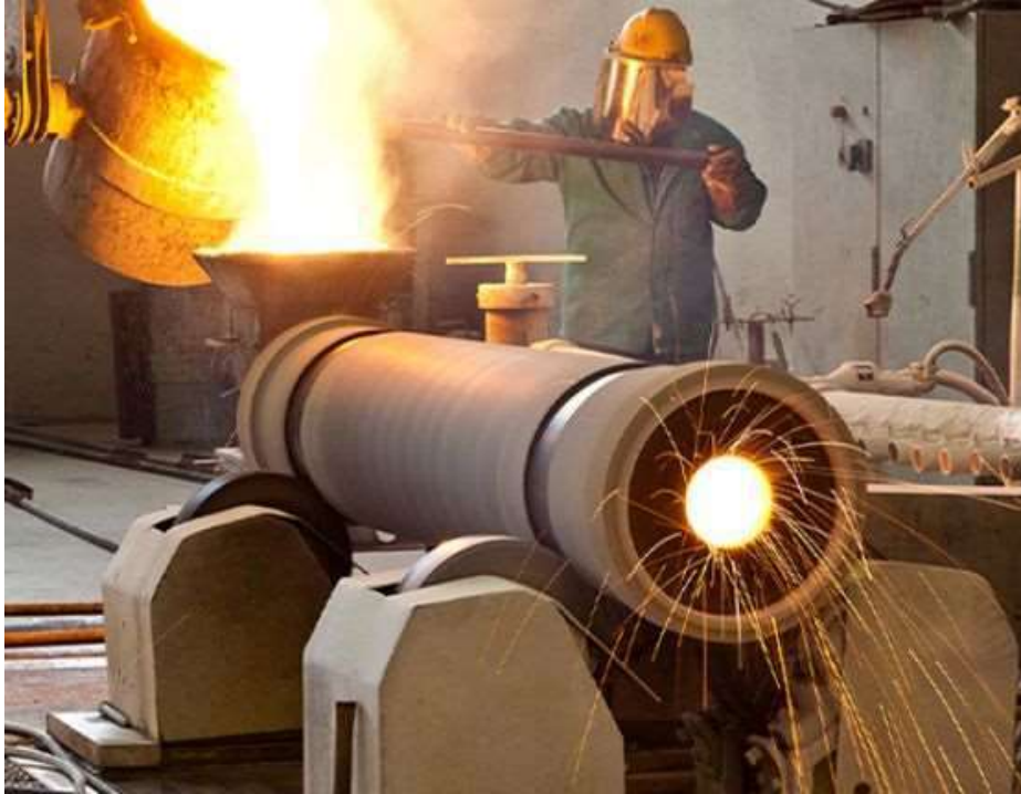
شكل رقم (5-6) سباكة الطرد المركزي للأنابيب
