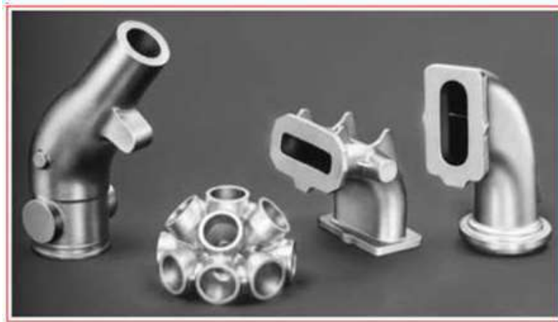
شكل رقم 8-3 أجزاء من سبائك التيتانيوم مصنعة بطريقة الشمع المفقود في المحرك التوربيني الغازي
