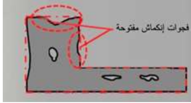
شكل رقم 10-6 فجوات انكماش مفتوحة
