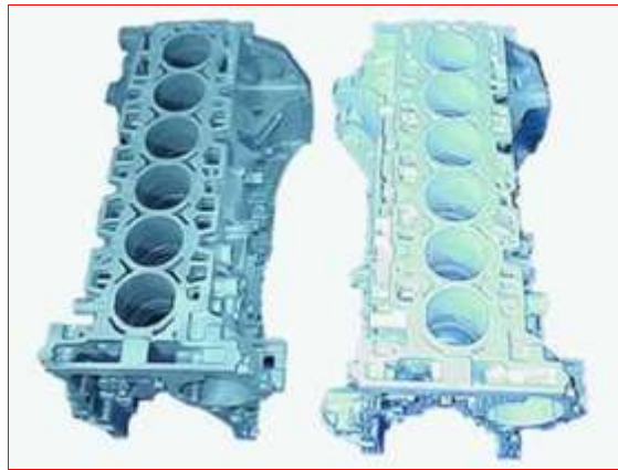
الشكل 1-5 نموذج لكتلة أسطوانة محرك سيارة من الرغوة (يمين)، المسبوكة المعدنية النهائية (يسار)
