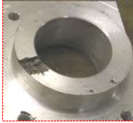
شكل رقم 6-18 الفجوات الرملية في المسبوكة
