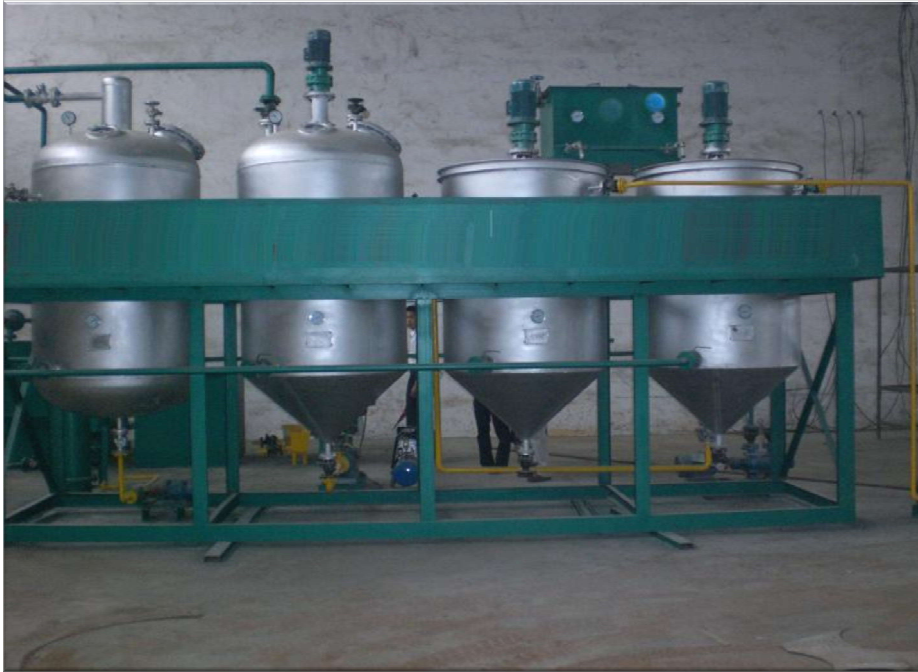
شكل (20) وحدات استخلاص الزيوت بالمذيبات العضوية
