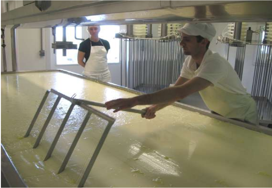
شكل (29) عملية تقطيع خثرة الجبن بالسكاكين الطولية
