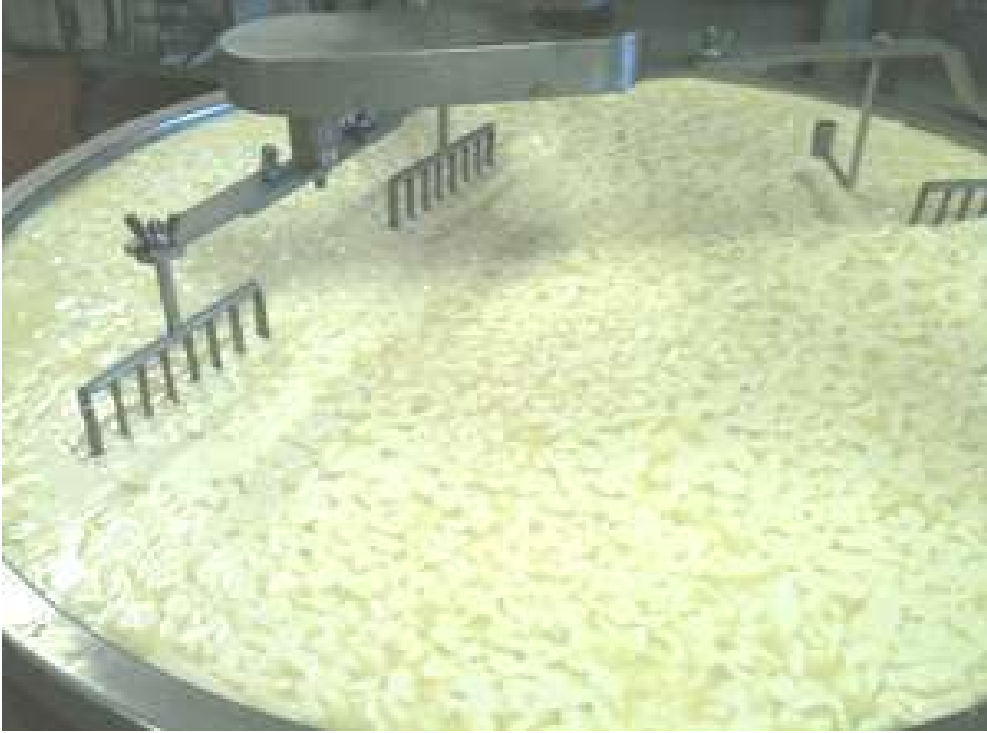
شكل (31) عملية تقليب الخثرة بعد التقطيع
